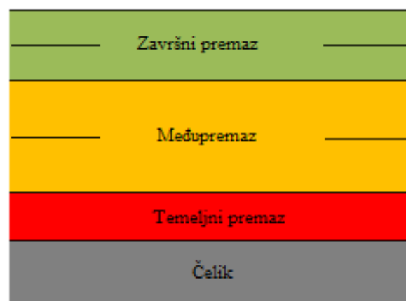
Slika 14. Više slojni sustav premaza [18]
