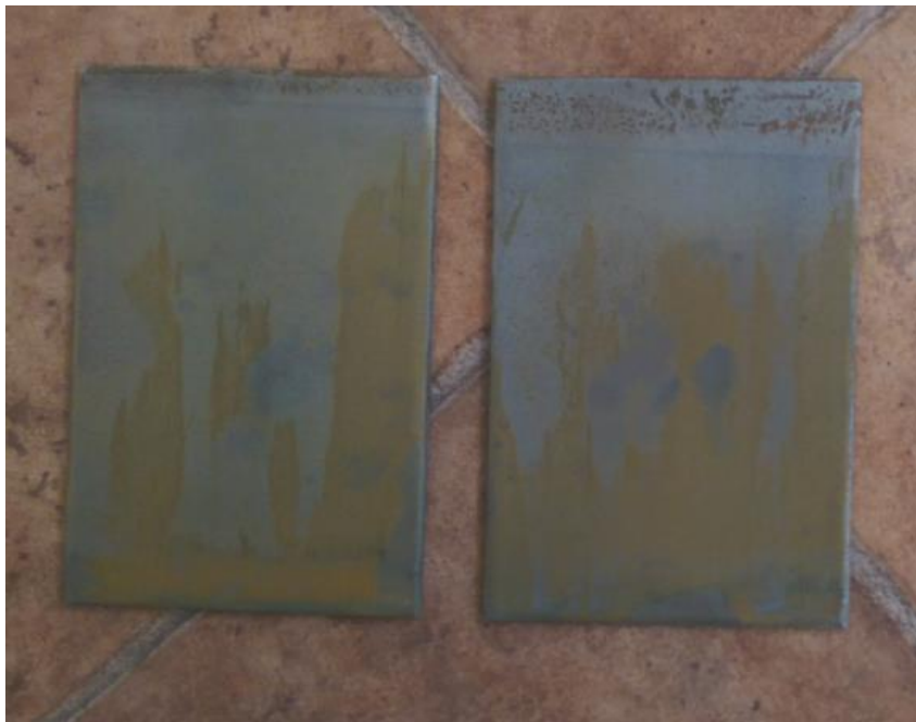
Slika 17. 2. grupa uzoraka (uronjeni u vodenu otopinu 3,5 NaCl i 30 minuta sušeni na okolišnoj temperaturi)
