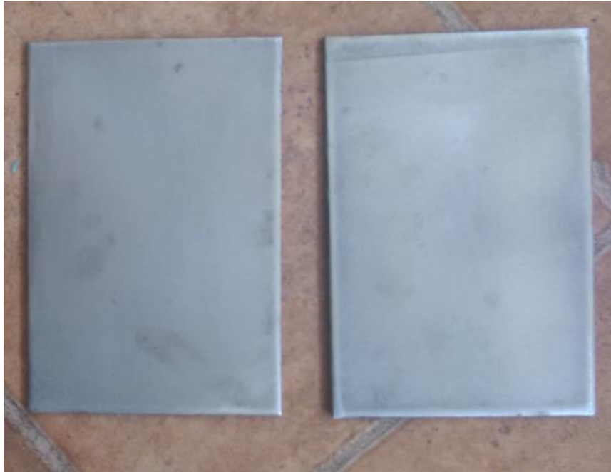
Slika 16. 1. grupa uzoraka (očišćeni i odmašćeni)
