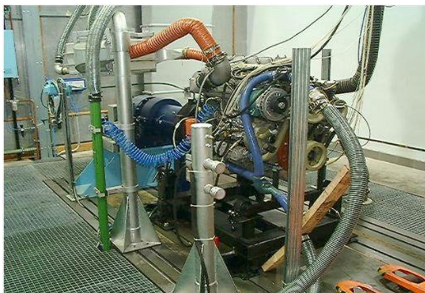
Slika 1.1. Ispitivanje motora na kočnici [1]
