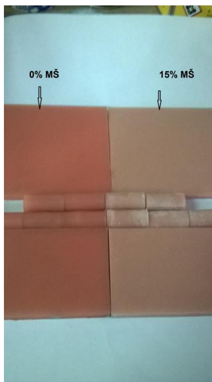
Slika 26. Slika prikazuje uzorke koji sadržavaju 15% školjaka te uzorak bez čestica
