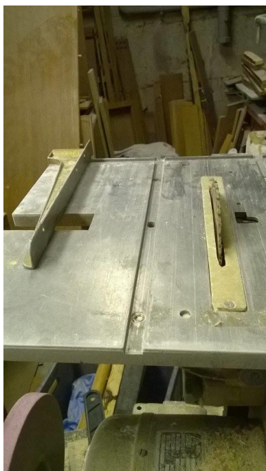
Slika 28. Kružna motorna pila za rezanje uzoraka
