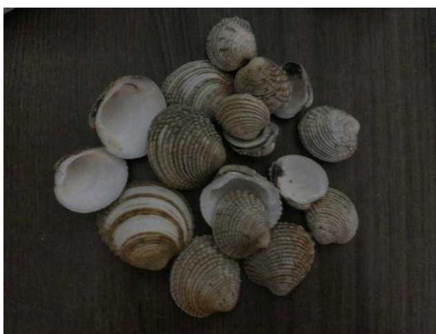
Slika 16. Slika prikazuje morske školjke korištene kao ojačanje
