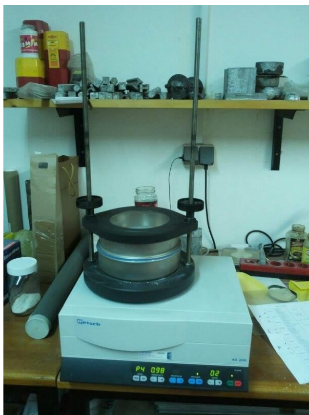
Slika 18. Retsch AS 200-uređaj sa sitima
