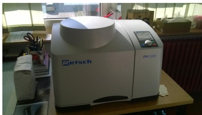
Slika 19. Slika prikazuje uređaj za miješanje praha PMMA i morskih školjaka PM 100, Retsch
