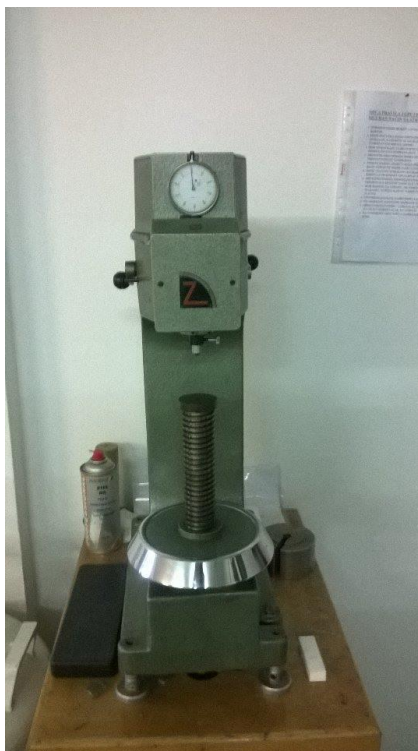
Slika 39. Tvrdomjer ZWICK & Co Härteprüfgerät 3106
