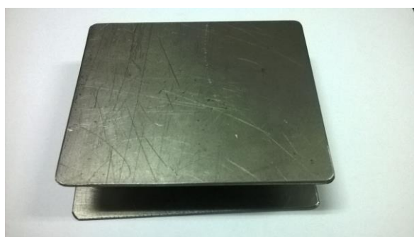
Slika 14. Kalup za izradu uzoraka za ispitivanje kliznog trošenja
