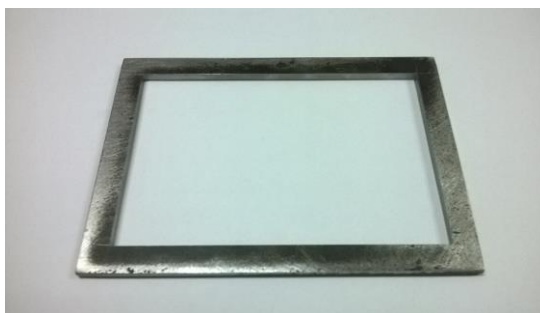
Slika 12. Kalup za izradu uzoraka za savojnu čvrstoću te žilavost
