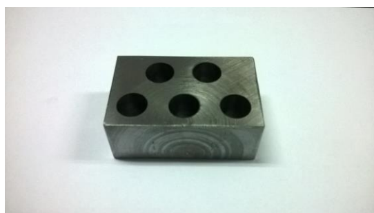
Slika 13. Kalup za izradu uzoraka za ispitivanje tlačne čvrstoće
