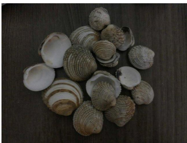
Slika 16. Slika prikazuje morske školjke korištene kao ojačanje
