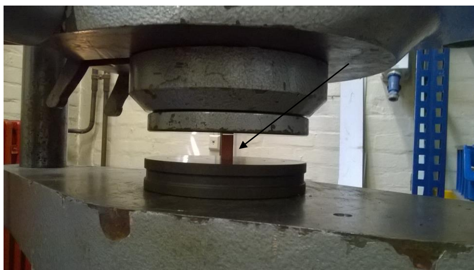
Slika 45. Uzorak između dvije plohe prije sabijanja
