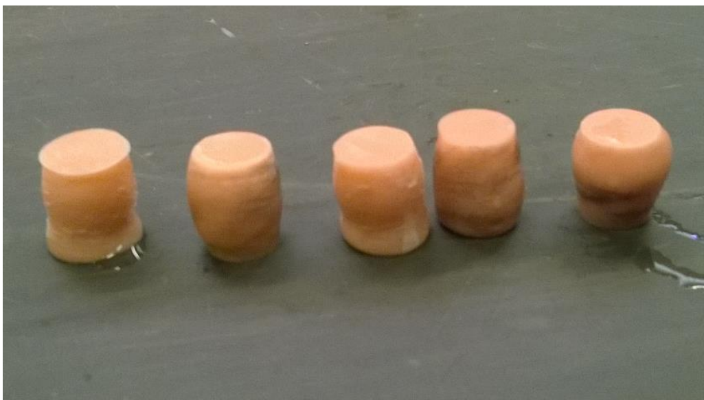
Slika 44. Deformirane (sabijene) epruvete nakon ispitivanja
