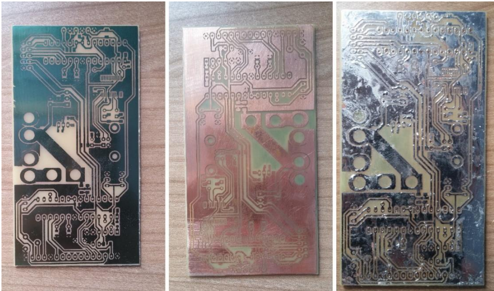
Slika 18. Skidanje laka i kositrenje tiskane pločice
