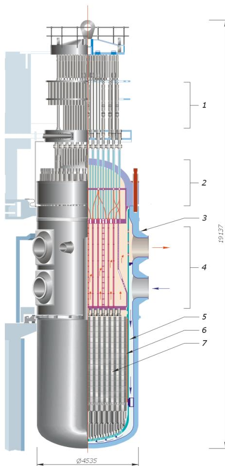
**Slika 5.** Presjek VVER - 1000 reaktora
