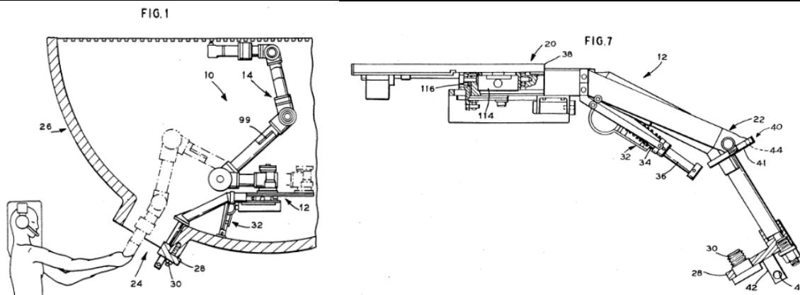
Slika 34. Proces ubacivanja robotske ruke patenta US5178820A
