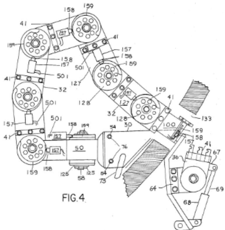
Slika 25. Konstrukcija US4561816A u položaju uvlačenja u parogenerator
