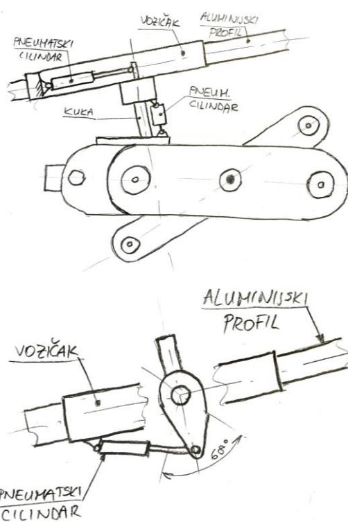
**Slika 57.** Sklop za rotaciju Forerunnera prema stjenci
