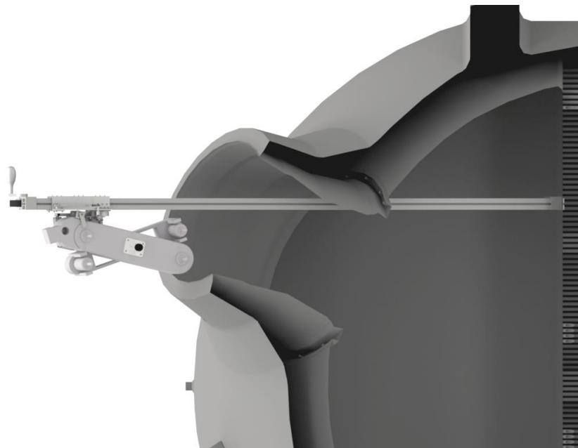
**Slika 80.** Presjek parogeneratora s Forerunnerom spremnim za instalaciju
