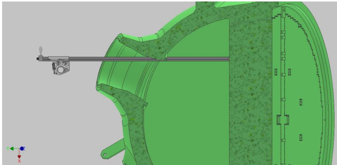
**Slika 70.** Uredaj za instalaciju spojen na parogenerator
