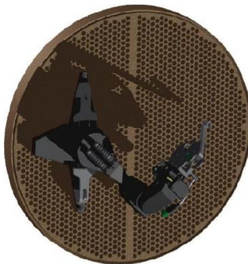
Slika 17. Načini prihvata sustava Spyder na cijevnu stjenku
