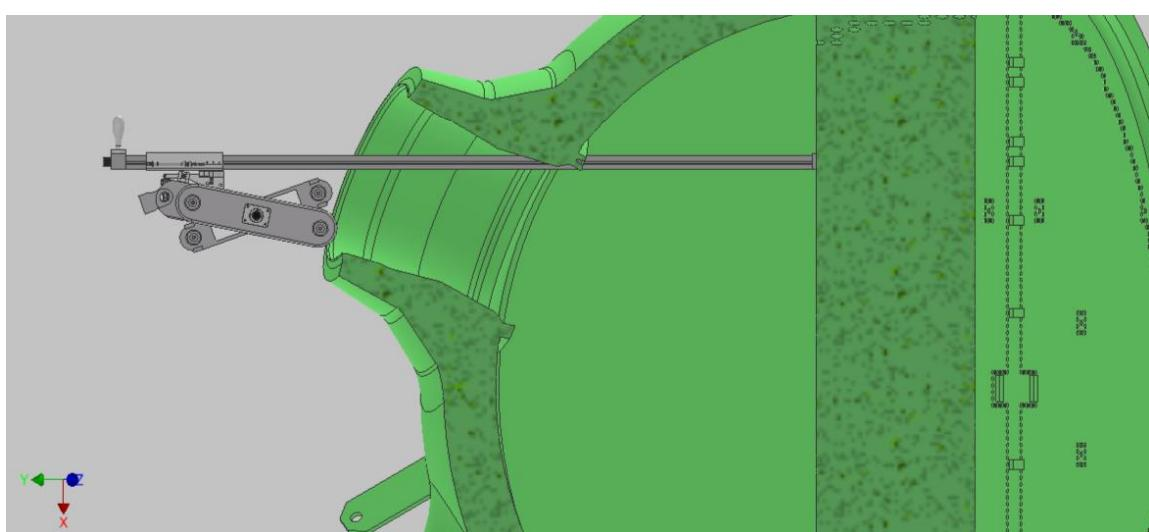
**Slika 71.** Forerunner spojen na uređaj za instalaciju
