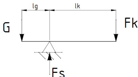
Slika 62. Shema za proračun sile u cilindru za rotaciju glavne
