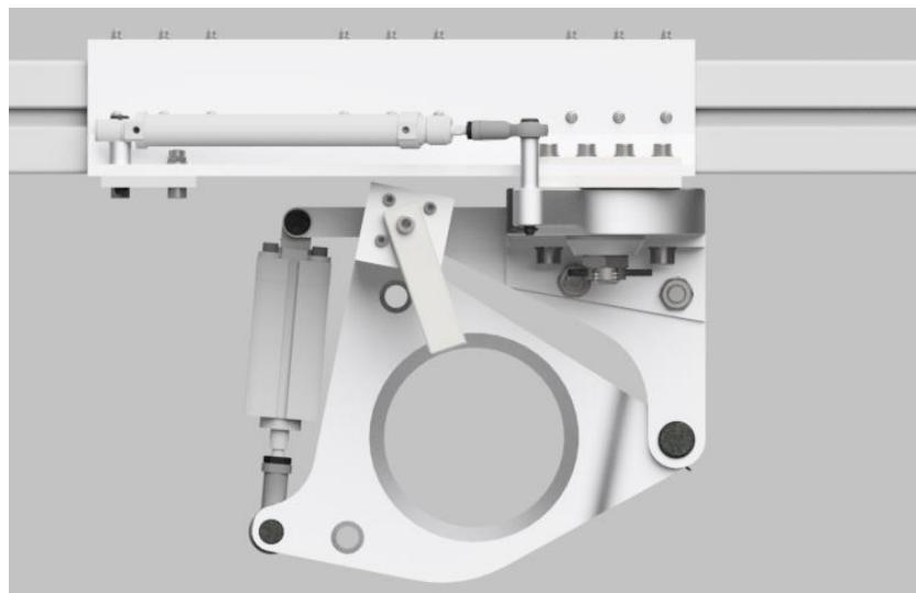
**Slika 79.** Nacrt sustava prihvata i pozicioniranja - render
