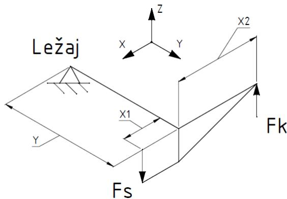
**Slika 66.** Shema za proračun sila i momenata na okretni ležaj i osovinu
