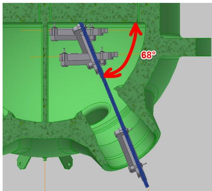
Slika 58. Presjek parogeneratora i trasa vodenja Forerunnera u tlocrtu
