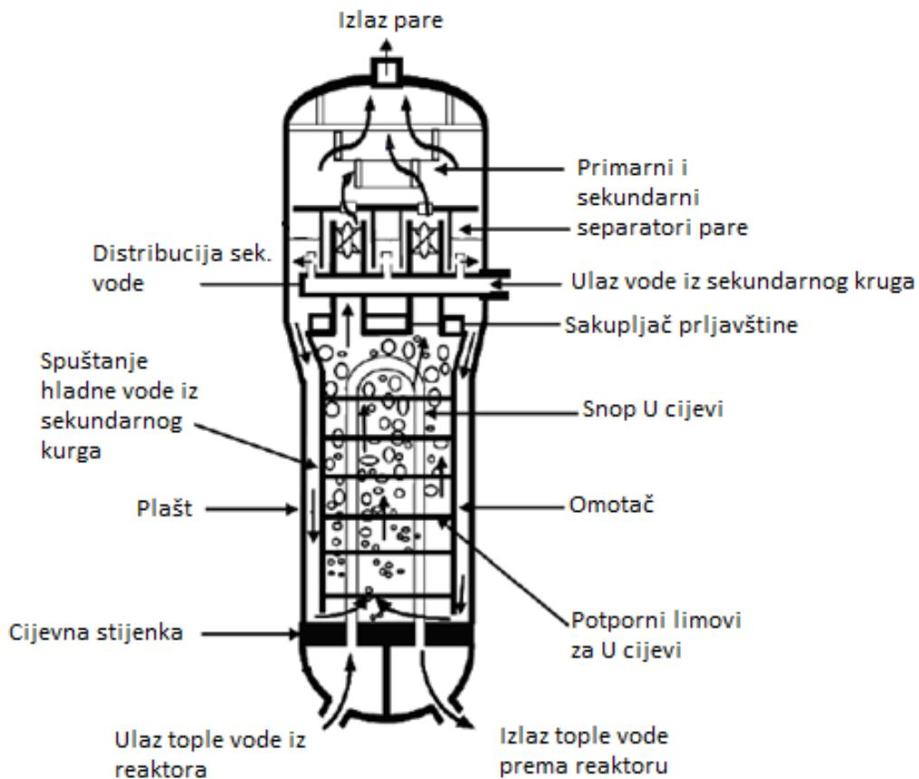
**Slika 9. Shema parogeneratora i kretanja fluida unutar parogeneratora**
