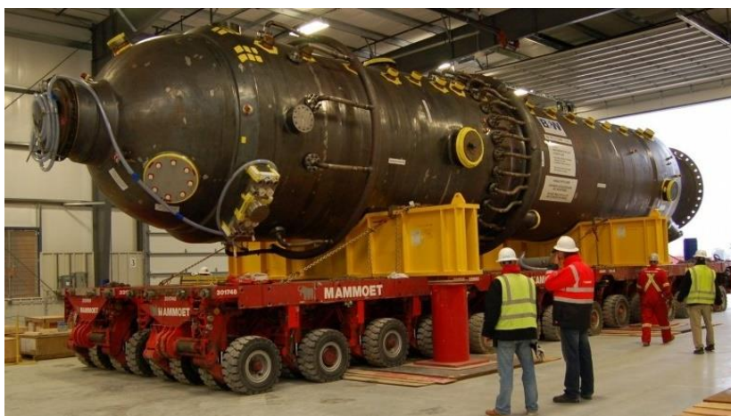
Slika 10. Fotografija parogeneratora na transportnom sredstvu
