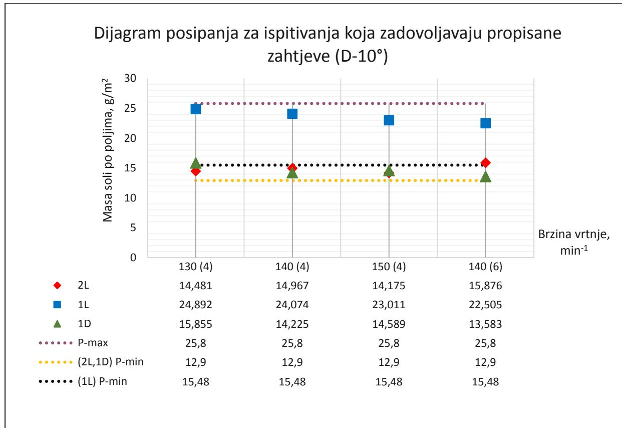
Slika 89. Dijagram posipanja za ispitivanja koja zadovoljavaju propisane zahtjeve (D- $10^\circ$ )
