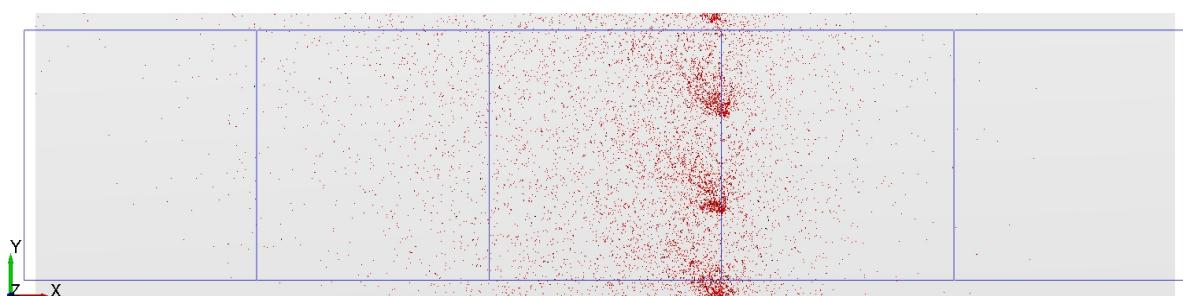
Slika 29. Rezultati 4 ravne lopatice – tangencijalno ( $0^\circ$ ) –  $110 \text{ min}^{-1}$
