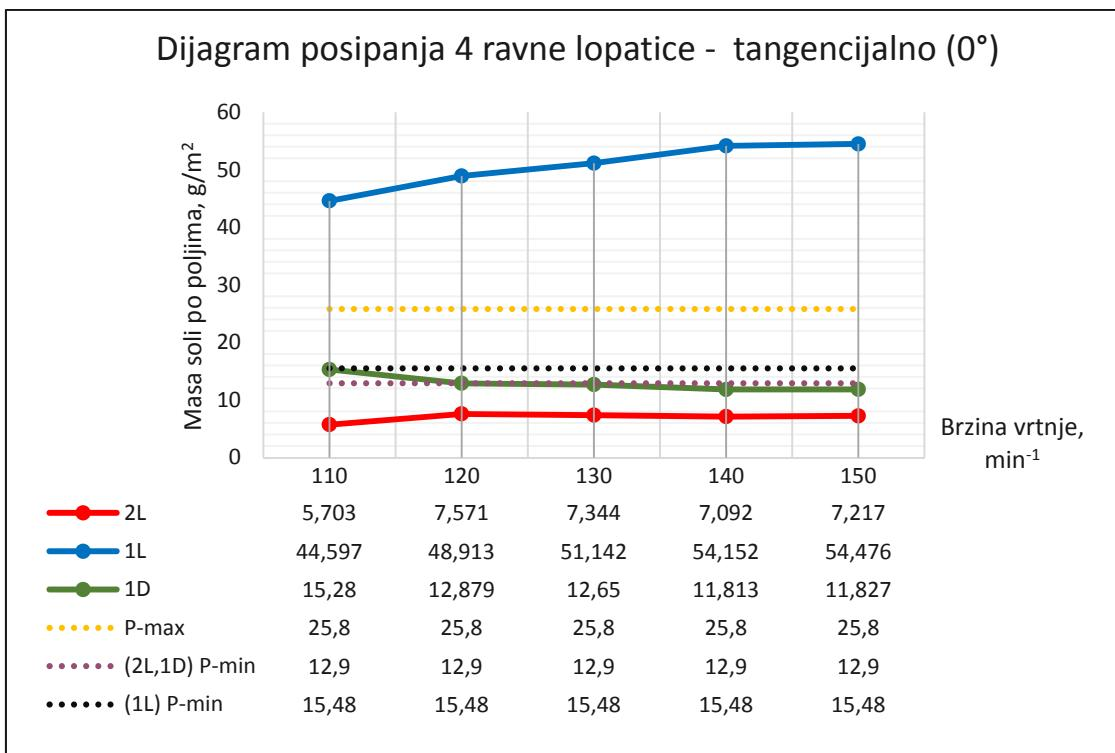
**Slika 31. Dijagram posipanja 4 ravne lopatice – tangencijalno ( $0^\circ$ )**
