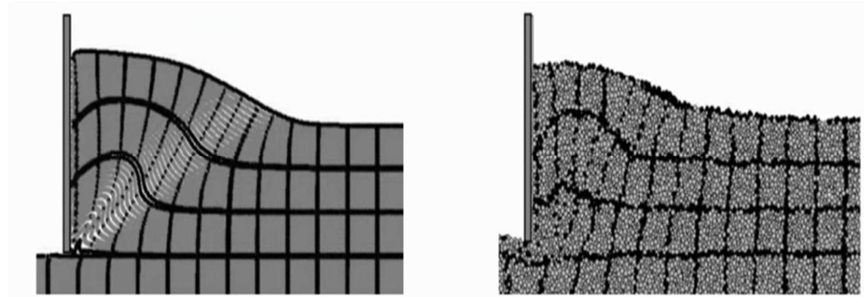
**Slika 5. Primjer kontinuiranog (Eulerovog) i diskretnog (Lagrangeovog) modela rezne oštice i materijala koji se reže**
