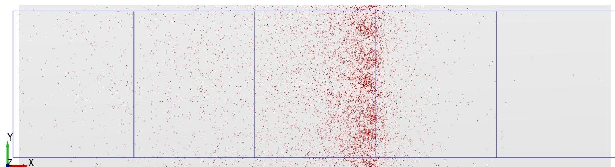
Slika 46. Rezultati 6 ravnih lopatica – tangencijalno ( $0^\circ$ ) –  $150 \text{ min}^{-1}$
