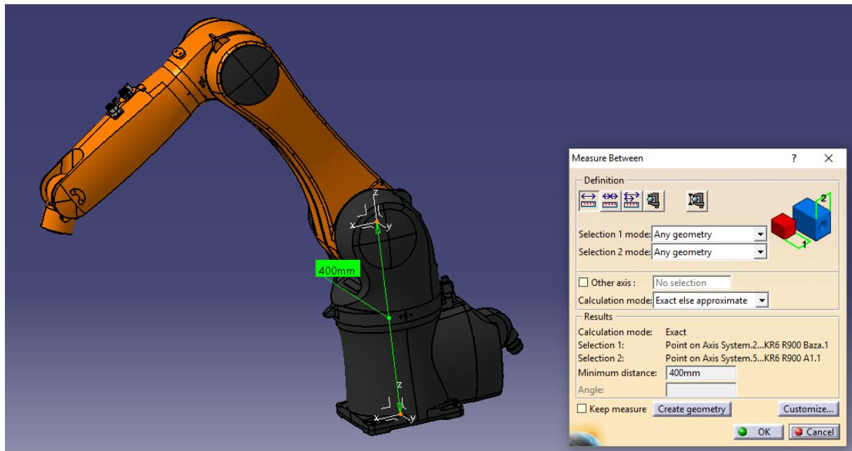
Slika 75 – Udaljenost između prve osi i baze robota
