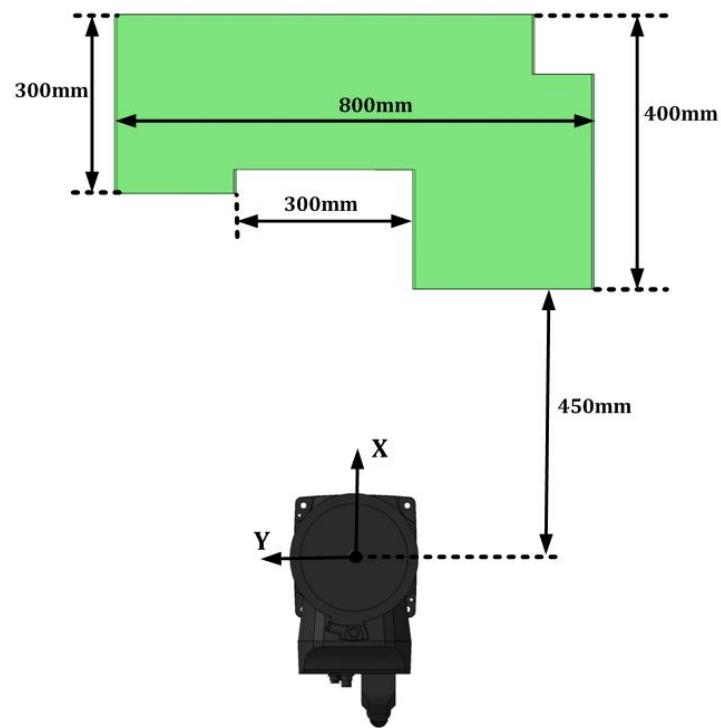
Slika 65 - Najveći radni prostor sa **100%** uspješnosti za robota R1100 (tlocrt)
