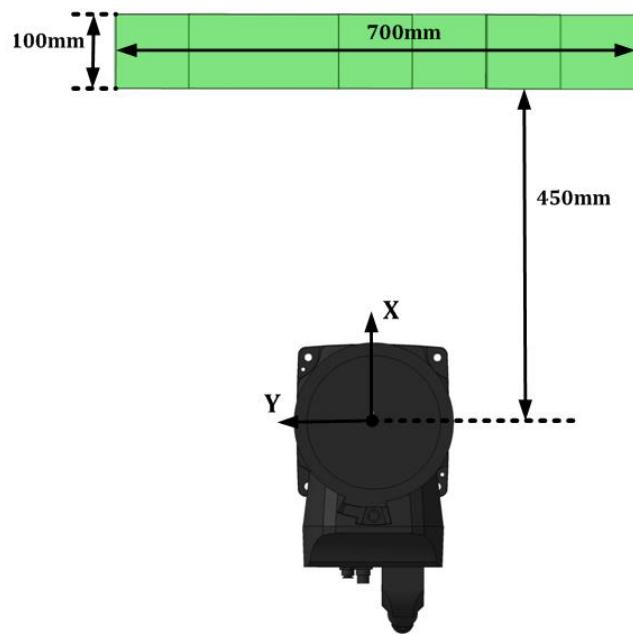
**Slika 61** - Najveći radni prostor sa 100% uspješnosti za robota R700 (tlocrt)
