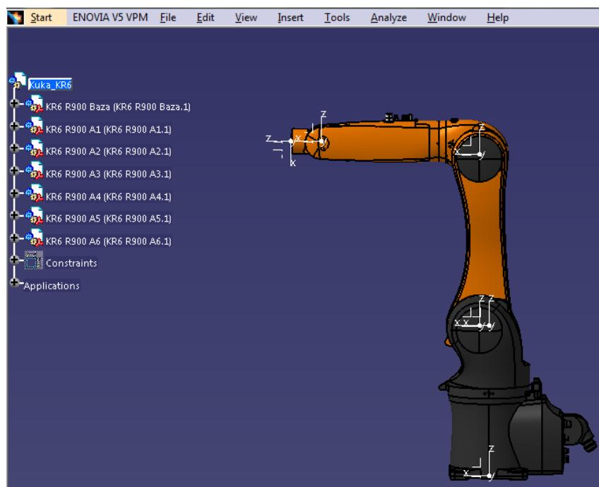
**Slika 73 - Sklop modela robota KR6 R900**
