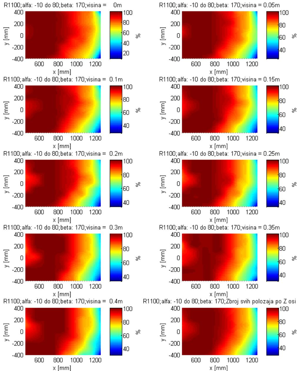
**Slika 79** - Uspješnost robota R1100 na svim visinama (simulacija a)
