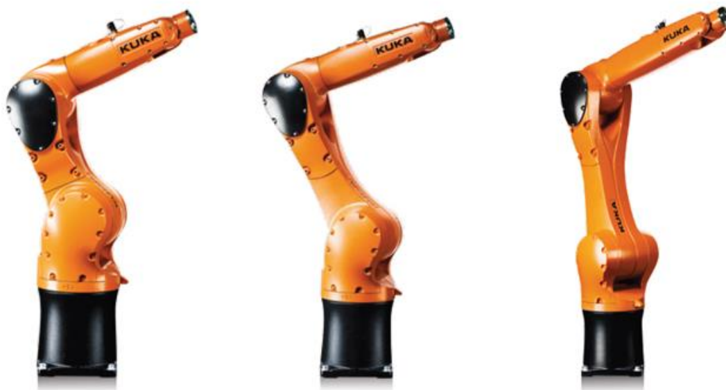
Slika 14 – Kuka Agilus KR6 R700 (lijevo), KR6 R900 (sredina), KR10 R1100 (desno)
