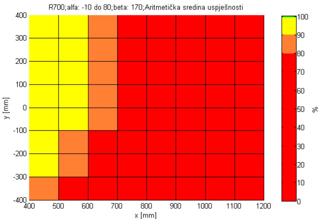
**Slika 42 –** Pojednostavljeni prikaz uspješnosti robota R700 (simulacija a)
