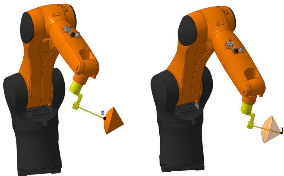
**Slika 26 – Robot s vrhom alata u ishodištu i na plaštu kuglinog isječka (E –Entry, T –Target)**
