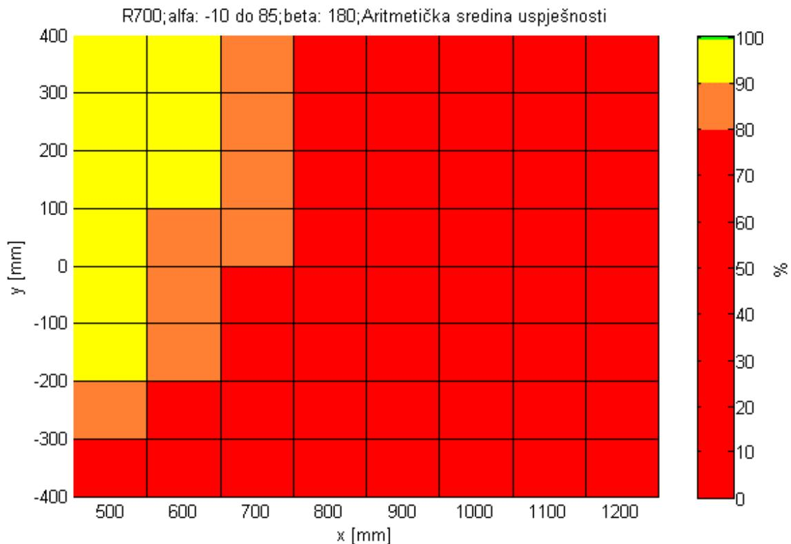
**Slika 47** - Pojednostavljeni prikaz uspješnosti robota R700 (simulacija b)
