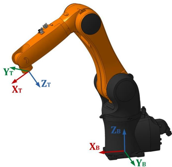
Slika 36 – Primjer konfiguracije osi robota (prema Tablica 6: Broj 1)
