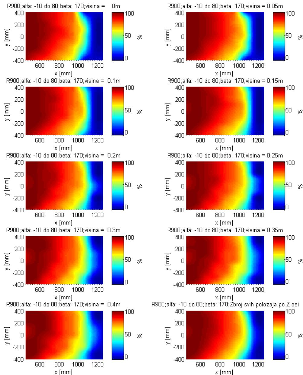
**Slika 78** - Uspješnost robota R900 na svim visinama (simulacija a)
