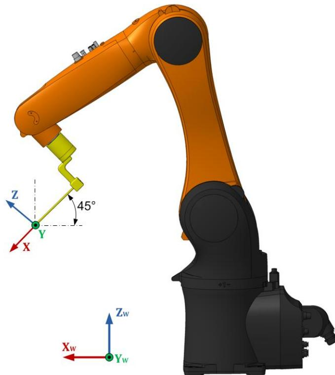
**Slika 24 – Pozicioniranje vrha alata u *Point* točku**
