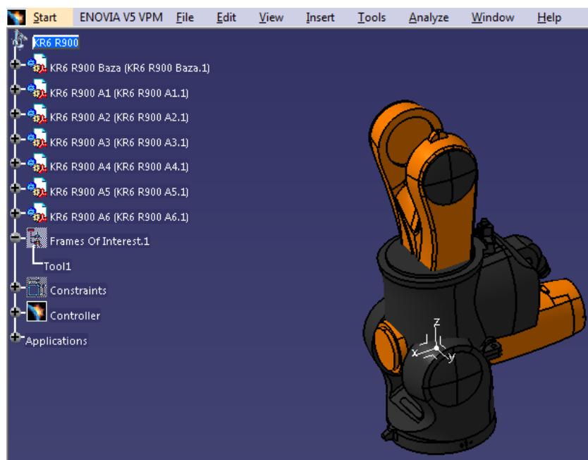
**Slika 72 – Sklop robota bez definiranih ograničenja**
