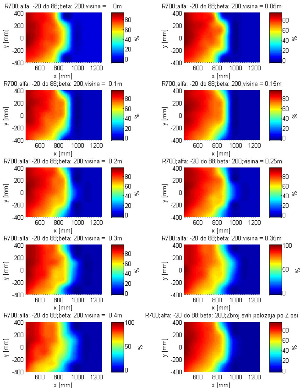
Slika 83 - Uspješnost robota R700 na svim visinama (simulacija c)
