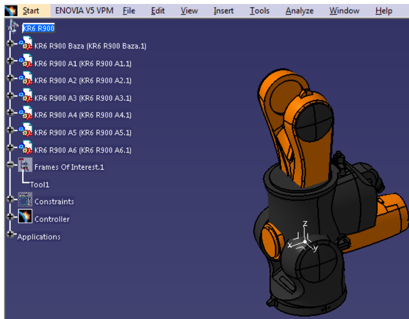
Slika 72 – Sklop robota bez definiranih ograničenja
