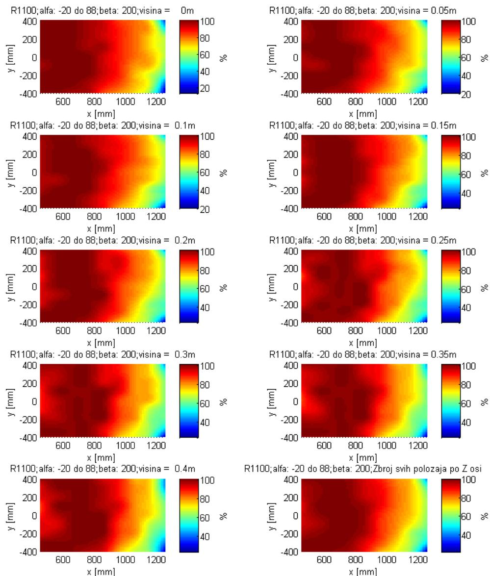
**Slika 85** - Uspješnost robota R1100 na svim visinama (simulacija c)
