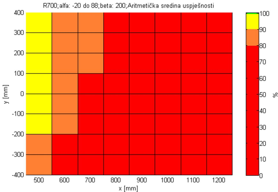
**Slika 50** - Pojednostavljeni prikaz uspješnosti robota R700 (simulacija c)
