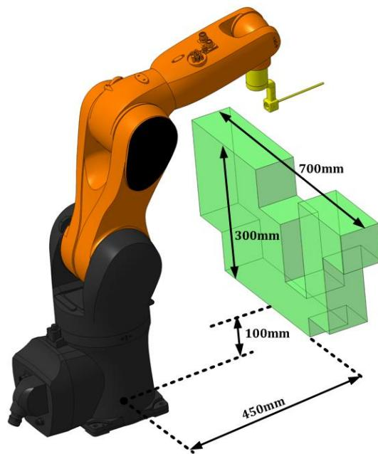
**Slika 60 –** Najveći radni prostor sa 100% uspješnosti za robota R700
