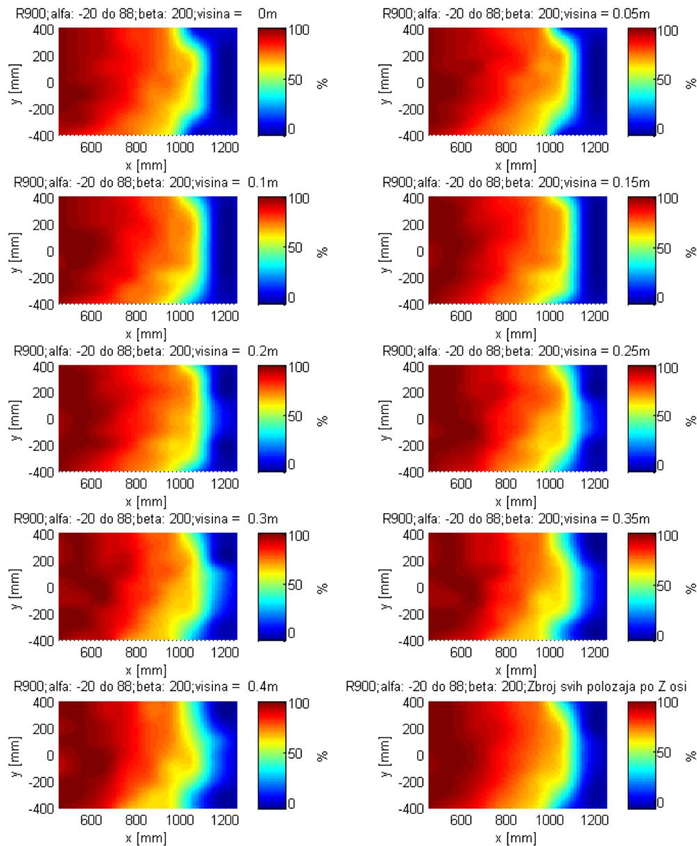
**Slika 84 - Uspješnost robota R900 na svim visinama (simulacija c)**
