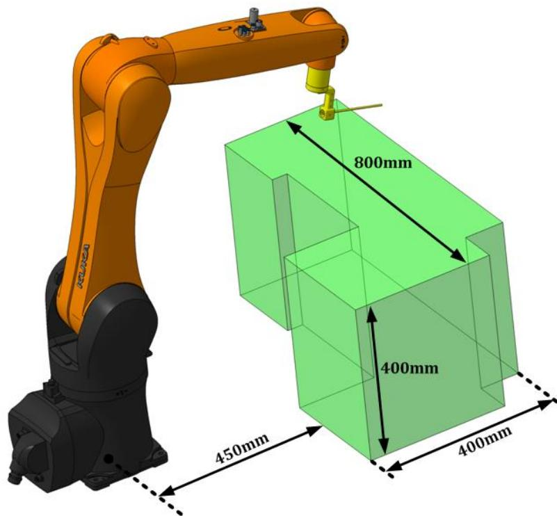
**Slika 64 -** Najveći radni prostor sa **100%** uspješnosti za robota R1100
