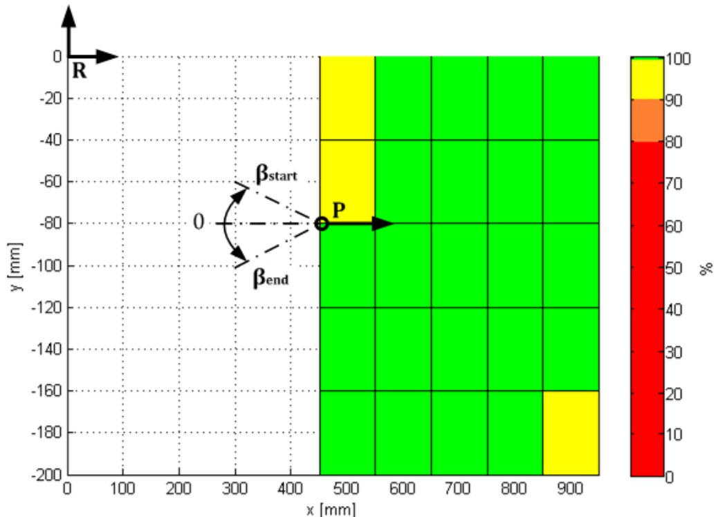
**Slika 54 - Položaj i orijentacija robota u odnosu na orijentaciju pacijenta i područje ispitivanja (R – robot, P -pacijent)**
