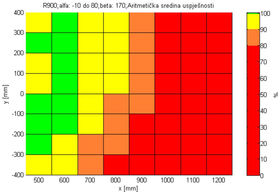
Slika 43 - Pojednostavljeni prikaz uspješnosti robota R900 (simulacija a)
