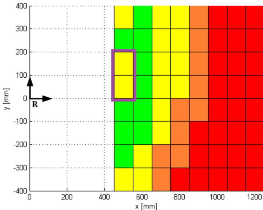
Slika 44 – Područje smanjenih radnih mogućnosti u blizini robota
