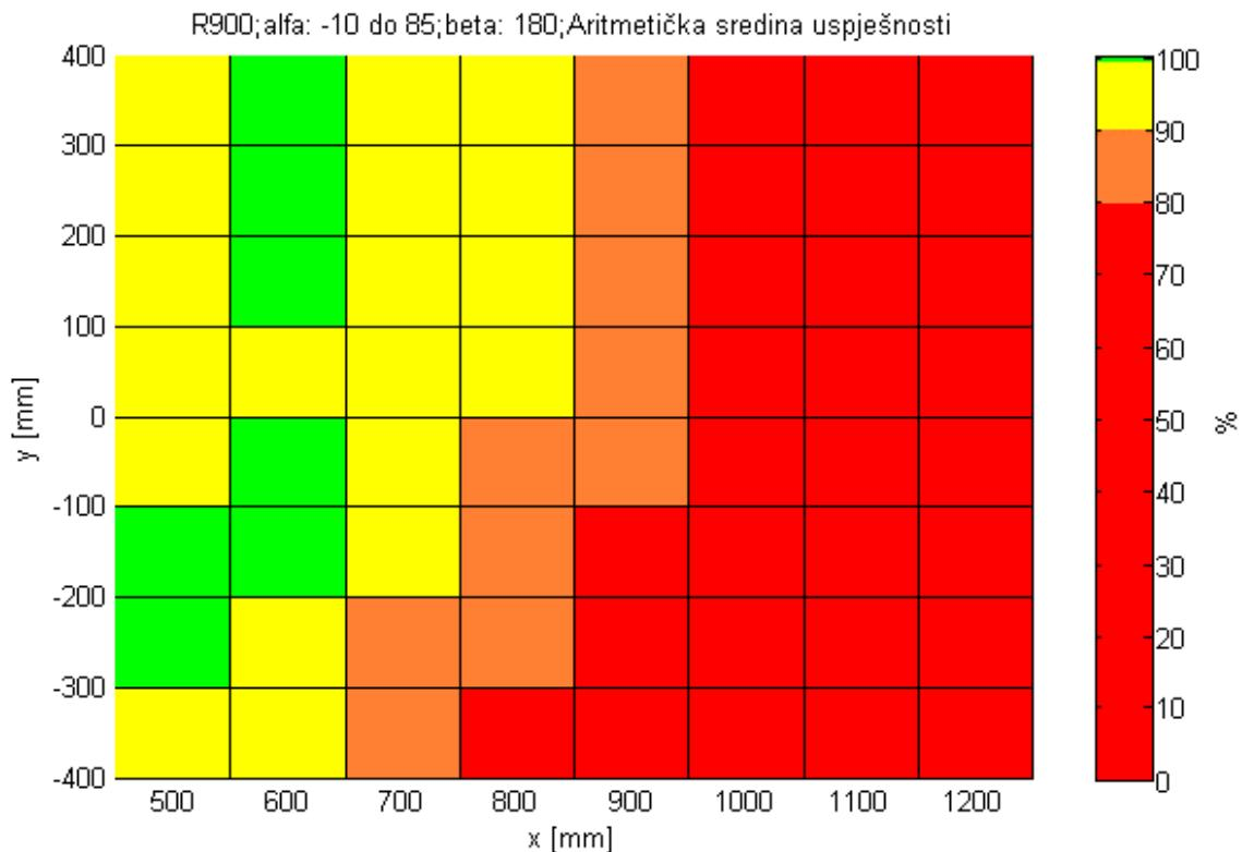
**Slika 48** - Pojednostavljeni prikaz uspješnosti robota R900 (simulacija b)
