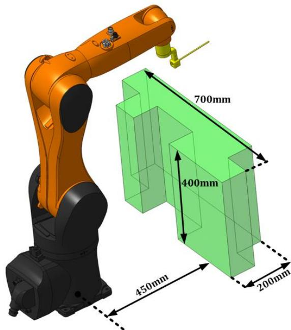
Slika 62 – Najveći radni prostor sa **100%** uspješnosti za robota R900
