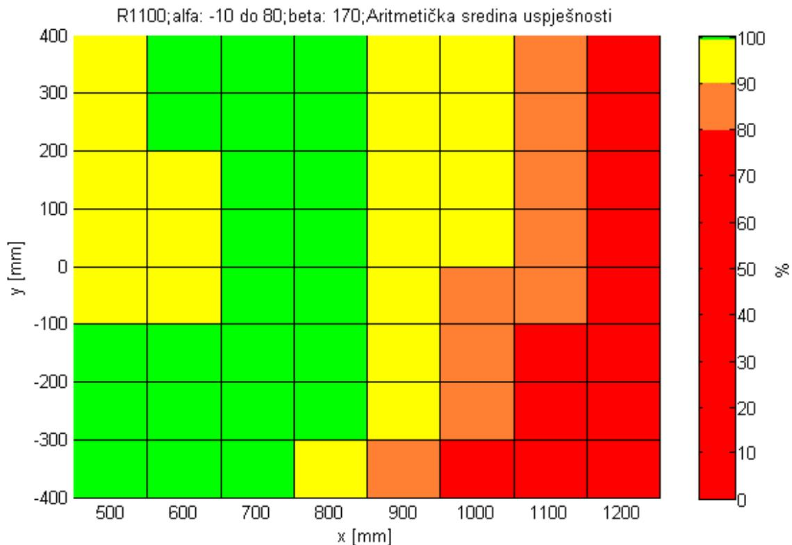
**Slika 46** - Pojednostavljeni prikaz uspješnosti robota R1100 (simulacija a)
