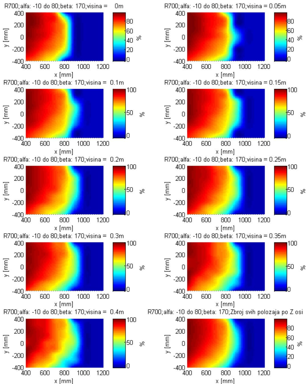
Slika 41 – Uspješnost robota R700 na svim visinama (simulacija a)
