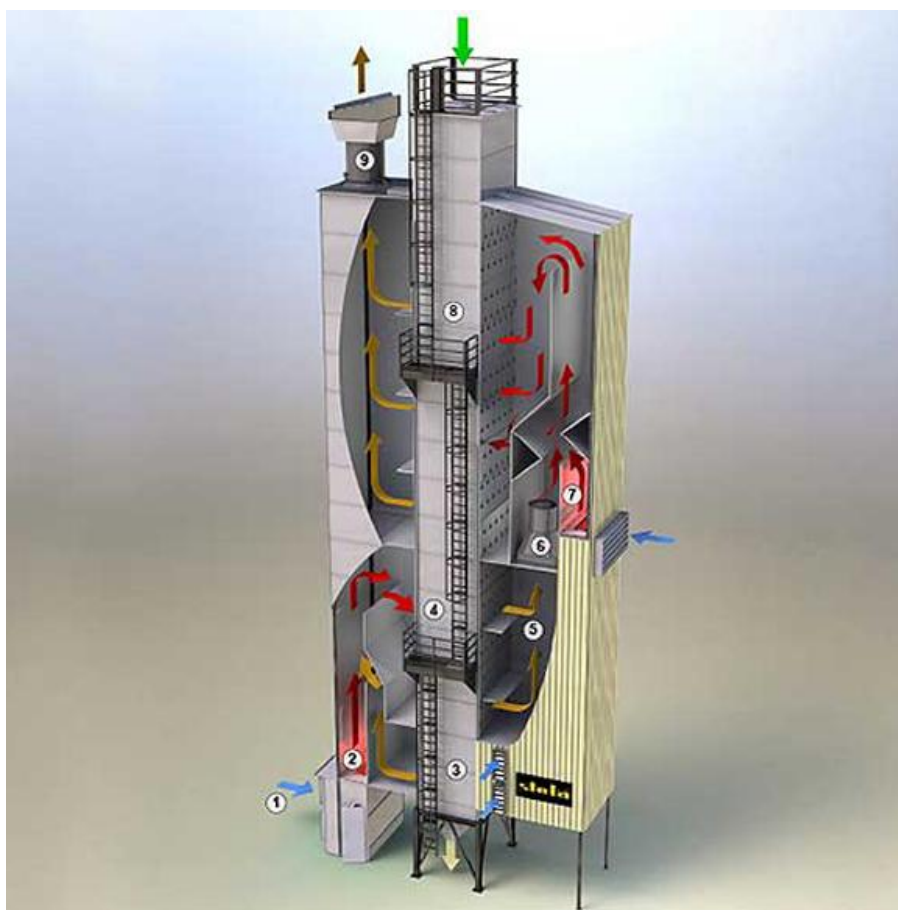
Slika 13. STELA biturbo sušara – presjek
