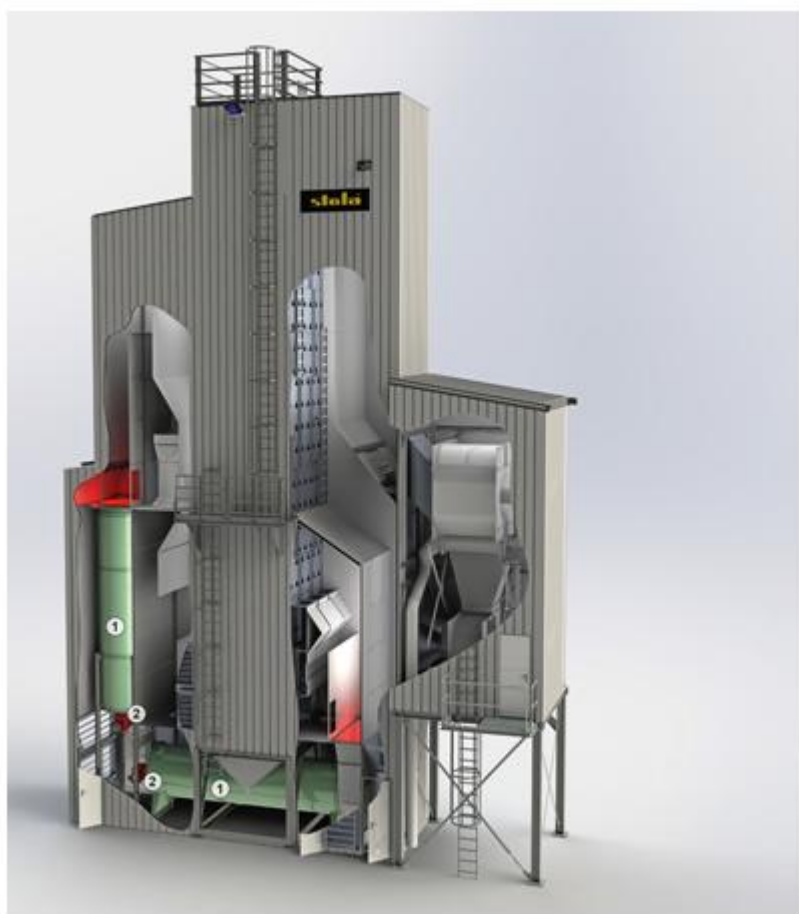
Slika 12. Stela biturbo sušara
