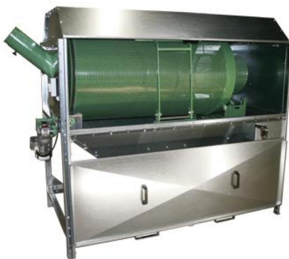
Slika 9. Grubi zračni čistač [7]
