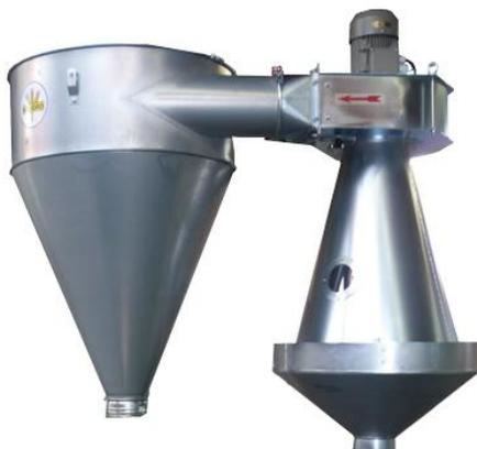
Slika 10. Fini zračni čistač [7]
