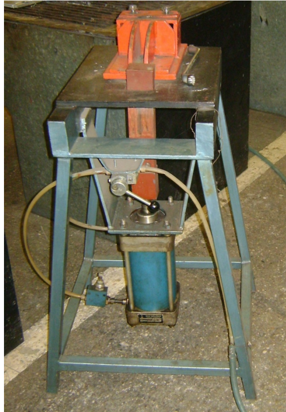
Slika 7.8. Uređaj za provođenje Vareststraint metode ispitivanja
