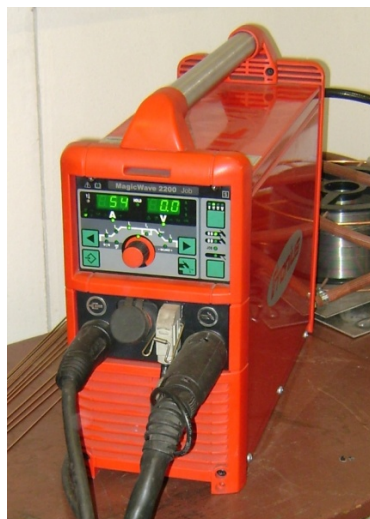
Slika 7.10. Izvor struje za zavarivanje MagicWave 2200 Job
