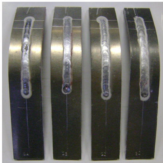
Slika 7.23. Uzorci 2 sa zacrtanim mjerama za makroizbrusak
