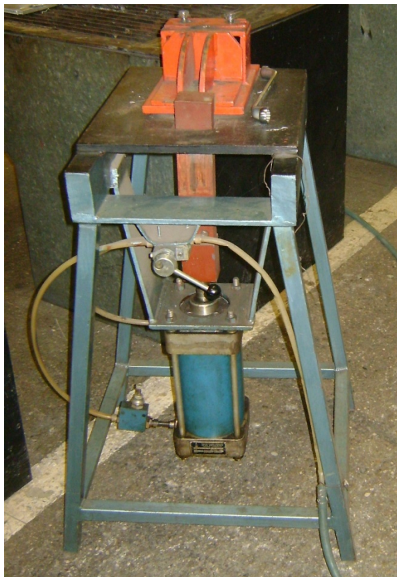
Slika 7.8. Uređaj za provođenje Varestreint metode ispitivanja
