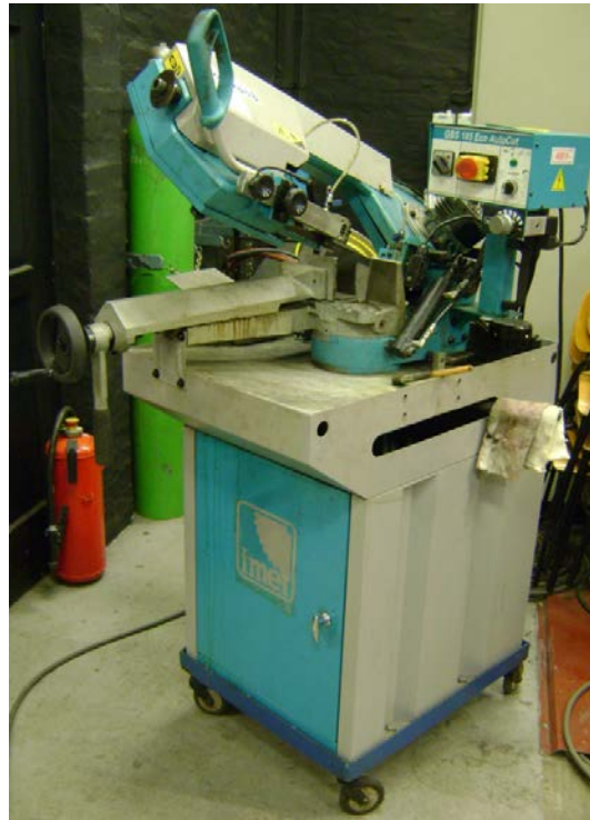
Slika 7.24. Tračna pila GBS 185 Eco AutoCut
