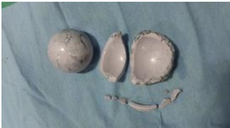
Slika 4. Slomljena čašica umjetnog kuka [6]
