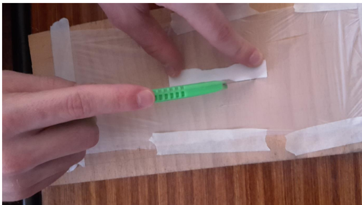
Slika 8. Izrada epruveta za ispitivanje vlačne žilavosti
