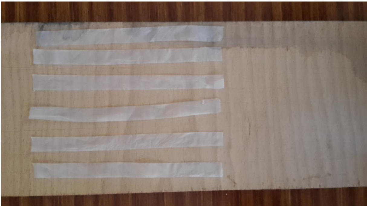
Slika 19. Izrezane epruvete za ispitivanje vlačne čvrstoće i relativnog produljenja
