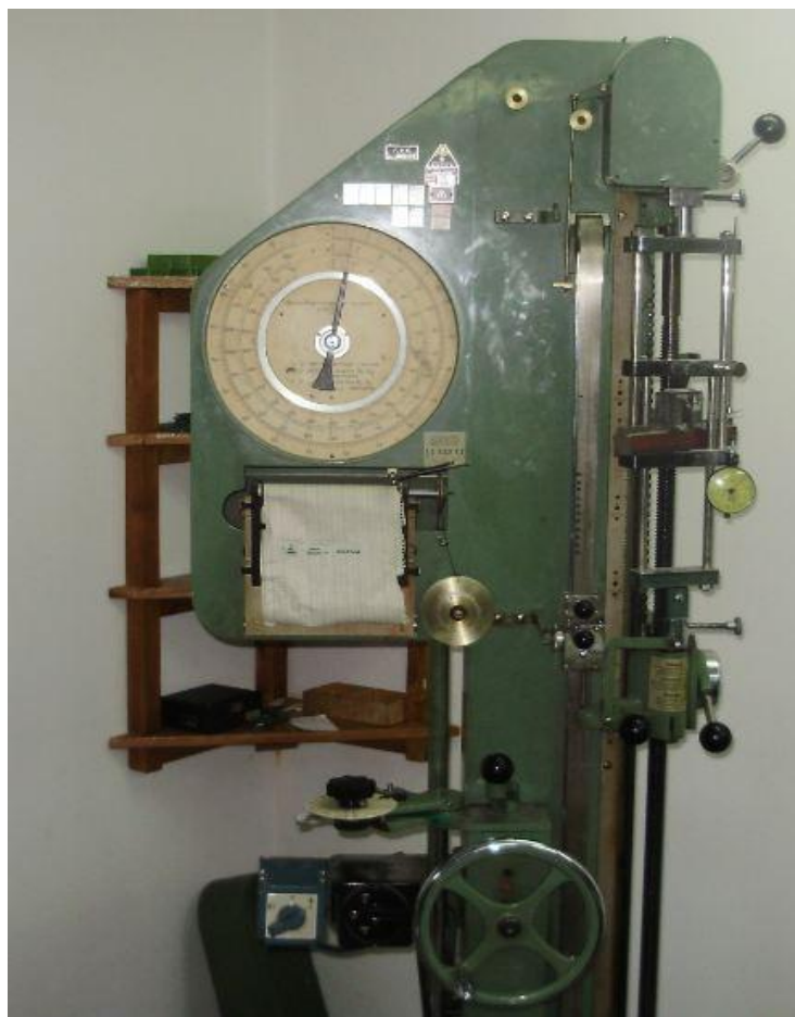
Slika 20. Ispitivanje vlačne čvrstoće i relativnog produljenja na univerzalnoj kidalici
