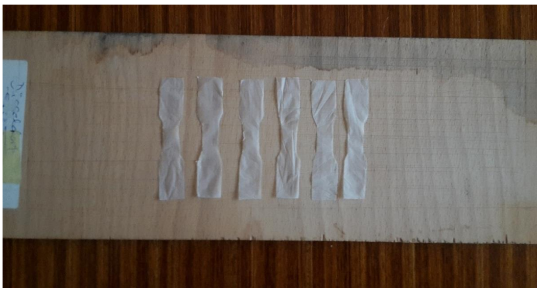
Slika 25. Izrezane epruvete za ispitivanje vlačne žilavosti
