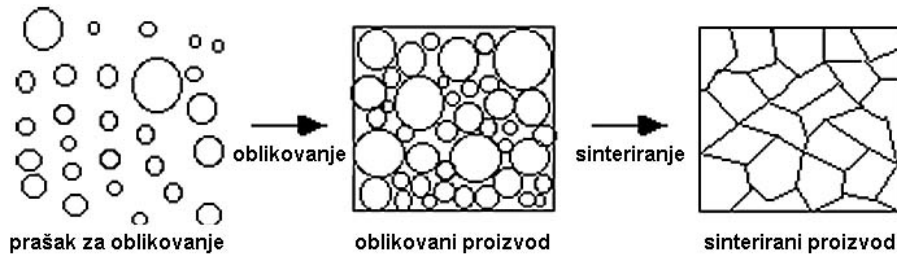
Slika 6. Zgušnjavanje mase oblikovanjem za daljnu obradu (sinteriranje).
