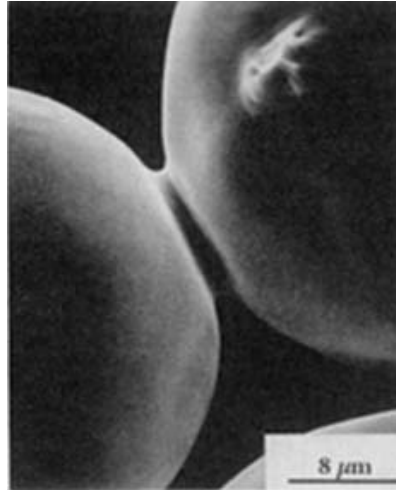
Slika 8. Stvaranje "vrata" na mjestu kontakta između čestica [4].
