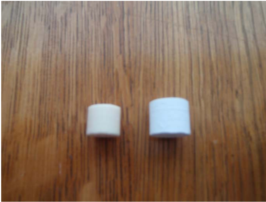
Slika 15. Prikaz promjene volumena uzorka nakon sinteriranja.
