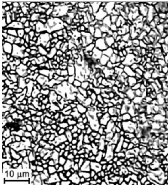
Slika 3. Mikrostruktura sitnozrnate aluminij oksidne keramike [2].
