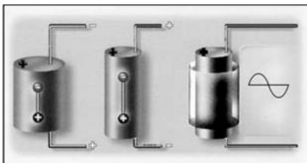
Slika 4: Inverzni piezoelektrični efekt [4]
