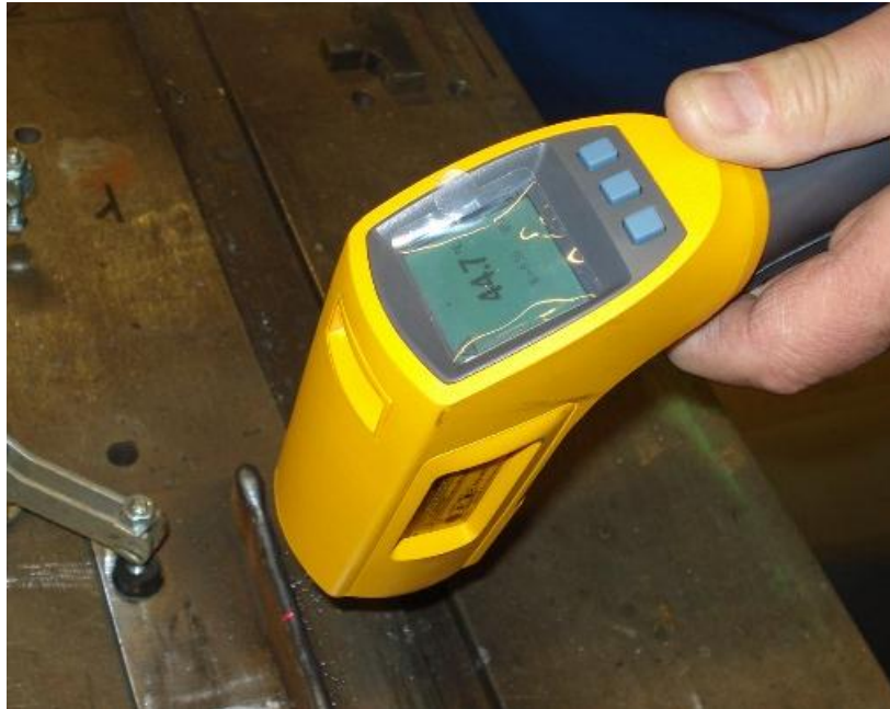
Slika 43: Mjerenje temperature međuprolaza
