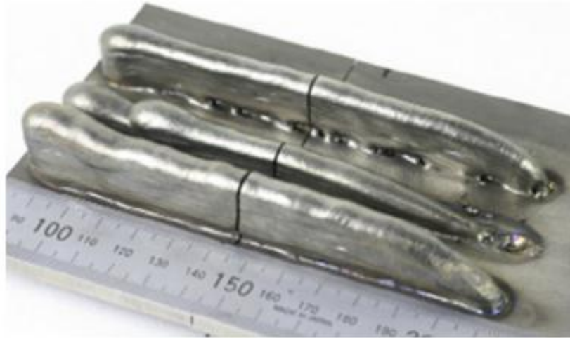
Slika 28: Razlika u geometriji zavara na početku i na kraju prolaza [3]
