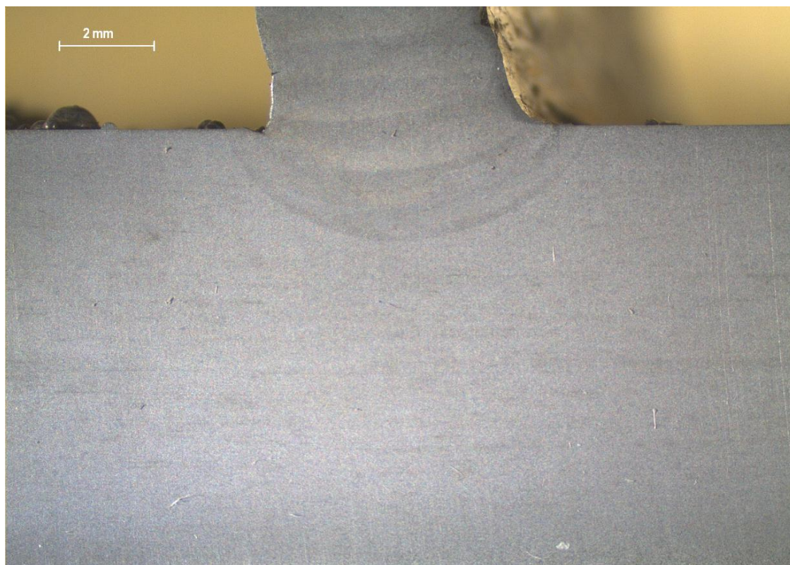
Slika 52: Završni prolazi uzorka 2 (povećanje 12,5 x)
