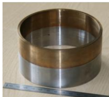
Slika 20: Prsten dobiven kombinacijom čelika i bakra [13]
