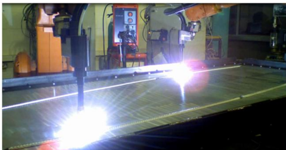
Slika 35: Proces taloženja s dva robota i okretnim stolom aluminijskog rebara [22]
