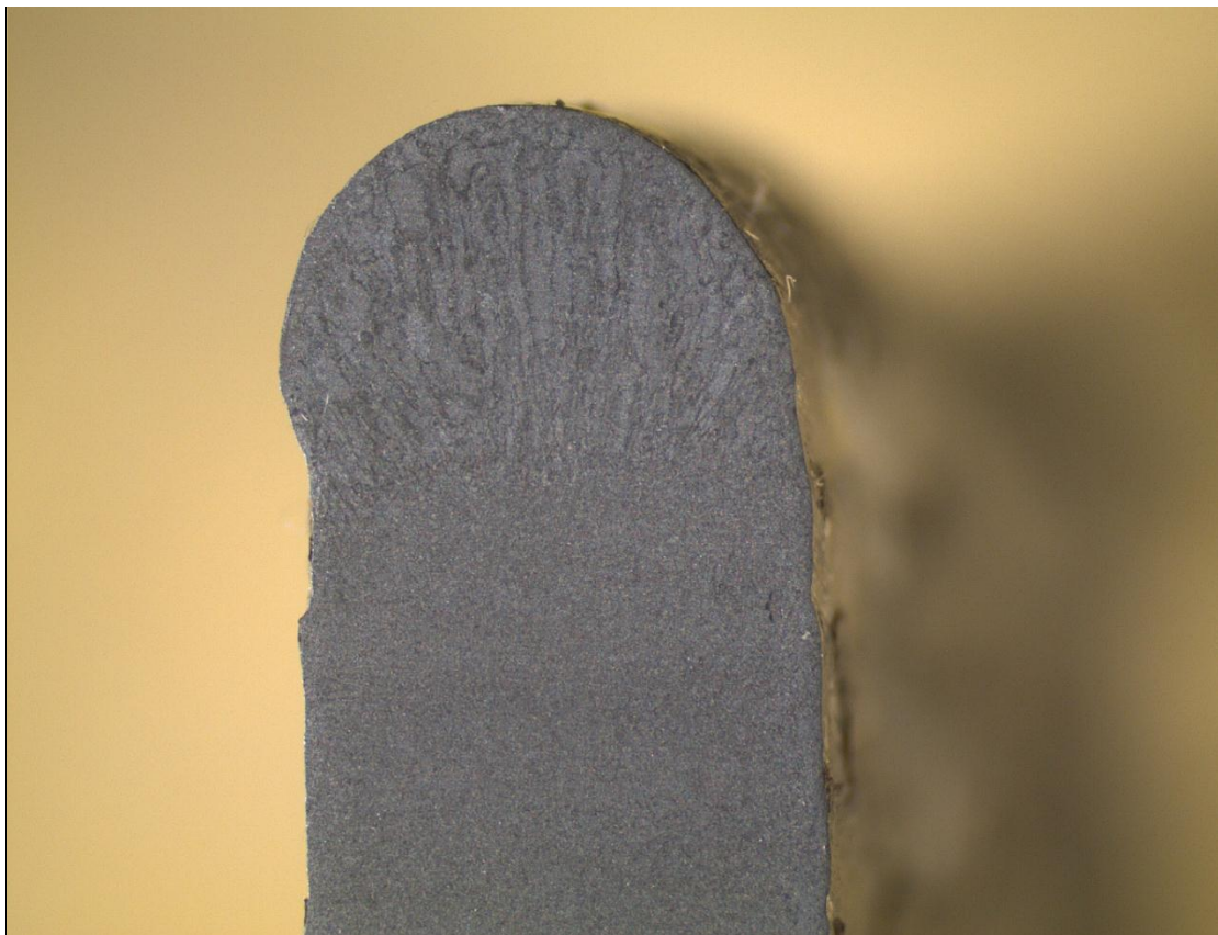
Slika 49: Završni prolazi uzorka 1 (povećanje 12,5 x)
