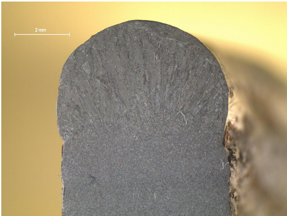
Slika 52: Završni prolazi uzorka 2 (povećanje 12,5 x)
