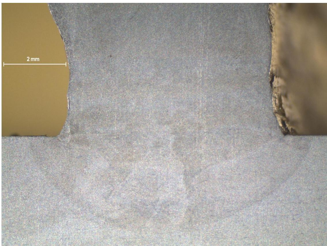
Slika 51: ZUT i početak zida uzorka 2 (povećanje 12,5 x)
