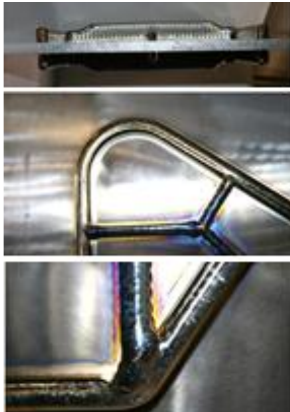
Slika 38: Okvir izrađen WAAM sustavom [21]
