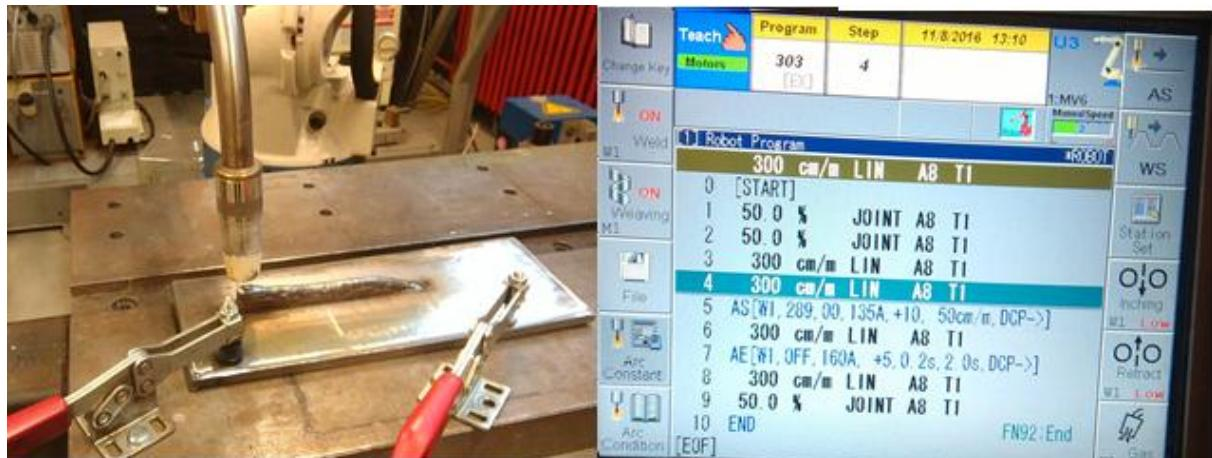
Slika 40: Položaj pištolja za zavarivanje prije zavarivanja (lijevo) i generiran program (desno)
