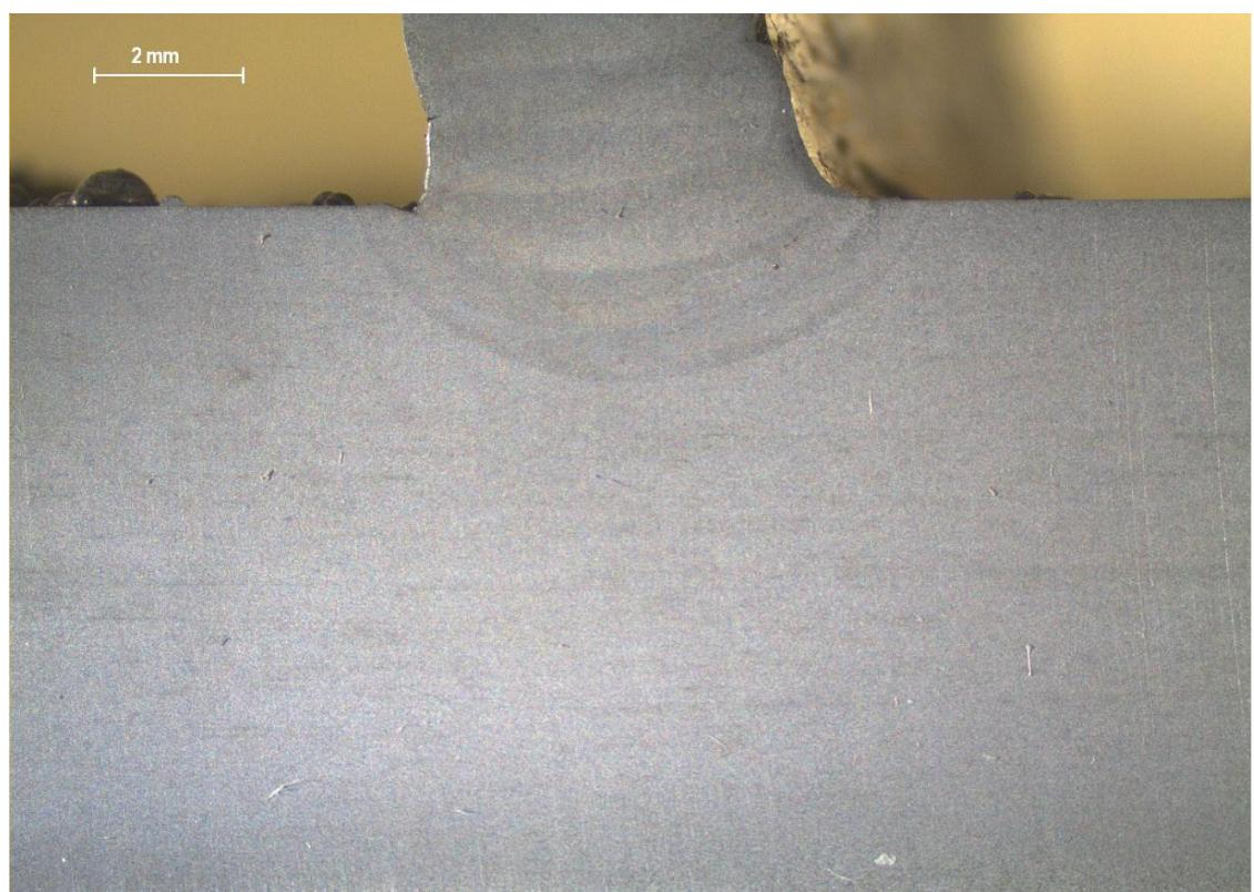
Slika 53: Osnovni materijal uzorka 3 (povećanje 7,88 x)
