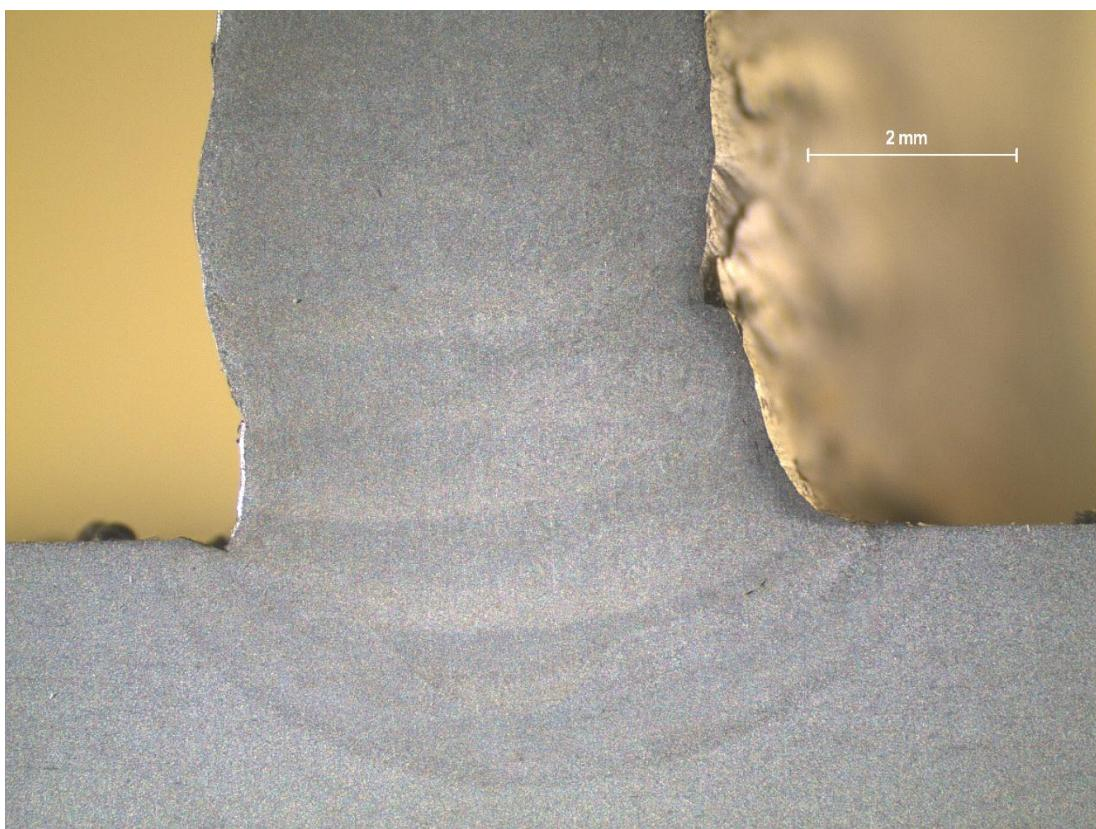
Slika 54: ZUT i početak zida uzorka 3 (povećanje 12,5 x)
