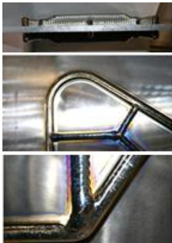
Slika 38: Okvir izrađen WAAM sustavom [21]
