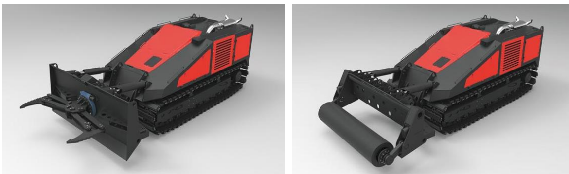
Slika 34. i Slika 35. MV-10 s dodatnim alatnim nastavcima
