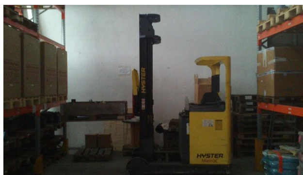
Slika 25. Bočni paletni viličar Hyster MatriX
