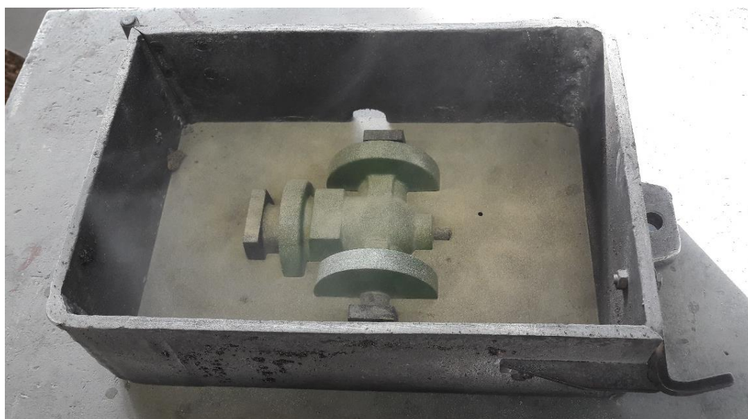
Slika 26. Donji dio modela posipan likapodijem.
