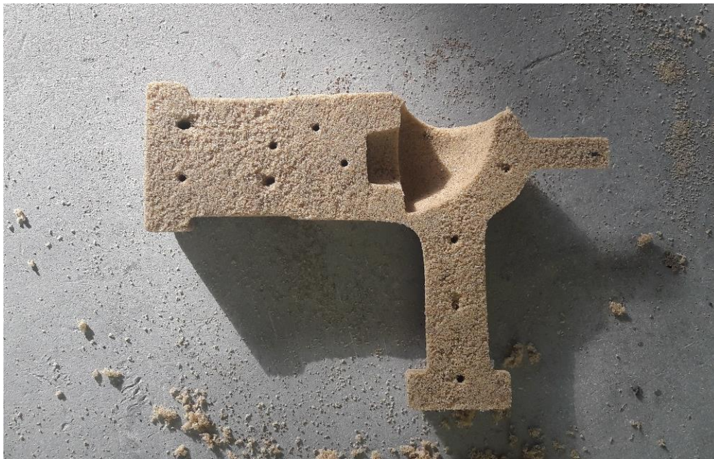
Slika 39. Očvršnuti dio jezgre spreman za umetanje u kalup.
