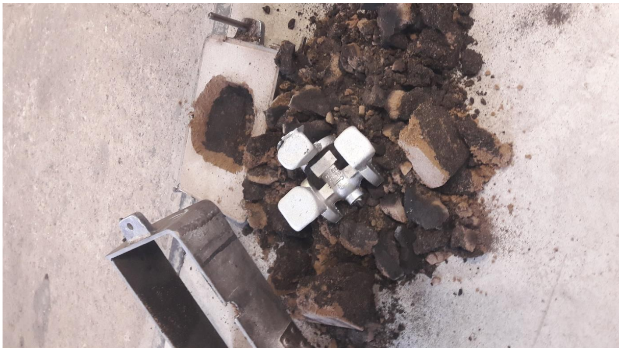
Slika 50. Odvajanje odljevka od kalupne mješavine.
