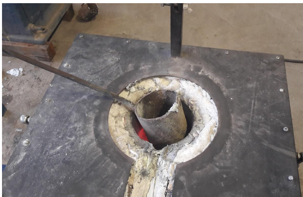
Slika 44. Zagrijavanje lonca za lijevanje
