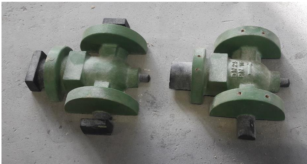
Slika 25. Dvodjelni model odljevka.
