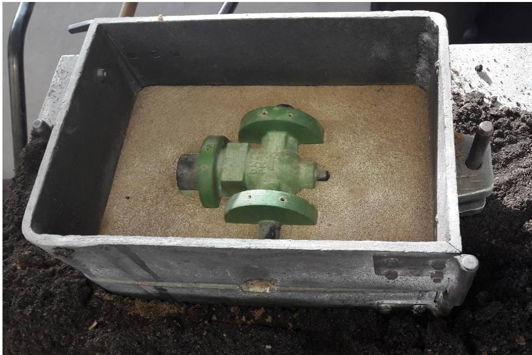
Slika 30. Gornji dio modela posipan likapodijem.
