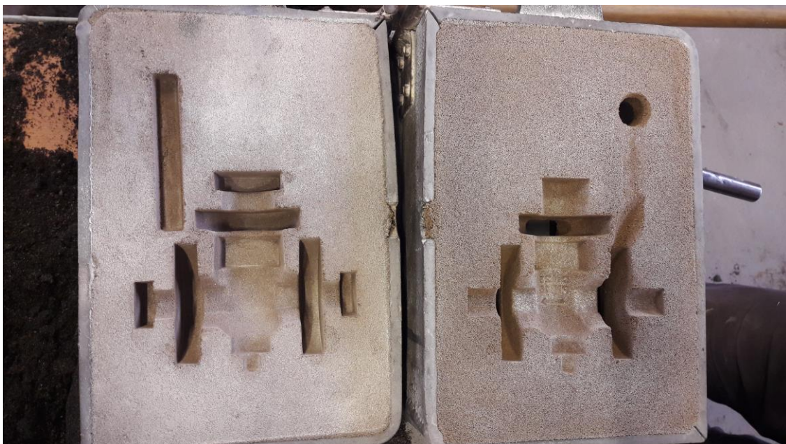
Slika 52. Gornjak i donjak sa ostalim dijelovima uljevnog sustava
