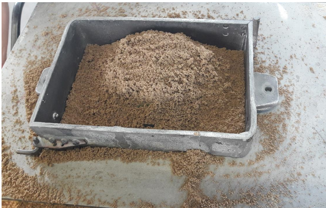
Slika 27. Stavljanje modelne kalupne mješavine.
