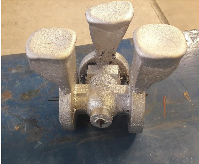
Slika 51. Konačni oblik odljevka
