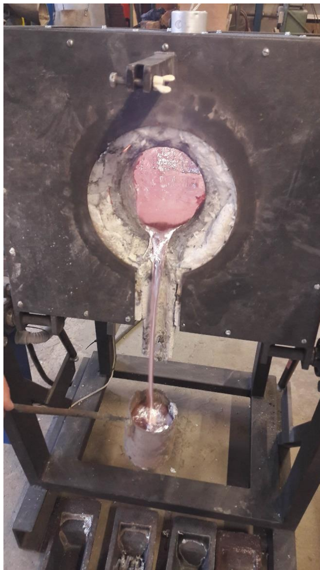
Slika 46. Ulijevanje u lonac
