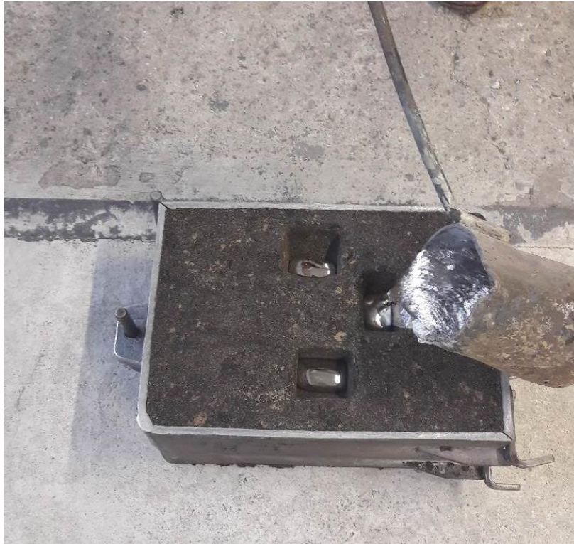
Slika 47. Ulijevanje legure kroz pojilo na gornjoj prirubnici.
