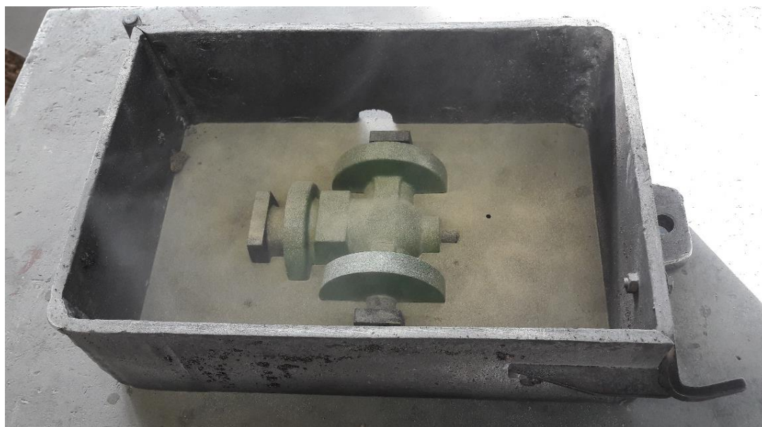
Slika 26. Donji dio modela posipan likapodijem.
