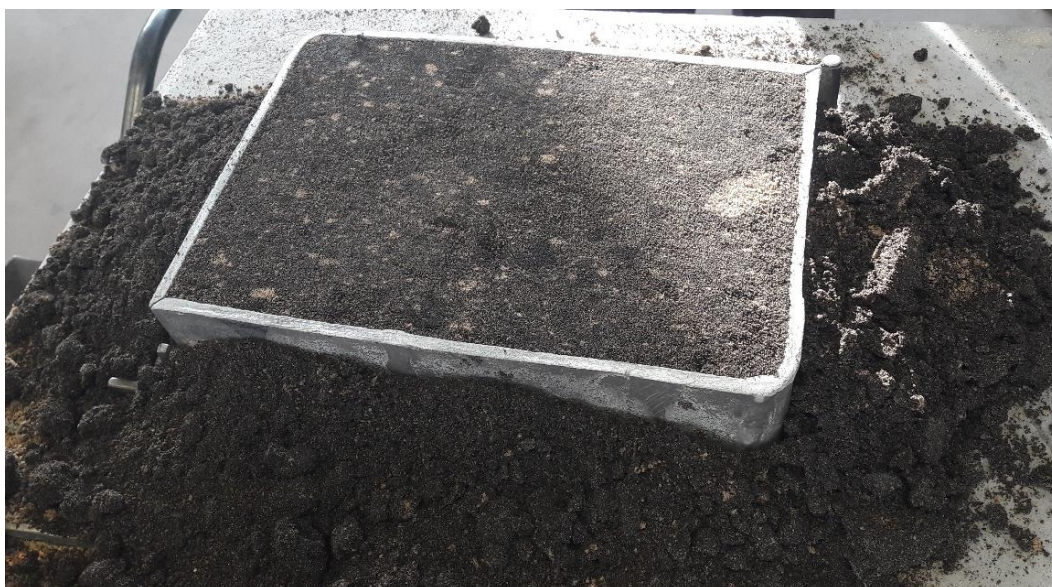
Slika 28. Dopunjivanje punidbenom kalupnom mješavinom i izravnavanje.
