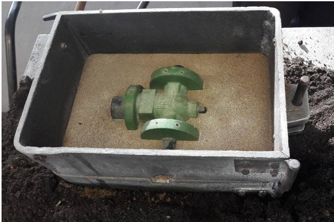
Slika 30. Gornji dio modela posipan likapodijem.
