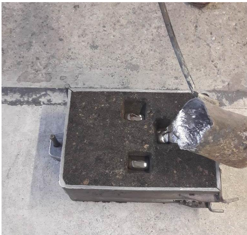
Slika 47. Ulijevanje legure kroz pojilo na gornjoj prirubnici.
