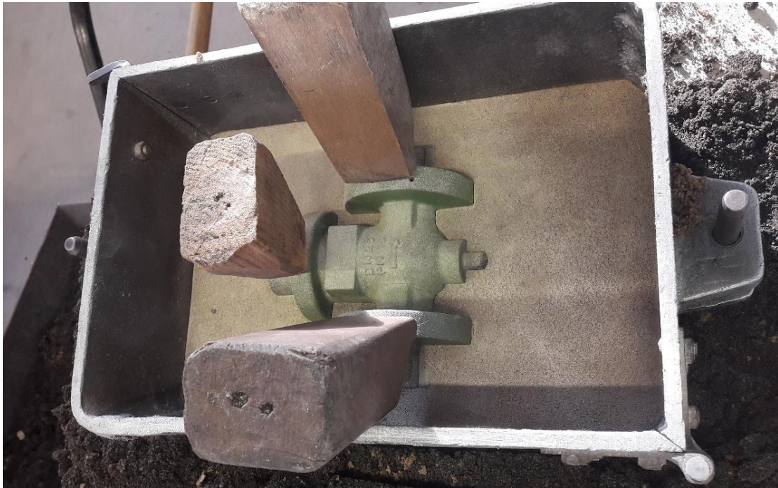
Slika 31. Poziciniranje modela pojila u gornjak.
