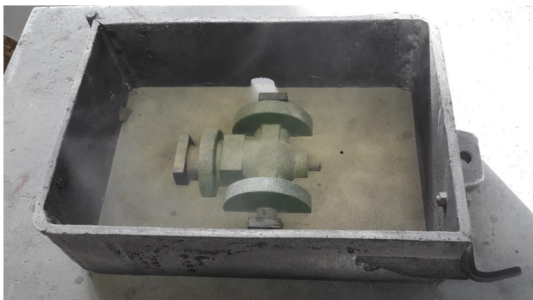
Slika 26. Donji dio modela posipan likapodijem.
