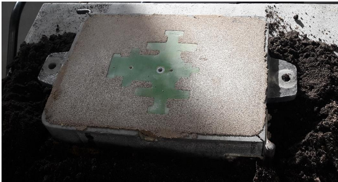
Slika 29. Izgled donjeg dijela kalupa s modelom.
