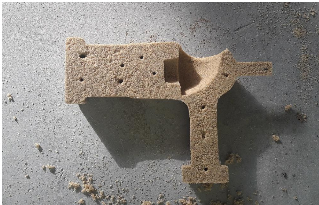
Slika 39. Očvrsnuti dio jezgre spreman za umetanje u kalup.
