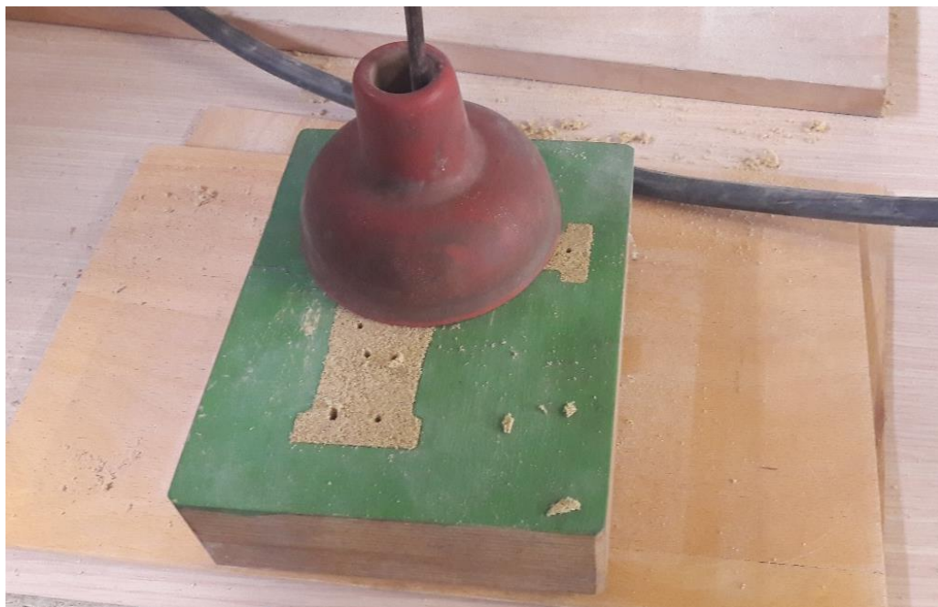
Slika 37. Propuhivanje jezgrene mješavine sa CO 2 plinom
