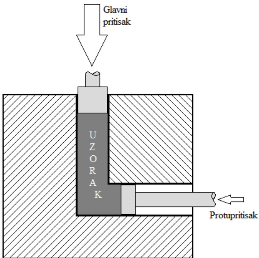
Slika 2.3. ECAP postupak sa protupritisiskom
