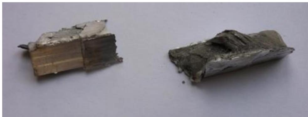
Slika 4.18. Uzorci provučeni kroz ECAP kalup BP-ECAP postupkom
