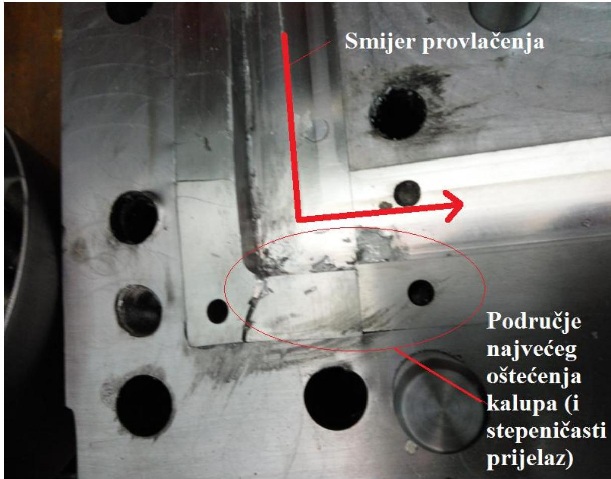
Slika 4.17. Oštećenje ECAP-kalupa
