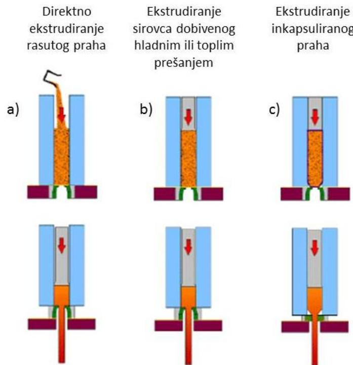
Slika 1.4. Različite procedure konsolidacije metalnih prahova ekstrudiranjem [21, 1]
