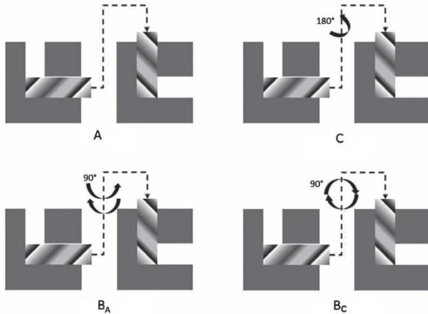
Slika 2.2. Osnovni načini zakretanja uzorka između provlačenja [24]
