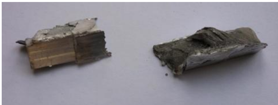
Slika 4.18. Uzorci provučeni kroz ECAP kalup BP-ECAP postupkom
