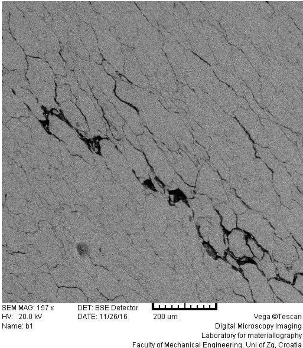
Slika 4.23. Uzdužni presjek uzorka uz povećanje od 157 puta slikan skenirajućim elektronским mikroskopom
