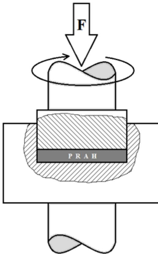
Slika 3.1. Konsolidacija praha torzijskom metodom intenzivne plastične deformacije
