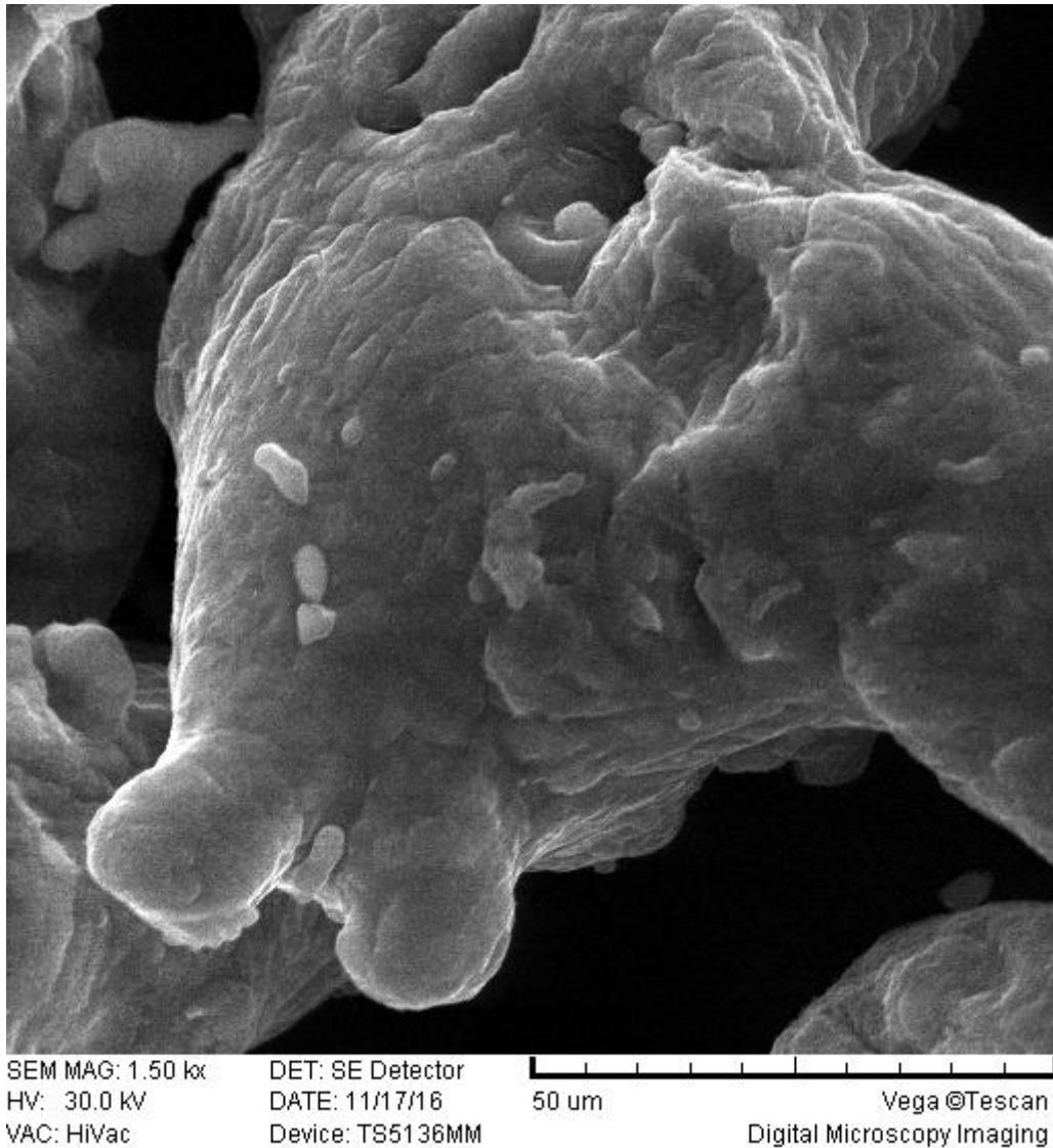
Slika 4.3. Čestice praha slikane skenirajućim elektronskim mikroskopom uz povećanje od 1500 puta
