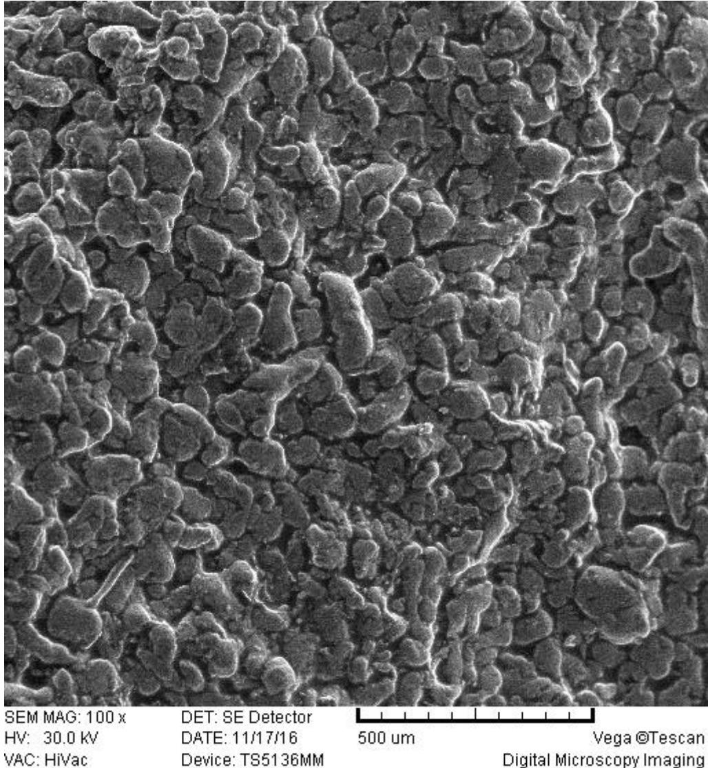
Slika 4.7. Kompaktirani uzorak slikan skenirajućim elektronskim mikroskopom, povećanje 100 puta
