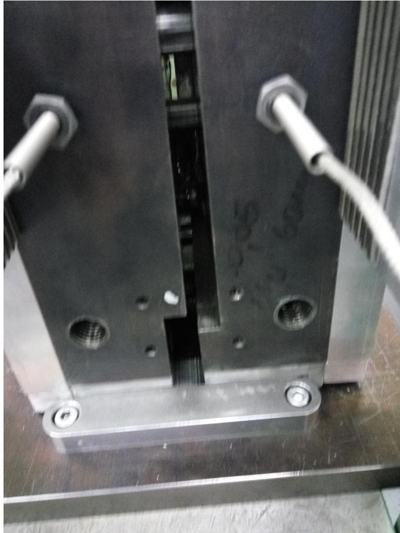
Slika 4.16. Otvaranje ECAP kalupa
