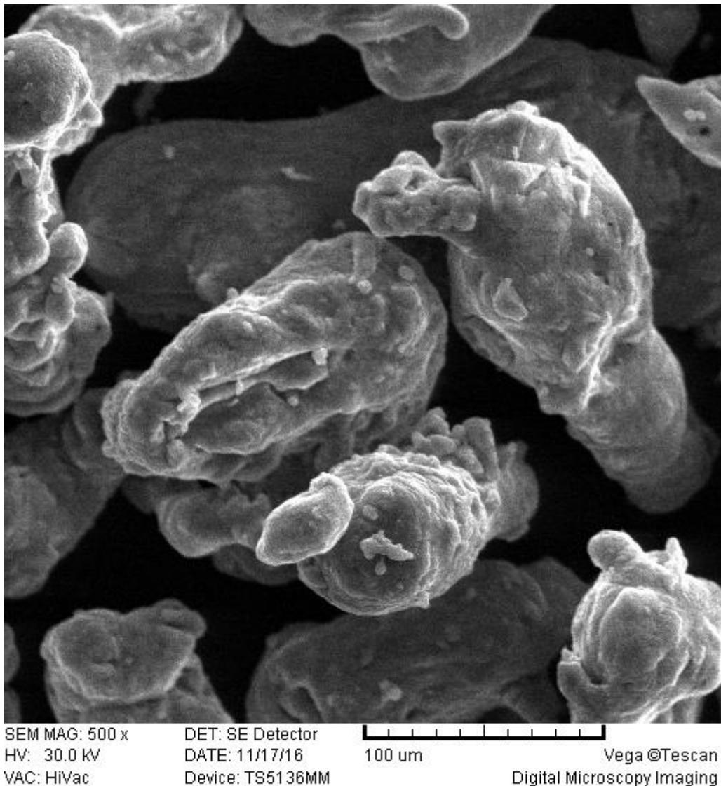
Slika 4.2. Čestice praha slikane skenirajućim elektronskim mikroskopom, povećanje 500 puta
