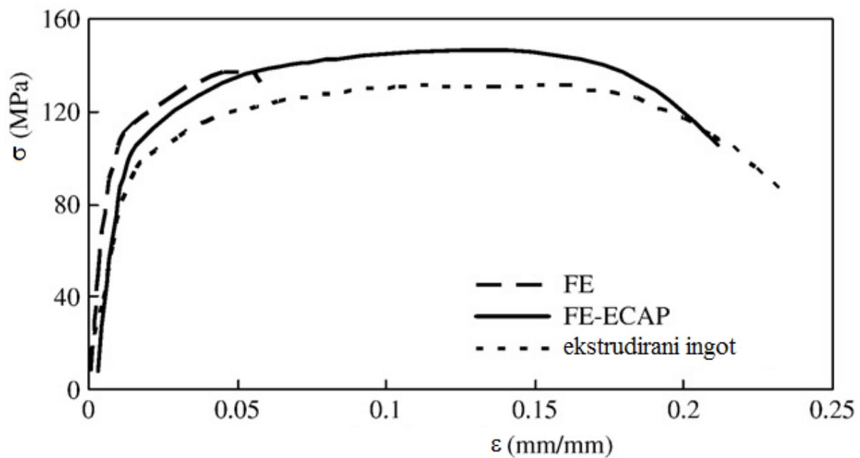
Slika 3.6.  $\sigma$ - $\varepsilon$  dijagram za uzorak od ekstrudiranog ingota, FE-uzorak i FE-ECAP uzorak [33]
