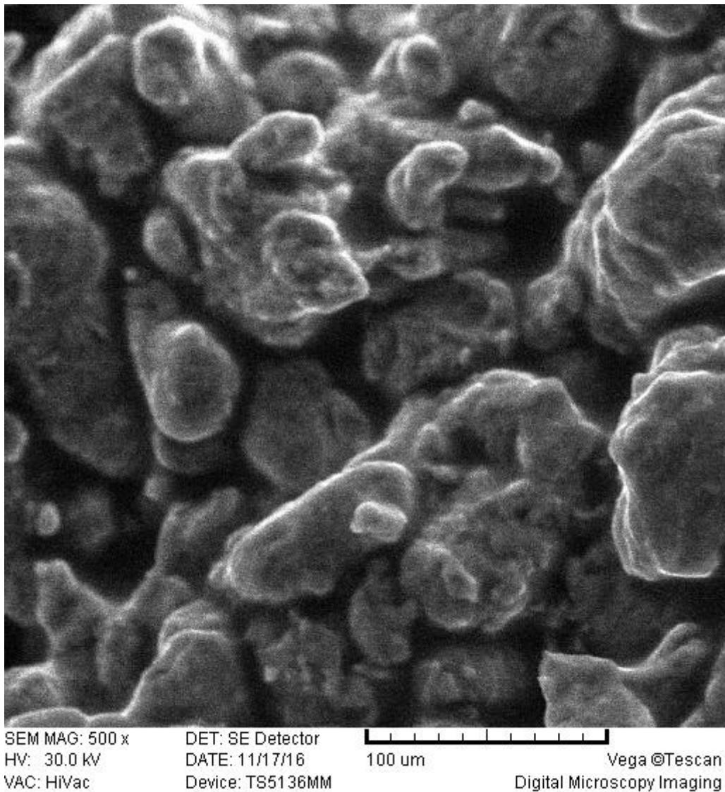
Slika 4.8. Hladno izostatski prešani uzorak slikan SEM elektronskim mikroskopom povećanje, 500 puta
