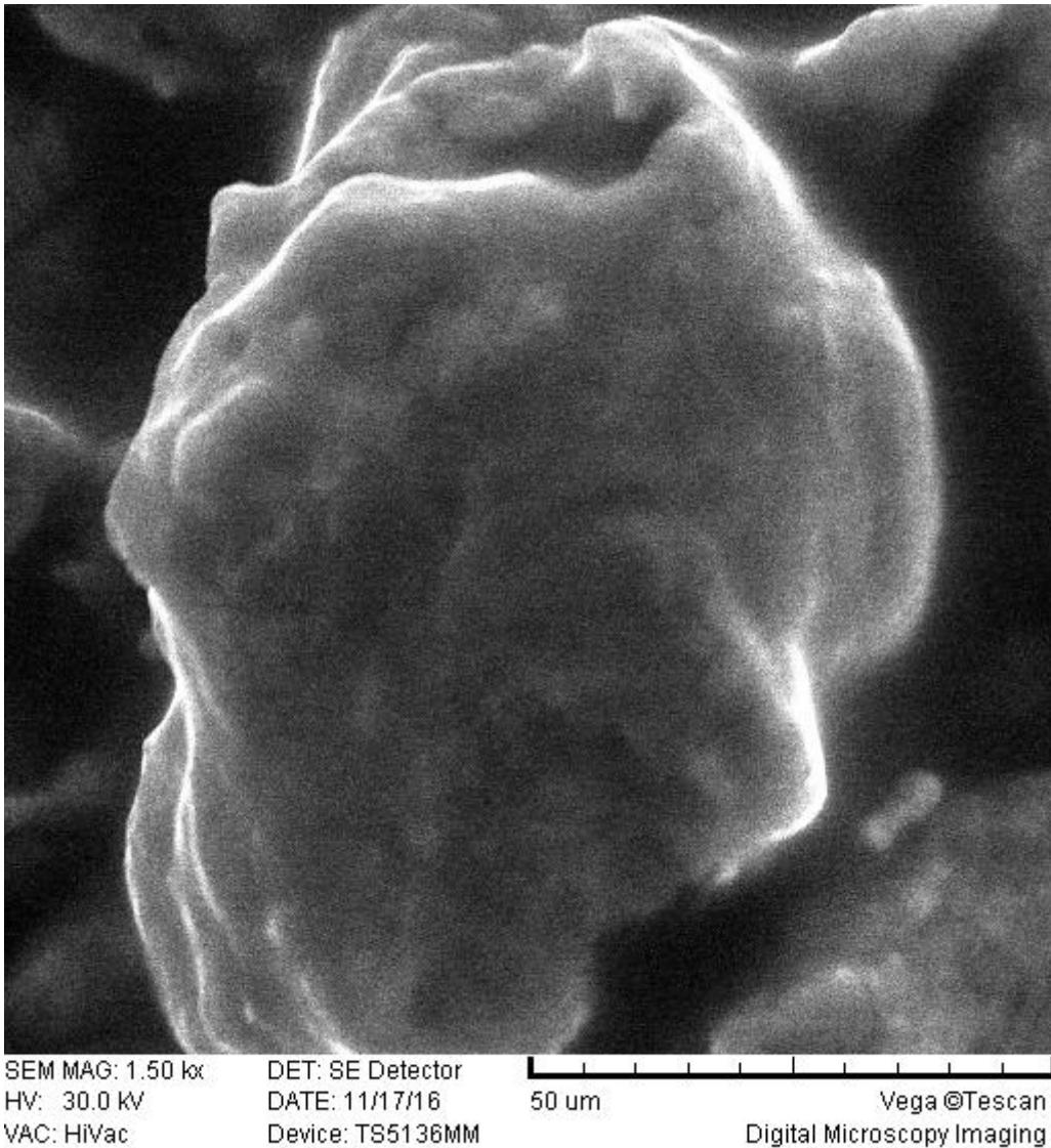
Slika 4.9. Zrno praha u kompaktiranom uzorku slikano skenirajućim elektronskim mikroskopom, povećanje 1500 puta
