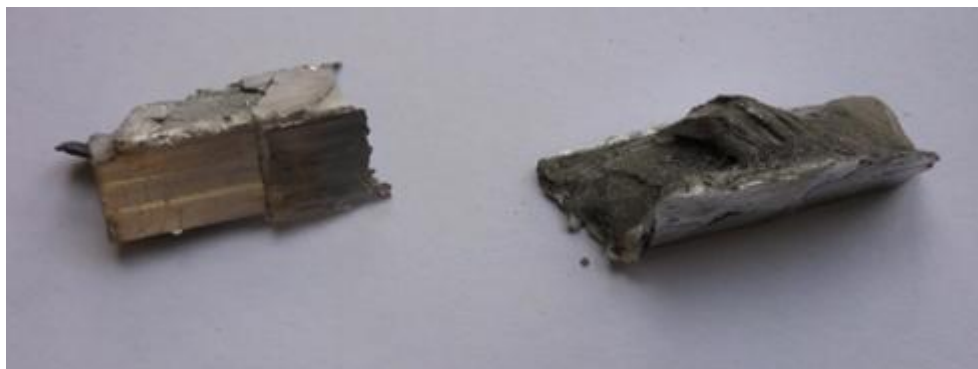
Slika 4.18. Uzorci provučeni kroz ECAP kalup BP-ECAP postupkom
