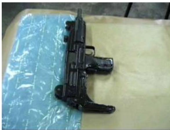
Slika 17. Primjena zaštite inhibitora za naoružanje [3]
