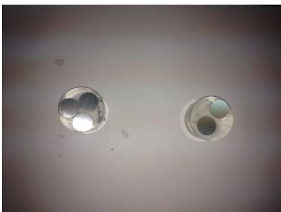
Slika 26. Uzorci Ø16 mm nakon brušenja
