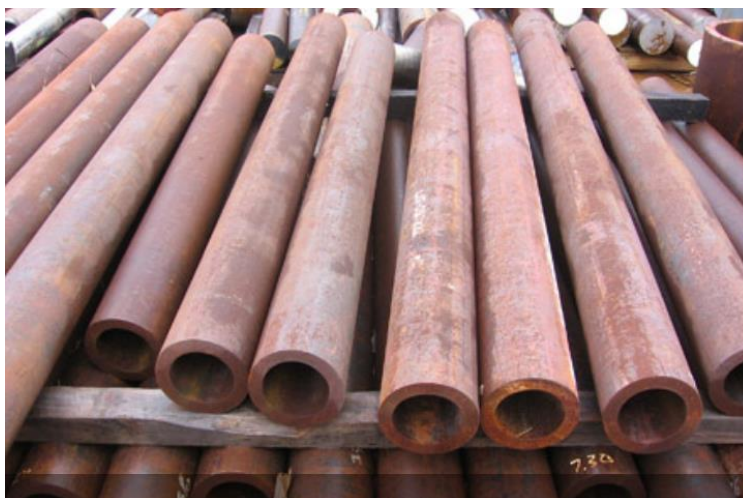
Slika 4. Opća korozija cijevi [5]
