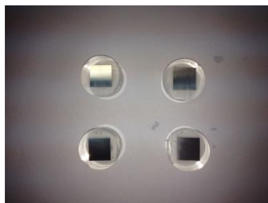
Slika 27. Uzorci 20x20mm nakon brušenja
