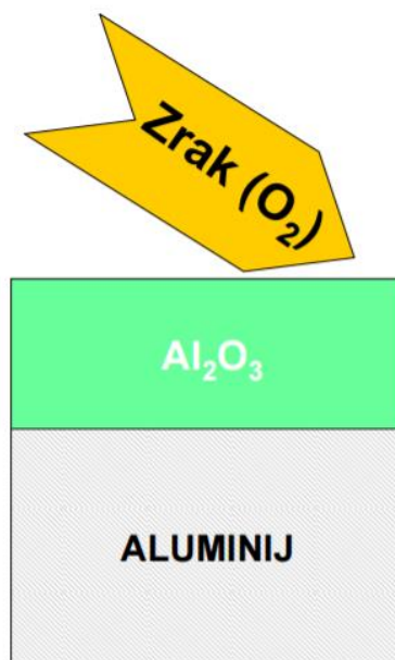
Slika 1. Produkti kemijske korozije na aluminiju [4]
