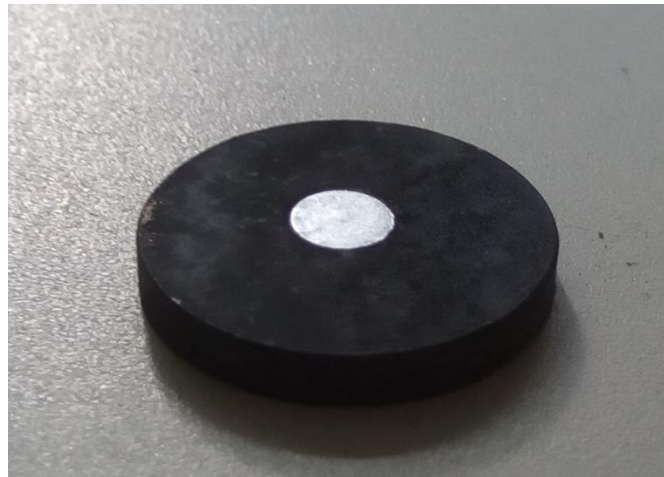
Slika 32. Izgled površine nakon provođenja GDOS analize uzorka
