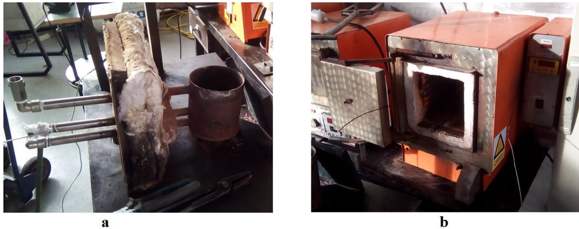
Slika 27. a) retorta za aluminiziranje u prahu, b) električna komorna peć
