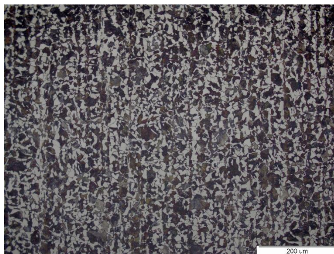
Slika 49. Mikrostruktura jezgre uzorka A2, 200x
