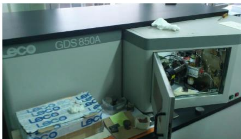
Slika 31. Uređaj LECO GDS 850A za optičku emisijsku spektrometriju (GDOS)
