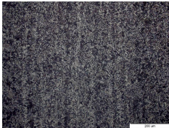
Slika 53. Mikrostruktura jezgre uzorka B2, 200x
