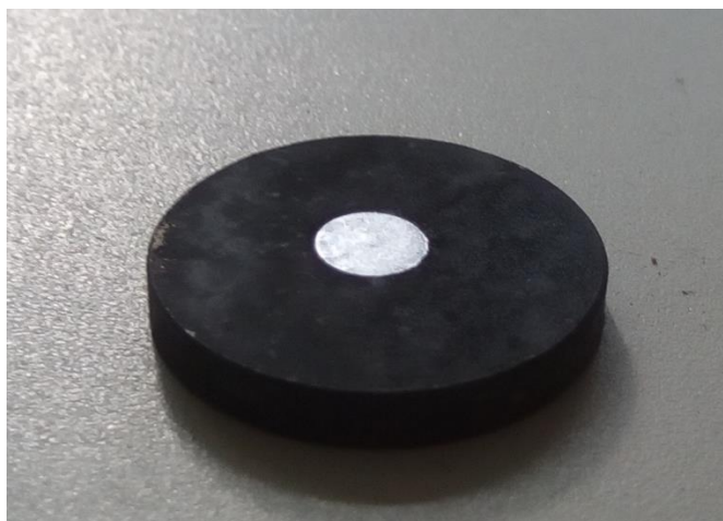
Slika 32. Izgled površine nakon provođenja GDOS analize uzorka
