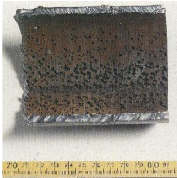
Slika 10. Erozijska korozija – kavitacija nelegiranog čelika [9]
