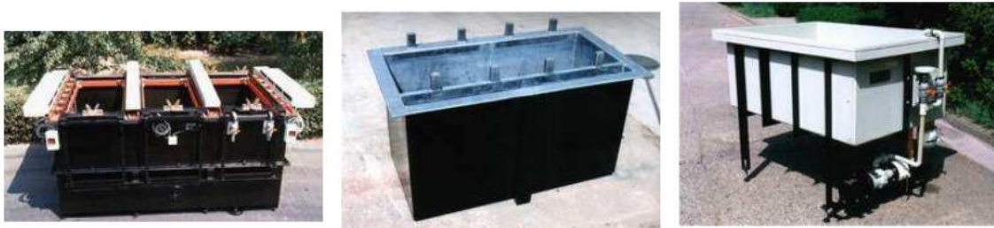
Slika 17. Primjeri spremnika koji se koriste u postupcima galvaniziranja [17]
