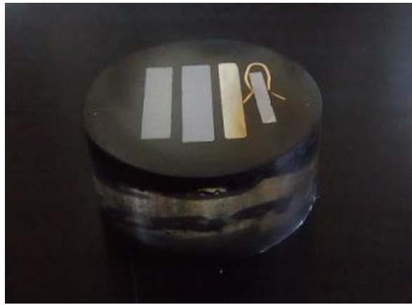
Slika 42. Uzorci zaliveni u polimernu masu
