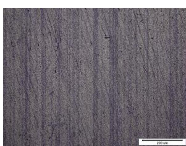
Slika 61. Mikrostruktura jezgre uzorka D2, 200x
