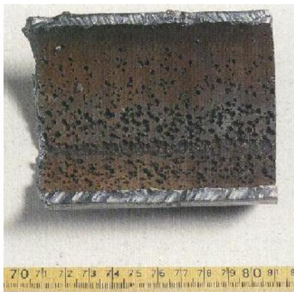
Slika 10. Erozijska korozija – kavitacija nelegiranog čelika [9]
