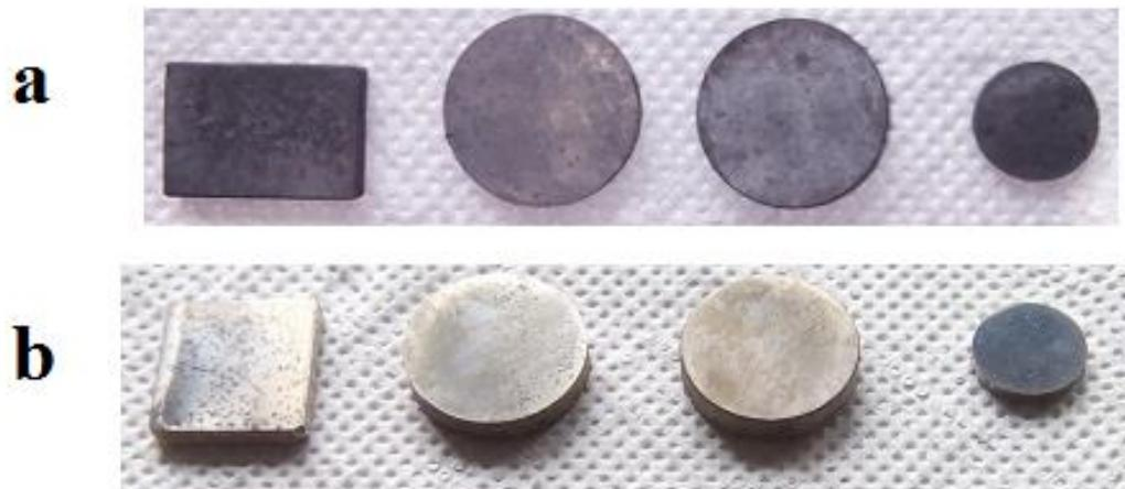
Slika 30. a) uzorci nakon aluminiziranja u smjesi praha I, b) uzorci nakon aluminiziranja u smjesi praha II
