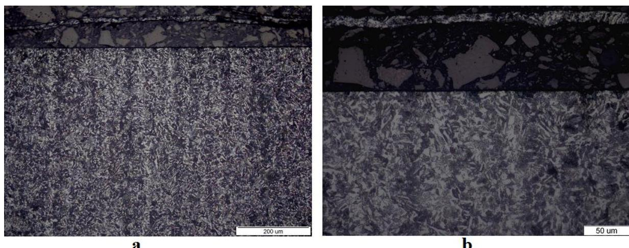
Slika 52. Mikrostruktura rubnog sloja uzorka B2: a) 200x, b) 500x
