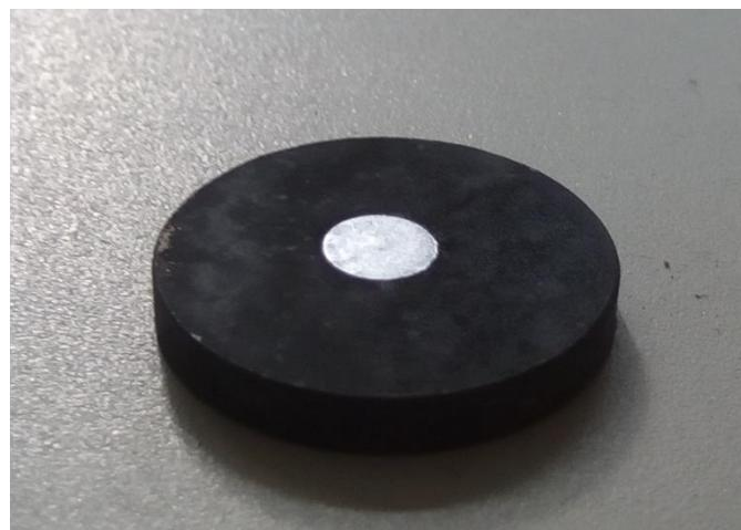
Slika 32. Izgled površine nakon provođenja GDOS analize uzorka
