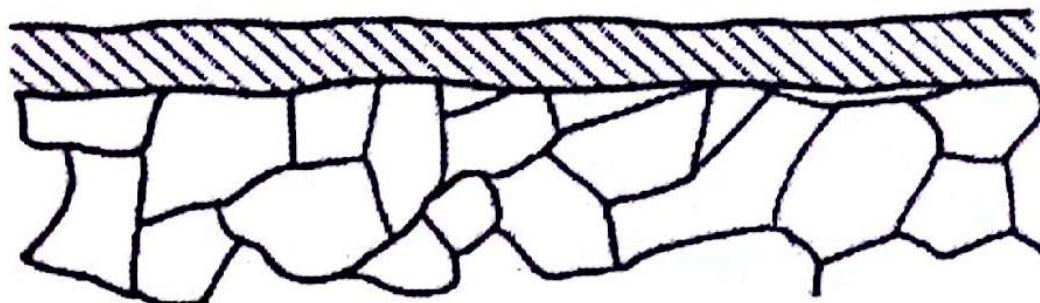
Slika 5. Opća korozija [2]
