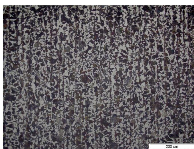
Slika 49. Mikrostruktura jezgre uzorka A2, 200x
