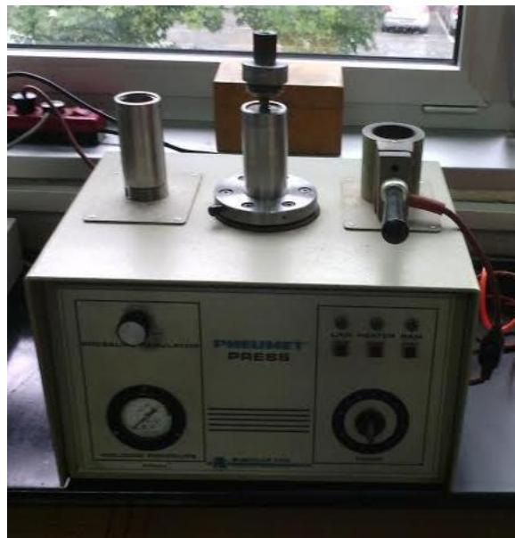
Slika 41. Uređaj za zalijevanje uzorka
