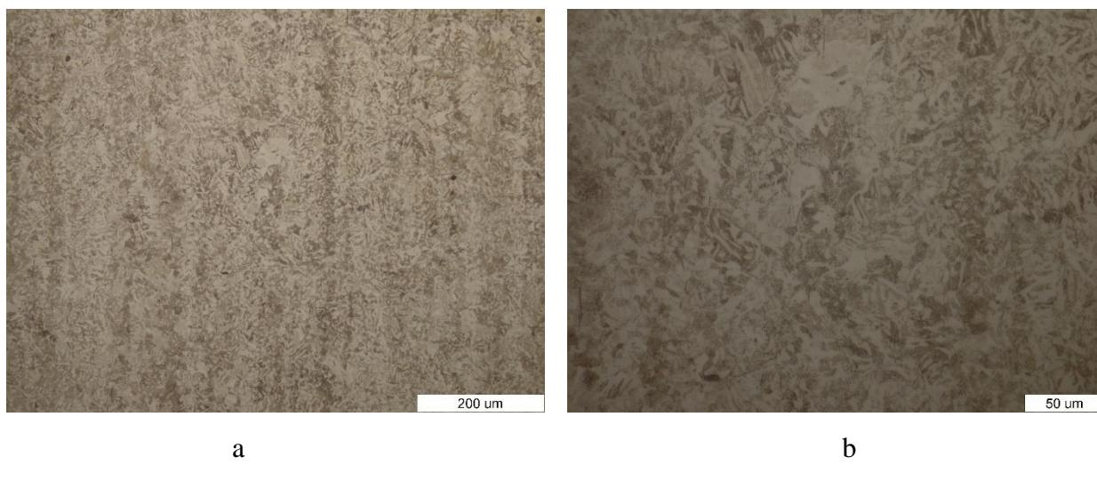
Slika 63. Mikrostruktura uzorka B u osnovnom stanju
