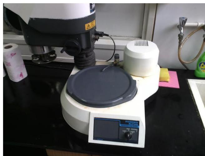
Slika 43. Uređaj za brušenje uzorka
