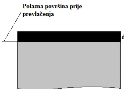
Slika 16. Shematski prikaz postupaka prevlačenja, d – debljina površinskog sloja
