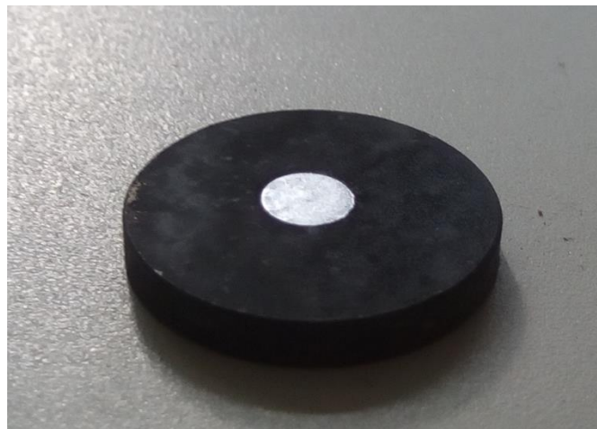
Slika 32. Izgled površine nakon provođenja GDOS analize uzorka
