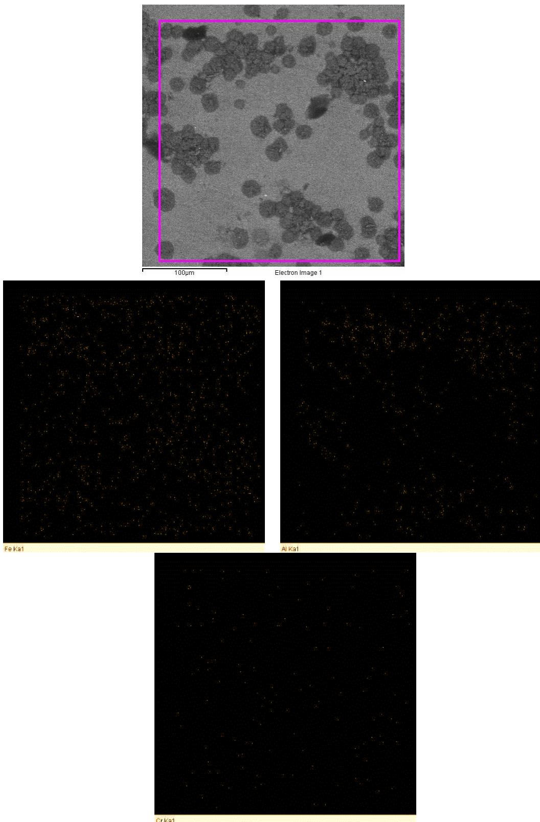
Slika 73. SEM snimka i EDS mapiranje površine uzorka D1
