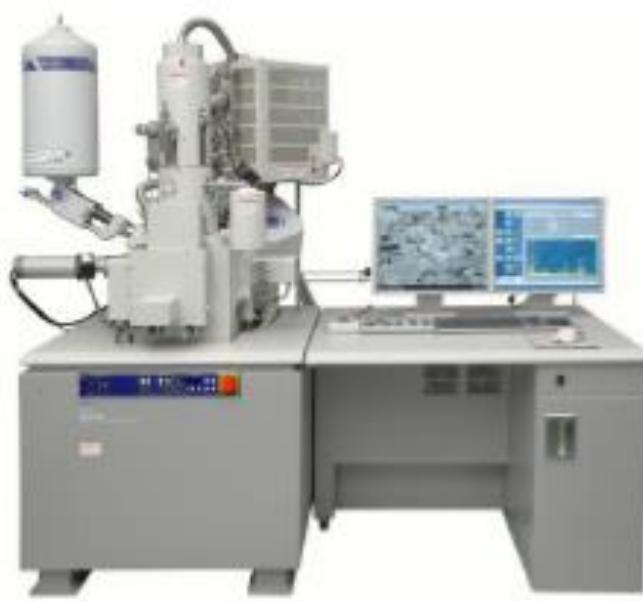
Slika 66. Uredaj za provođenje SEM/EDS analize
