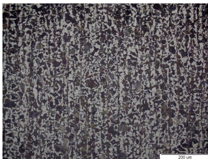
Slika 49. Mikrostruktura jezgre uzorka A2, 200x
