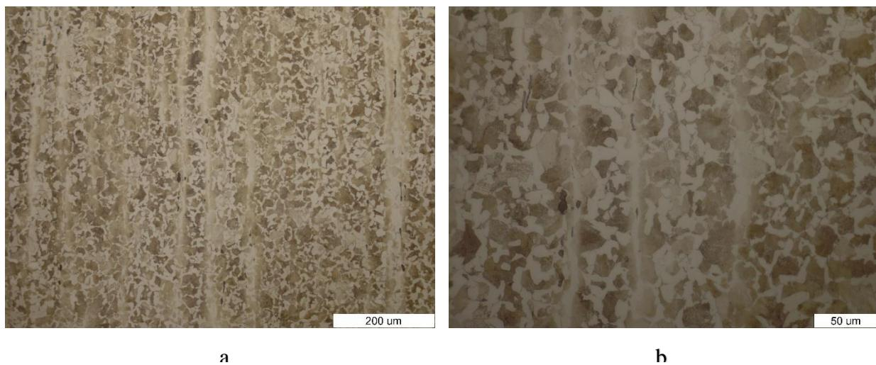
Slika 62. Mikrostruktura uzorka A u osnovnom stanju
