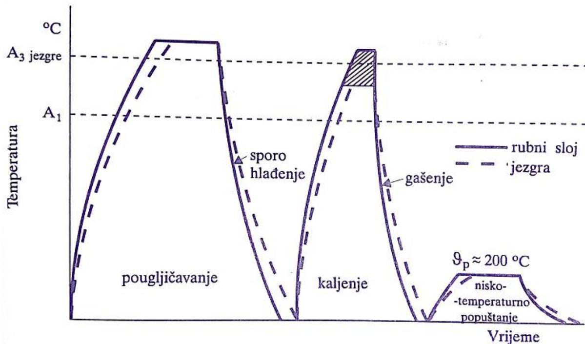
Slika 14. Dijagram mogućeg postupka cementiranja čelika [14]
