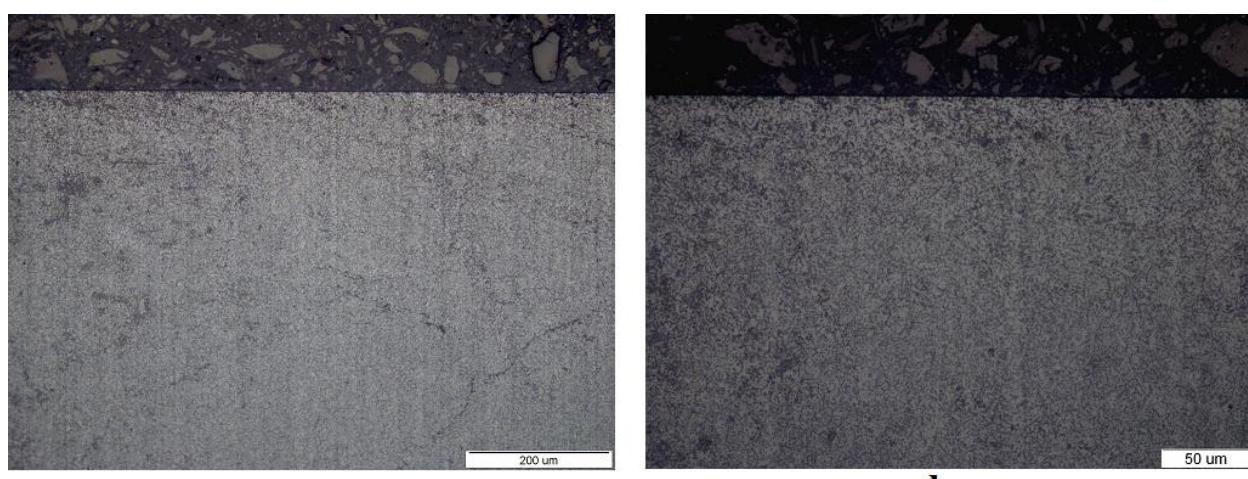
Slika 60. Mikrostruktura rubnog sloja uzorka D2: a) 200x, b) 500x
