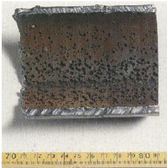
Slika 10. Erozijska korozija – kavitacija nelegiranog čelika [9]
