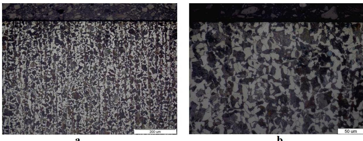
Slika 48. Mikrostruktura rubnog sloja uzorka A2 a) 200x, b) 500x
