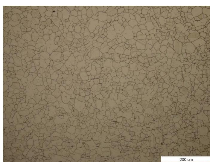
Slika 55. Mikrostruktura jezgre uzorka C1, 200x
