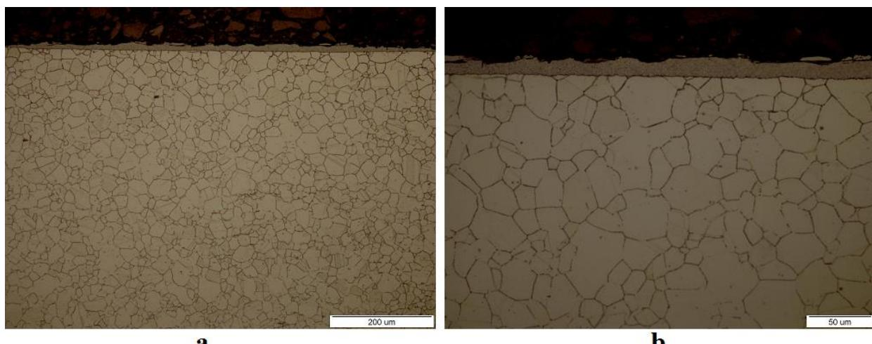
Slika 54. Mikrostruktura rubnog sloja uzorka C1: a) 200x, b) 500x
