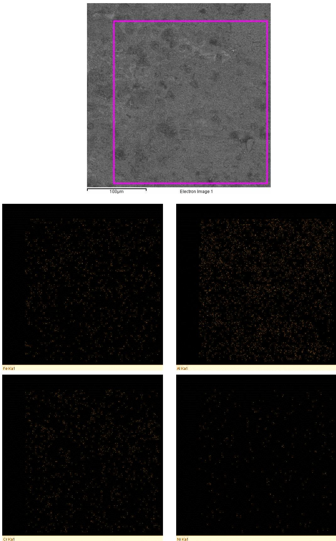
Slika 71. SEM snimka i EDS mapiranje površine uzorka C1
