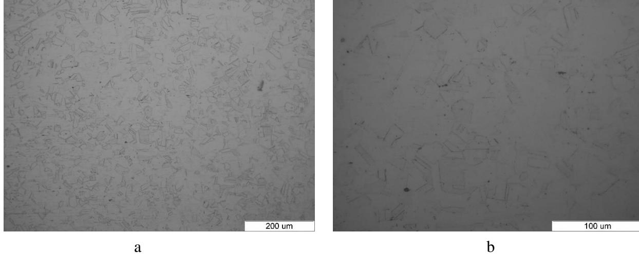
Slika 64. Mikrostruktura uzorka C u osnovnom stanju
