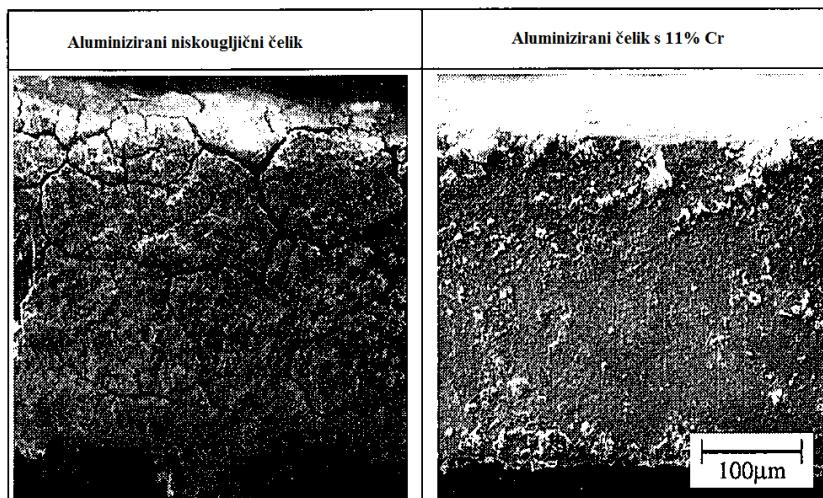
Slika 24 Mikrostruktura aluminiziranog niskougljičnog čelika i aluminiziranog čelika s 11 % Cr nakon 5 godina u uporabi [30].
