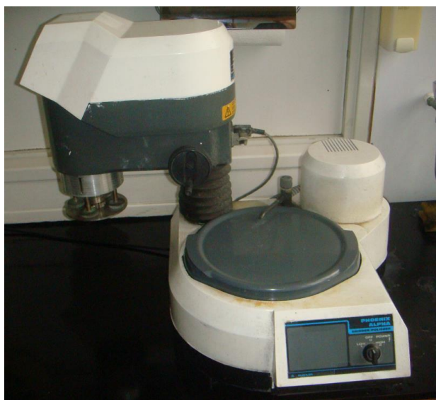
Slika 32. Uređaj za izradu makroizbrusaka
