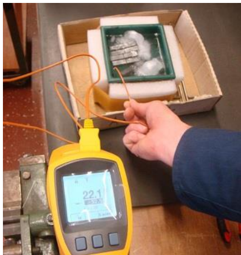
Slika 46. Ohlađivanje uzoraka na -40^{\circ}
