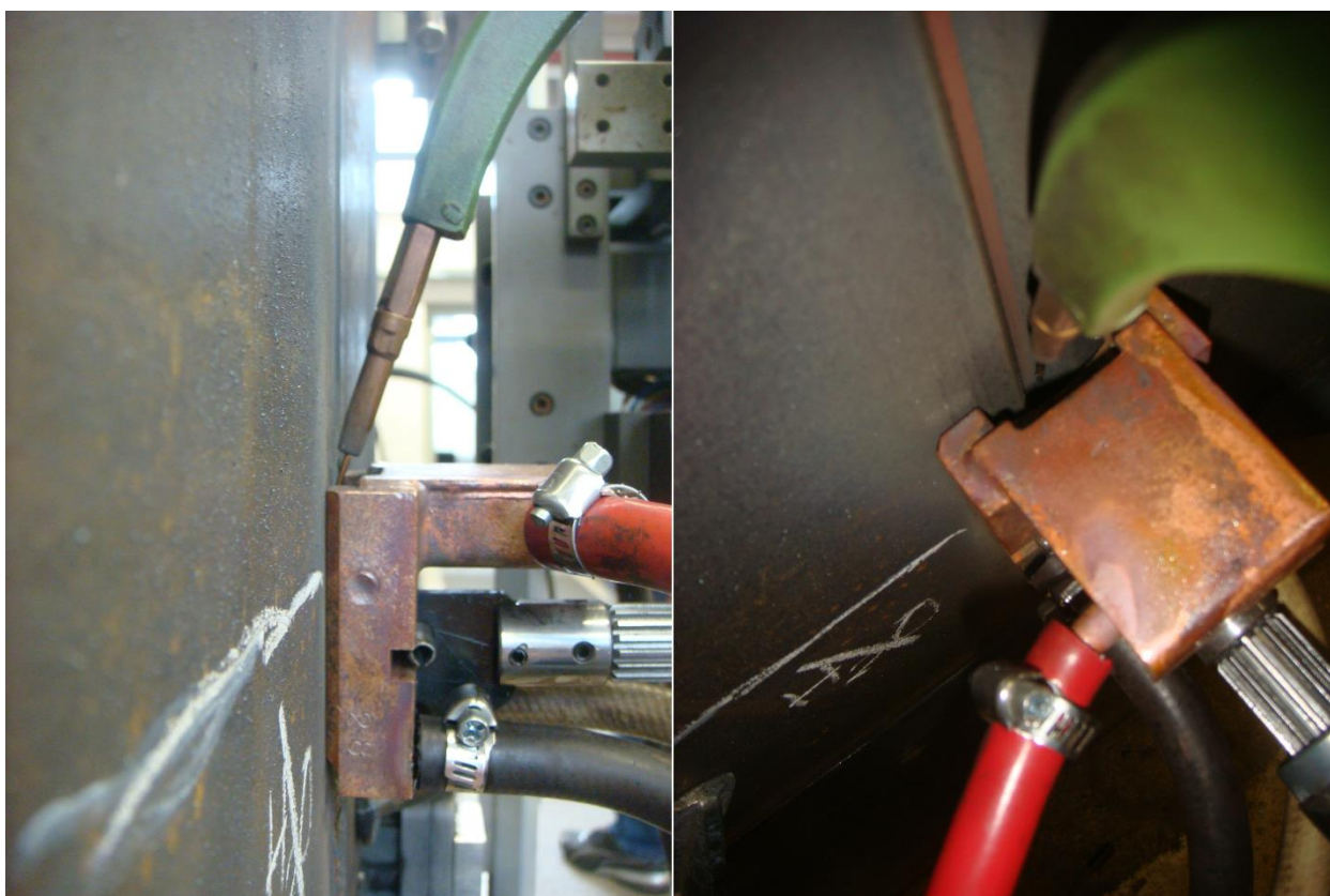
Slika 27. Položaj elektrode prije zavarivanja
