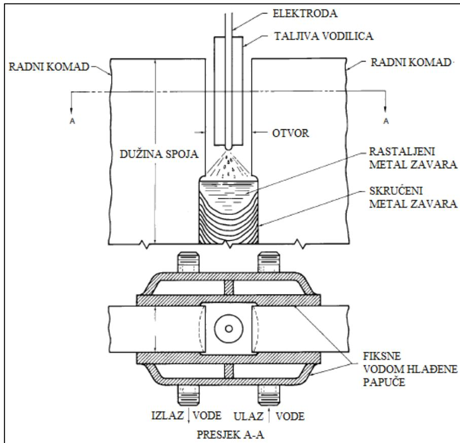
Slika 5. Shematski prikaz EPZ-a s taljivim vodilicama [1]
