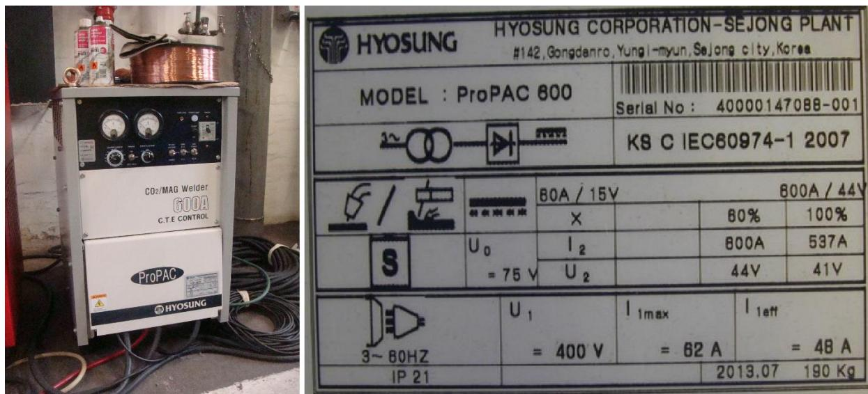
Slika 20. Izvor struje za zavarivanje s identifikacijskom pločicom
