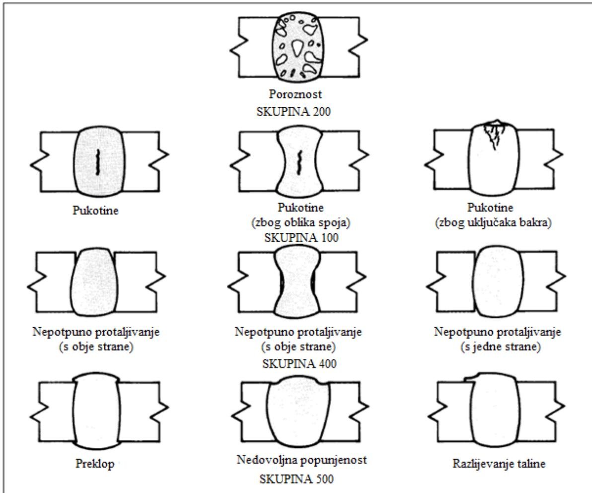
Slika 16. Karakteristične nepravilnosti u zavarenom spoju kod EPZ-a [1]
