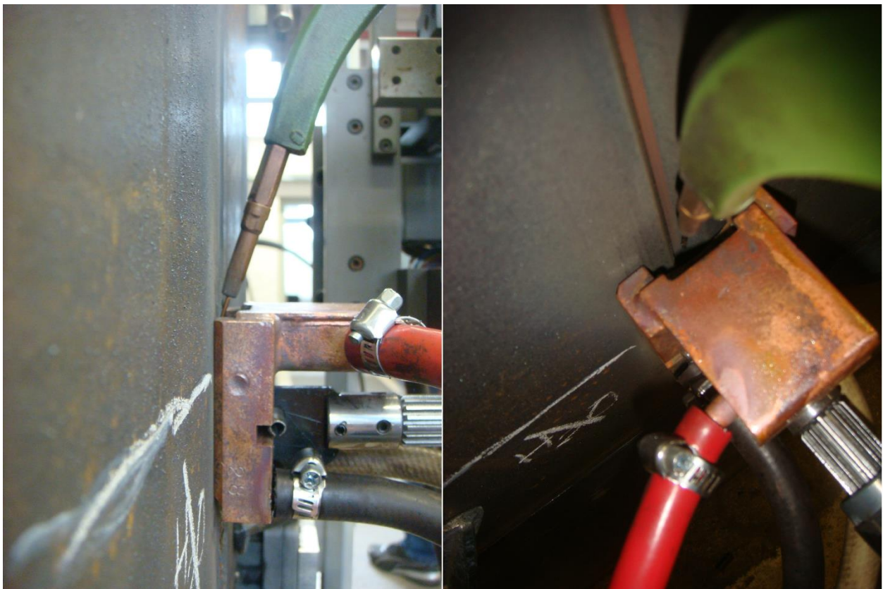
Slika 27. Položaj elektrode prije zavarivanja
