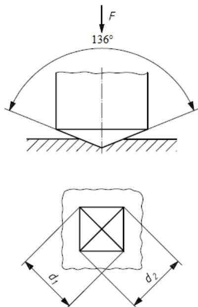
Slika 36. Principi mjerjenja kod Vickersove metode [23]
