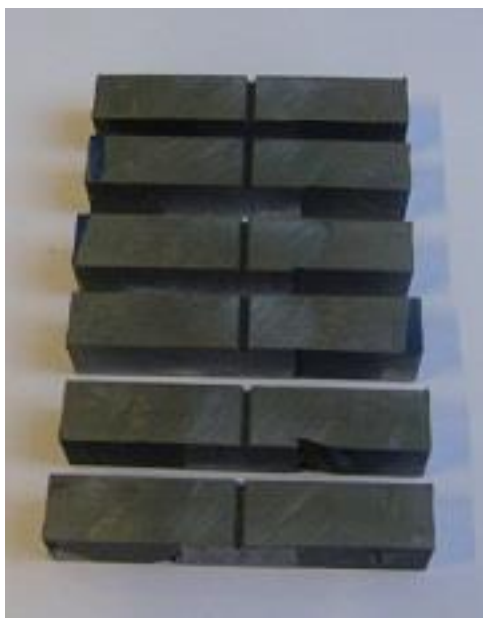
Slika 44. Epruvete za ispitivanje udarne radnje loma
