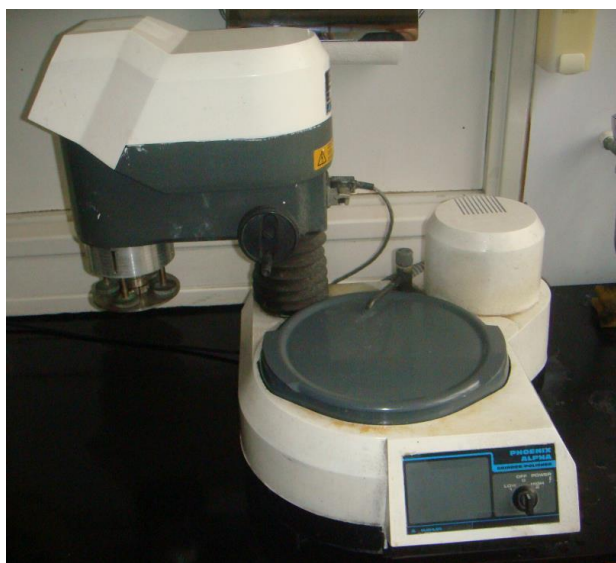
Slika 32. Uređaj za izradu makroizbrusaka
