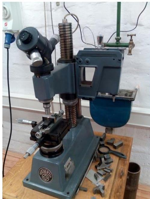
Slika 35. Uređaj za mjerjenje tvrdoće
