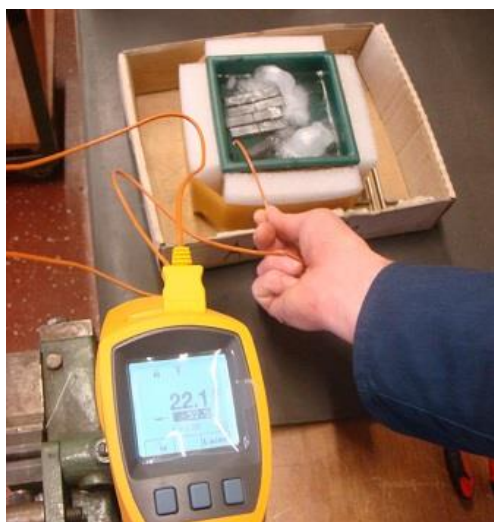
Slika 46. Ohlađivanje uzoraka na -40^{\circ}
