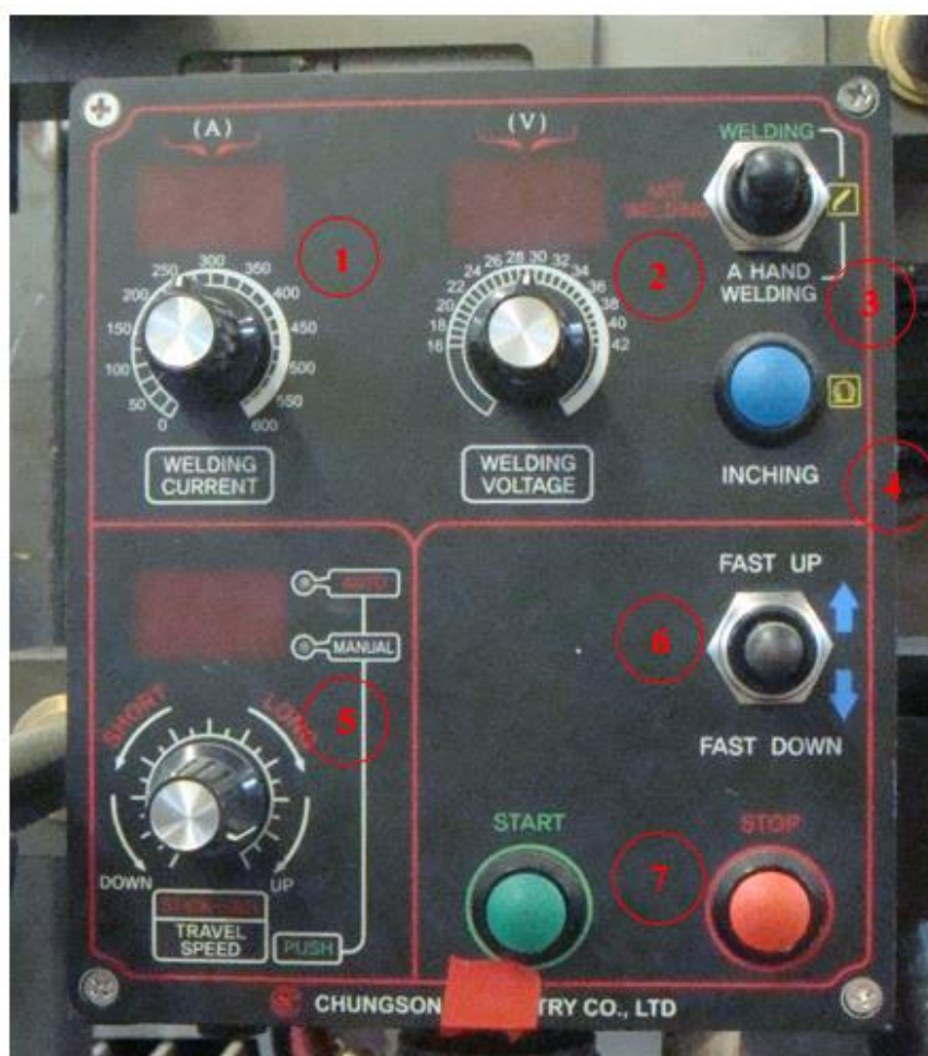
Slika 22. Kontrolna ploča glave za zavarivanje
