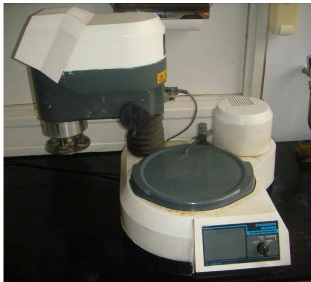
Slika 32. Uređaj za izradu makroizbrusaka
