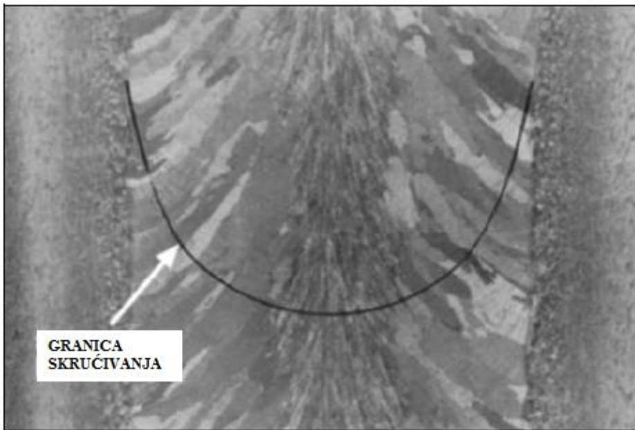
Slika 2. Prikaz zrna na vertikalnom presjeku kod EPZ-a [1]
