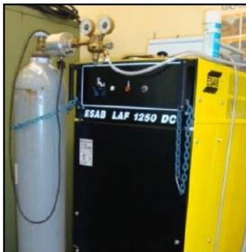
IZVOR STRUJE ZA ZAVARIVANJE + ZAŠTITNI PLIN
