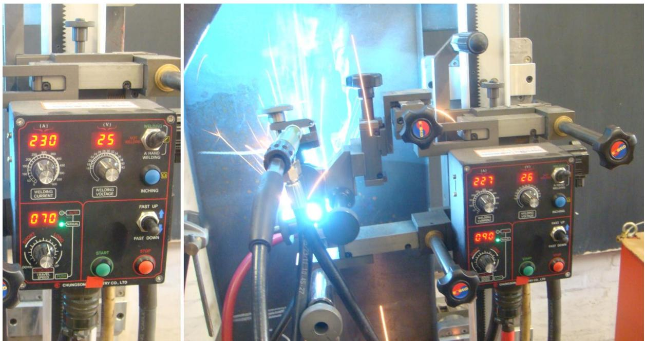
Slika 29. EPZ sa zaštitom M21 i povećanom brzinom gibanja kako se talina ne bi prelila
