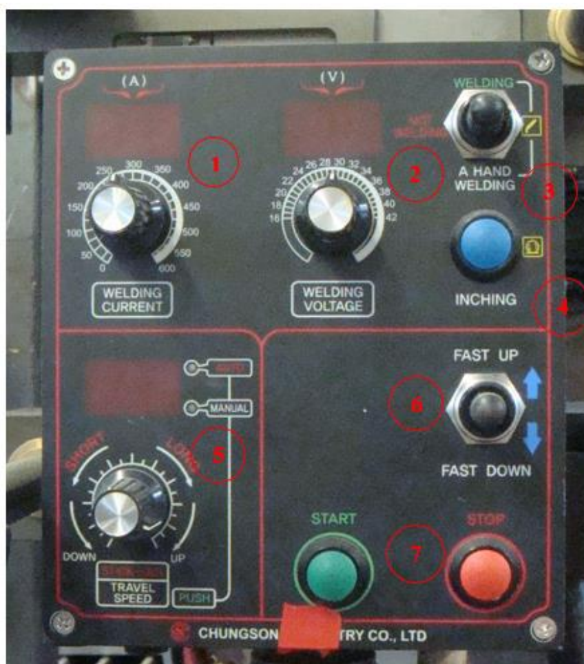
Slika 22. Kontrolna ploča glave za zavarivanje
