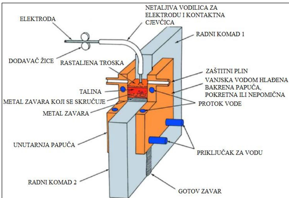
Slika 4. Shematski prikaz EPZ-a s pomičnim kalupima [1]
