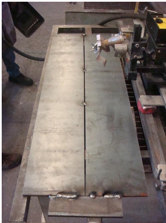
Slika 24. Pripajanje pločice i ploča za zavarivanje
