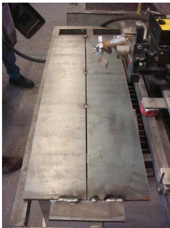
Slika 24. Pripajanje pločice i ploča za zavarivanje
