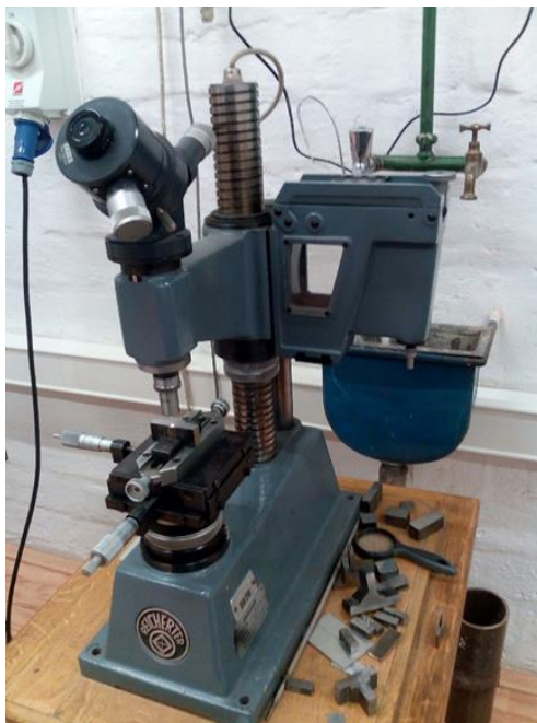
Slika 35. Uređaj za mjerenje tvrdoće
