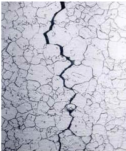
Slika 10. Prikaz oštećenja uslijed interkristalne korozije [23]
