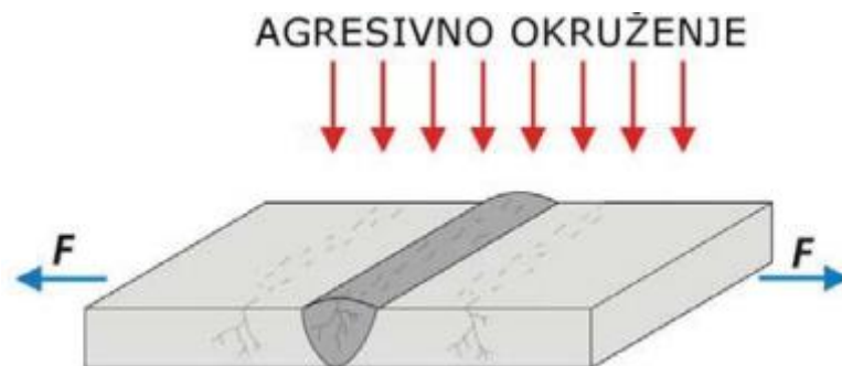
Slika 11. Čimbenici koji utječu na pojavu napetosne korozije
