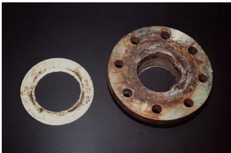
Slika 7. Prikaz korozijskog oštećenja uslijed korozije u procjepu
