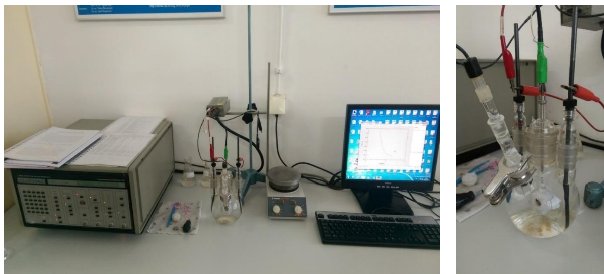
Slika 25. Prikaz opreme za elektrokemijsko DC ispitivanje (lijevo) i troelektrodne elektrokemijske ćelije (desno)
