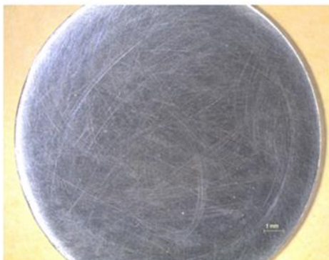
Slika 37. Dijagram cikličke polarizacije i površine nakon ispitivanja za AISI 304 pri 23±2 °C
