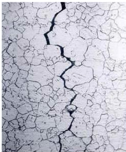
Slika 10. Prikaz oštećenja uslijed interkristalne korozije [23]
