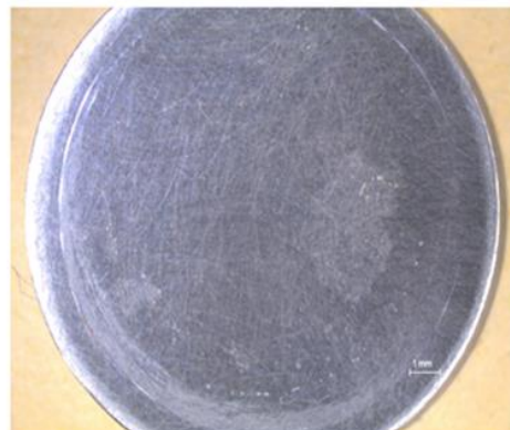
Slika 36. Dijagram cikličke polarizacije i površine nakon ispitivanja za AISI 304 pri 15±2 °C
