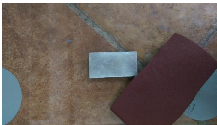
Slika 42. Prikaz brušenja uzoraka
