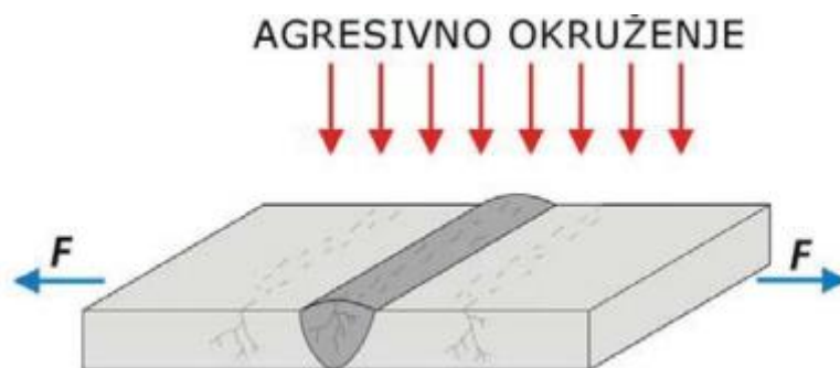
Slika 11. Čimbenici koji utječu na pojavu napetosne korozije
