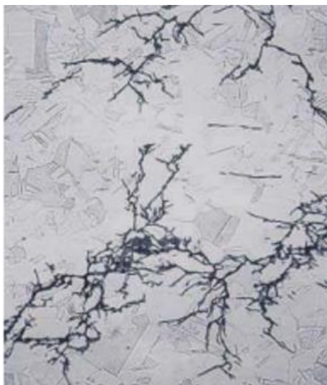
Slika 12. Napetosna korozija AISI 316 čelika [25]
