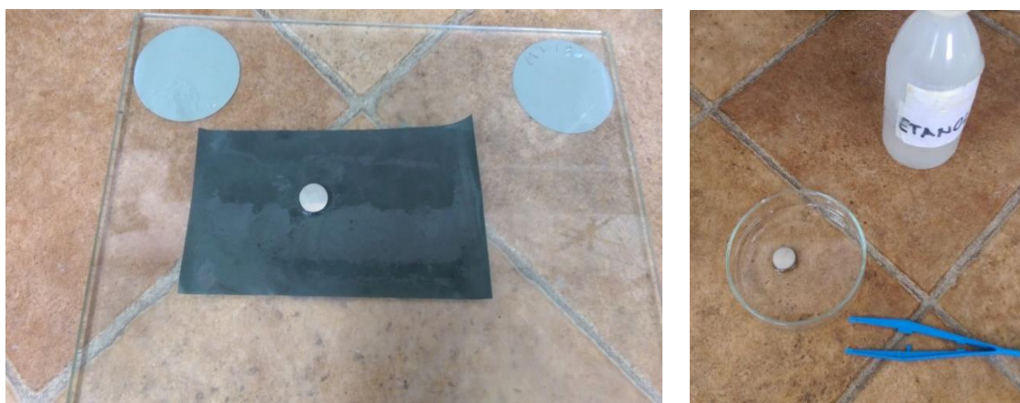
Slika 23. Priprema elektrolita (umjetna morska voda)
