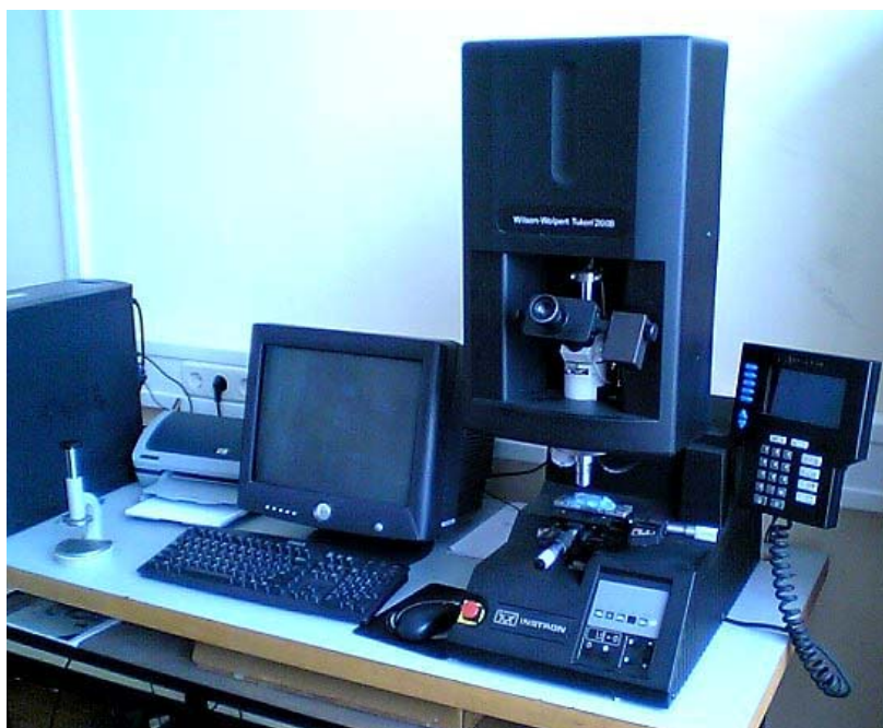
Slika 19. Mikrotvrdomjer Instron, Wilskon-Wolpert Tukon 2100B
