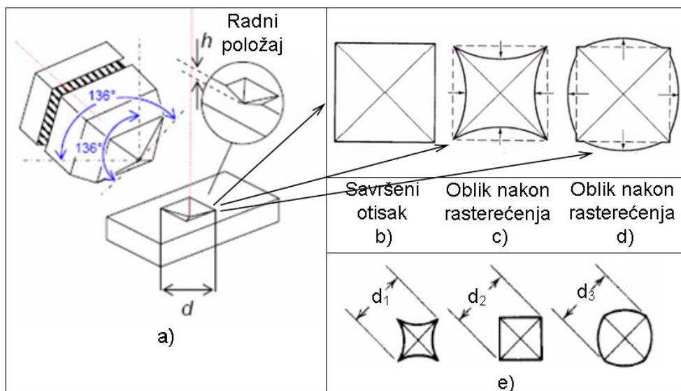
Slika 16. Shematski prikaz Vickersovog penetratora i mogućih izgleda otiska nakon rasterećenja [17]
