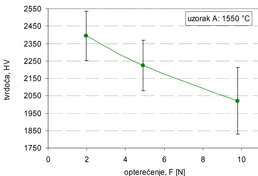
*Slika 21. Vrijednosti mikrotvrdote mjerene Vickersovom metodom u ovisnosti o opterećenju za  $Al_2O_3$  keramiku, uzorak A.*
