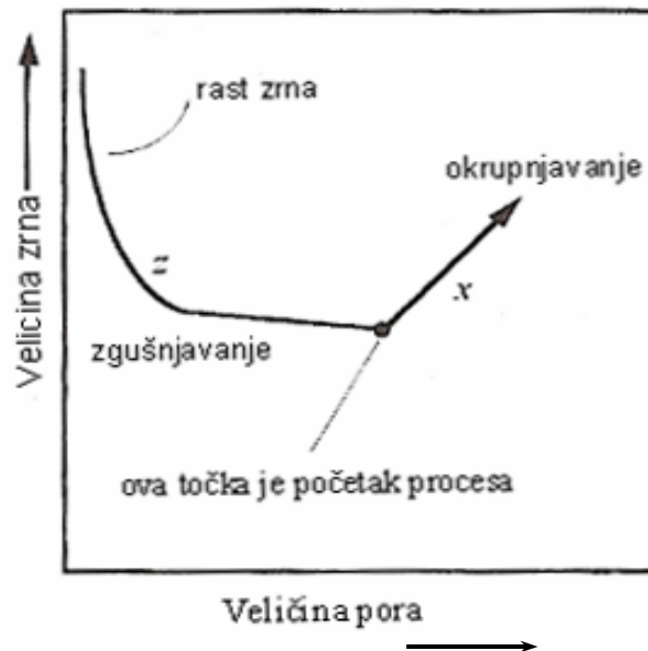
Slika 13. Ovisnost vremenskog razvoja zrna i pora: okrupnjavanje vodi k povećanju i zrna i pora, dok zgušnjavanje uklanja pore [4]
