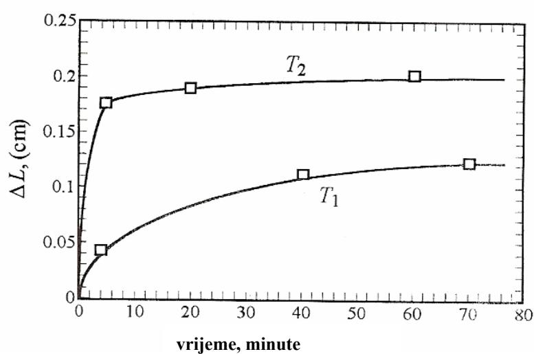
Slika 14. Krivulja osnog skupljanja za vrijeme sinteriranja ovisno o temperaturi,
