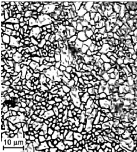
Slika 3. Mikrostruktura sitnozrnate aluminij oksidne keramike [2]
