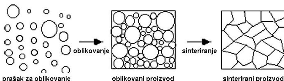
Slika 6. Zgušnjavanje mase oblikovanjem za daljnju obradu (sinteriranje) [4]
