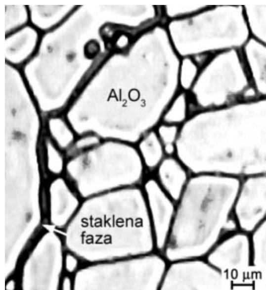
*Slika 4. Mikrostruktura grubokristalne aluminij oksidne keramike [2]*
