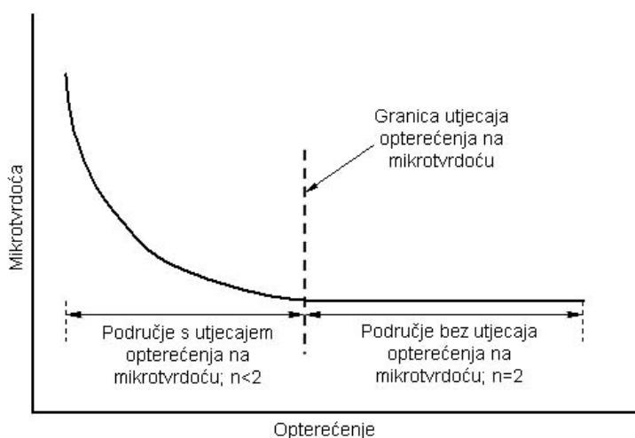
Slika 15. Shematski prikaz utjecaja opterećenja na tvrdoću.
