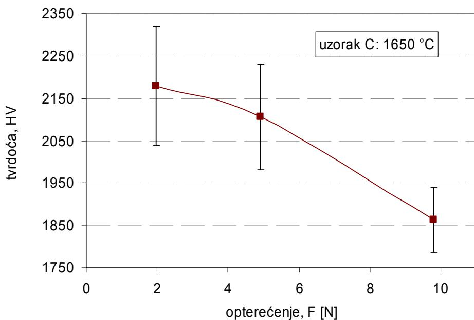
*Slika 23. Vrijednosti mikrotvrdće mjerene Vickersovom metodom u ovisnosti o opterećenju za  $Al_2O_3$  keramiku, uzorak C.*
