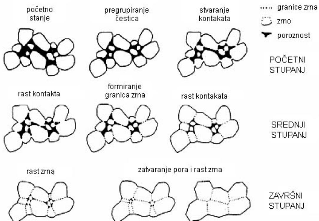
Slika 9. Rast zrna tijekom procesa sinteriranja [2]
