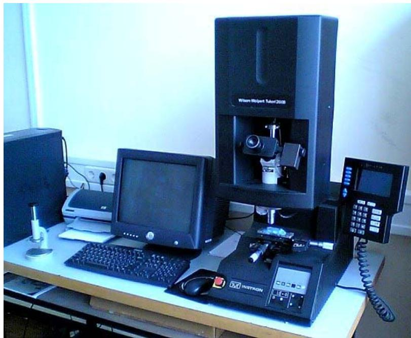
Slika 19. Mirkotvrdomjer Instron, Wilskon-Wolpert Tukon 2100B
