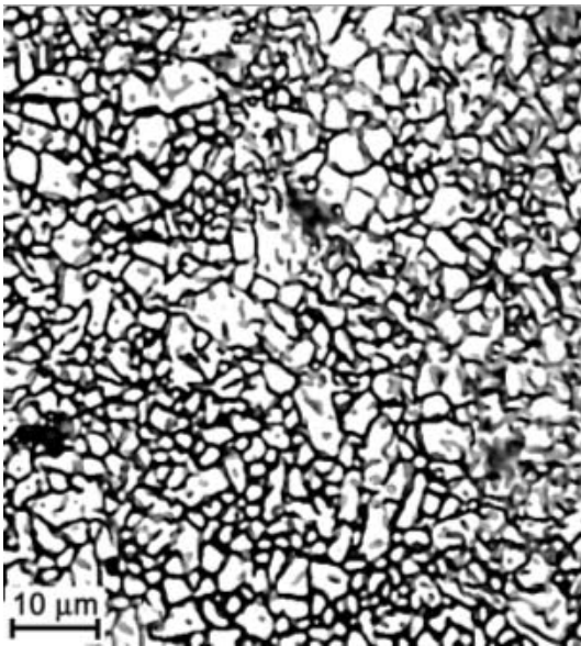
Slika 3. Mikrostruktura sitnozrnate aluminij oksidne keramike [2]
