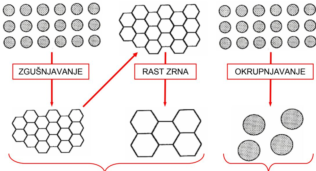
a) ZGUŠNJAVA nakon toga slijedi RAST ZRNA      b) OKRUPNJAVANJEM rastu velika zrna na račun malih.
