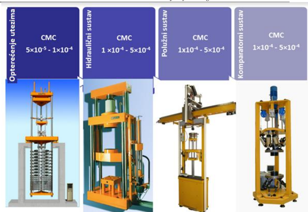
Slika 5. Načini realizacije sile kod referentnih etalona [4]
