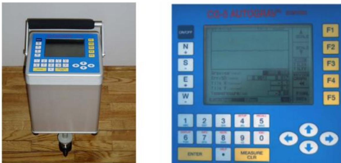
Slika 26. Relativni gravimetar Scintrex CG-5 i njegovo sučelje [9]
