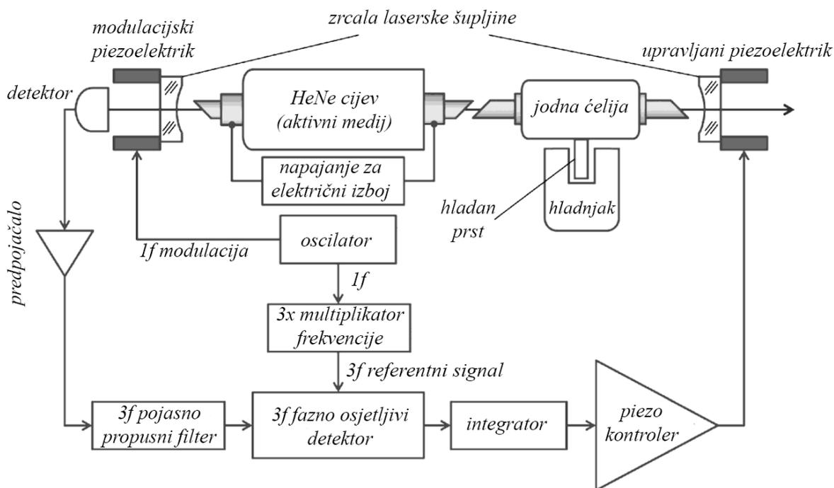
**Slika 54. Shematski prikaz jedne stabilizacije HeNe lasera [17]**
