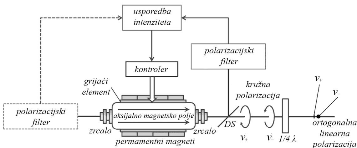
**Slika 44. Shematski prikaz tipične stabilizacije Zeemanovim efektom [17]**
