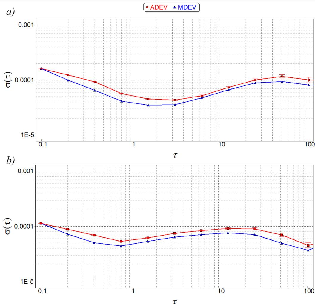
**Slika 78. Stabilnost a) nestabiliziranog i b) stabiliziranog lasera**
