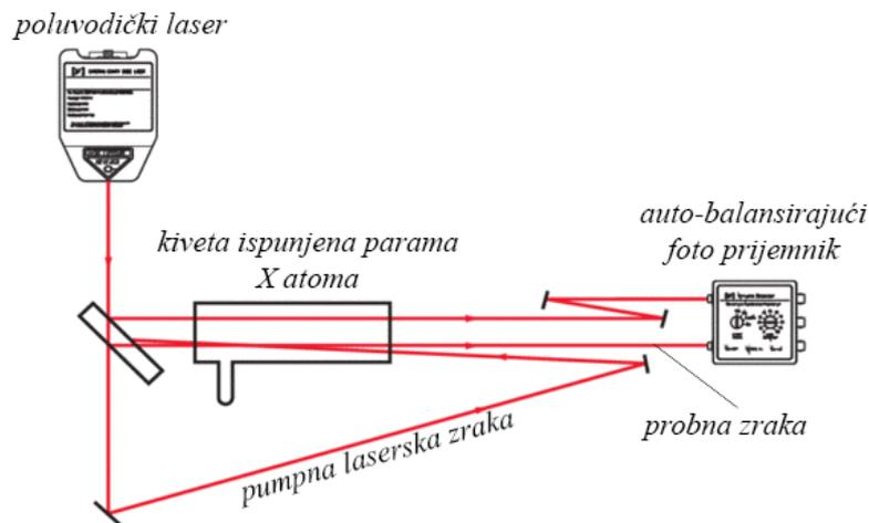
**Slika 51. Shema stabilizacije FM saturacijskom spektroskopijom [19]**
