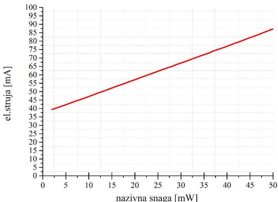
**Slika 68. Ovisnost nazivne snage o električnoj struji**
