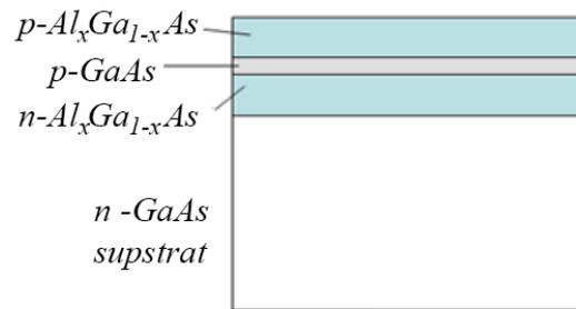
**Slika 25. GaAs Laser s dvostrukim heterospojem [6]**
