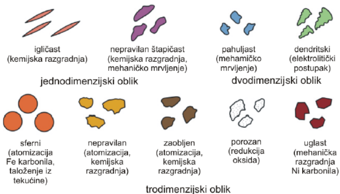
Slika 3. Oblici čestica praha i metode dobivanja [2]
