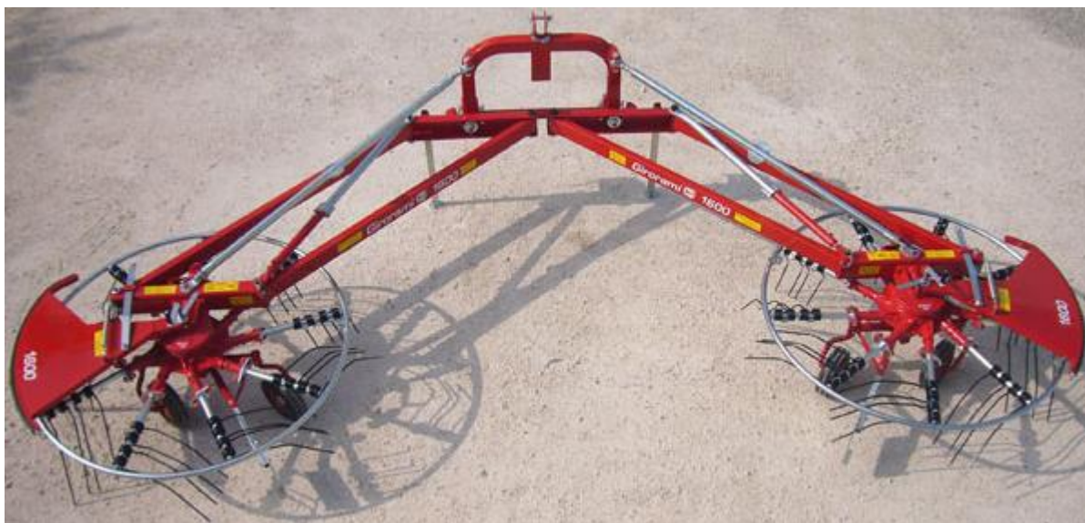
Slika 11. Traktorski priključak GIRORAMI 86 BA 1600D tvrtke F.R.C [6]
