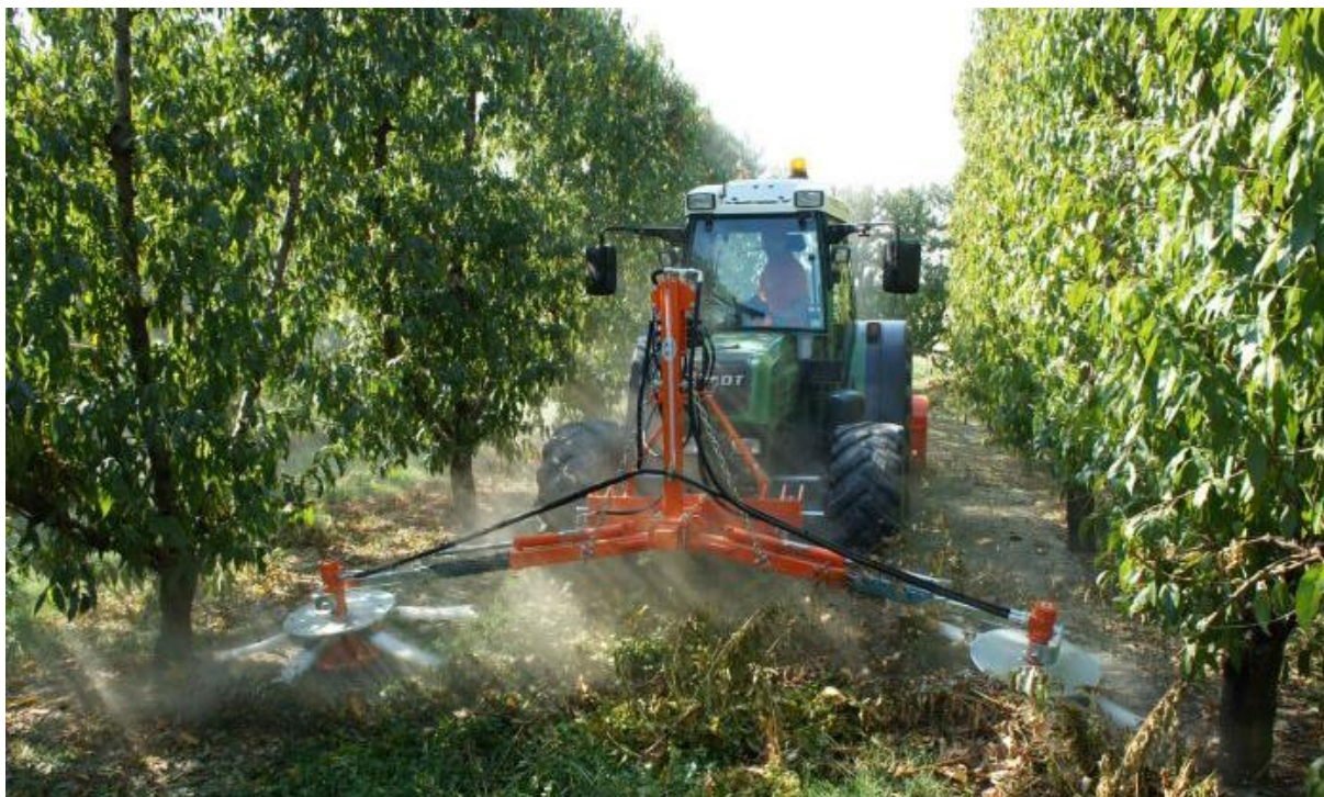
Slika 7. Traktorski priključak za sakupljanje granja RINIERI AN2 [5]
