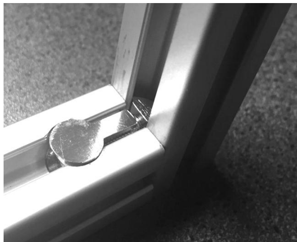
Slika 67. Spoj dva ekstrudirana aluminijska profila
