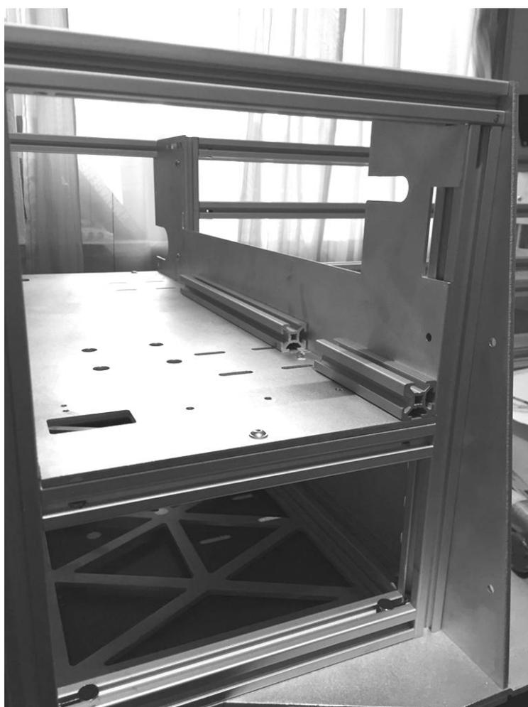
**Slika 85. Ploča za ugradnju vodilice**
