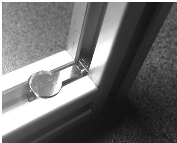
**Slika 67. Spoj dva ekstrudirana aluminijska profila**
