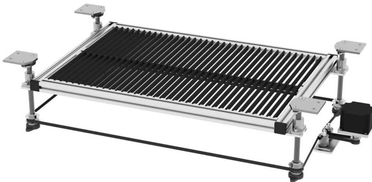
Slika 62. Sklop stola za podizanje obratka
