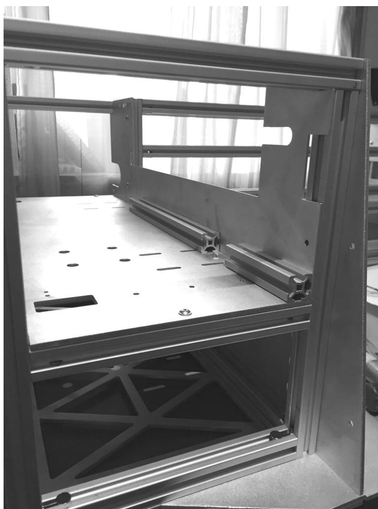
Slika 85. Ploča za ugradnju vodilice
