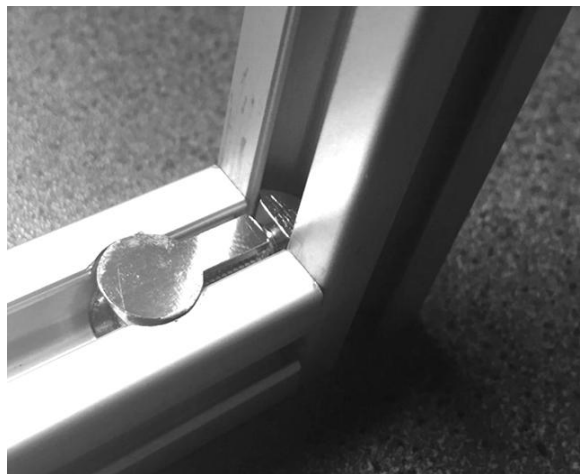
Slika 67. Spoj dva ekstrudirana aluminijska profila
