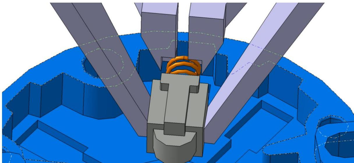
Slika 52. CAD prikaz umetanja ugradbenog sklopa tlačnik-opruga
