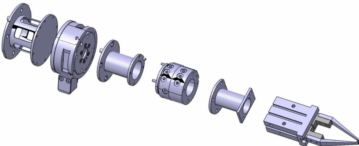
**Slika 14.** Prikaz ugradbenih alata od lijevog zgloba robota do prstiju prihvavnice
