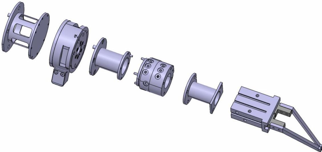
**Slika 13.** Prikaz ugradbenih alata od desnog zgloba robota do prstiju prihvavnice
