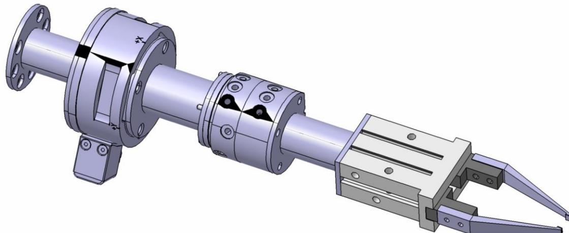
**Slika 22. Prikaz ugradbenih alata CR-35iA robota za rastavljanje tlačnika iz ugradbenog sklopa tlačnik-opruga**
