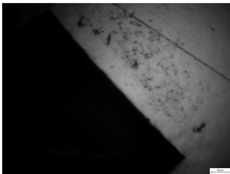
Slika 6.17. Rub otiska na etalonu 33P1825 - 204,4 HV20
