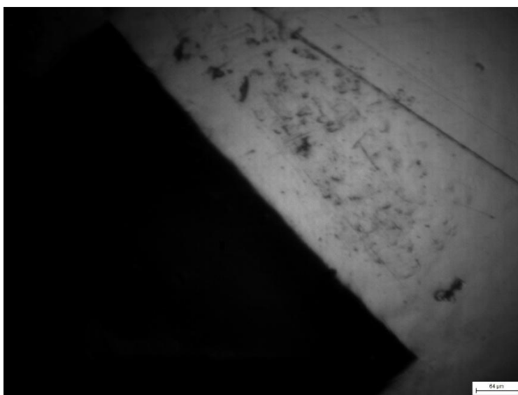
Slika 6.17. Rub otiska na etalonu 33P1825 - 204,4 HV20
