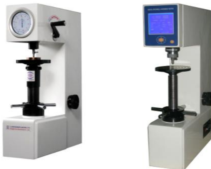
Slika 2.1. Tvrdomjeri; analogni i automatizirani
