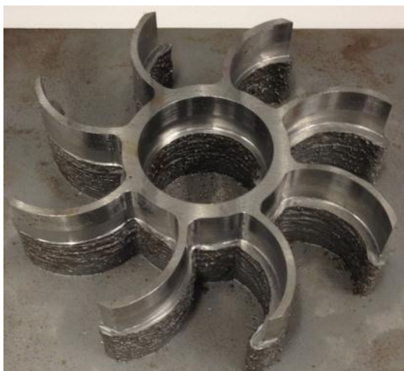
Slika 25. Propeler izrađen WAAM procesom [36]
