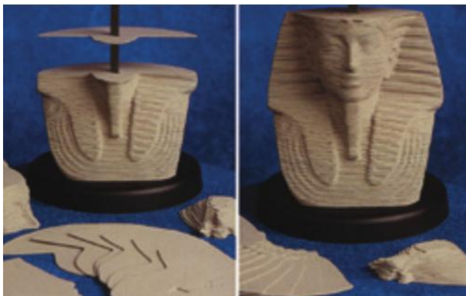
Slika 1. Prikaz slaganja slojeva u aditivnoj proizvodnji [2]
