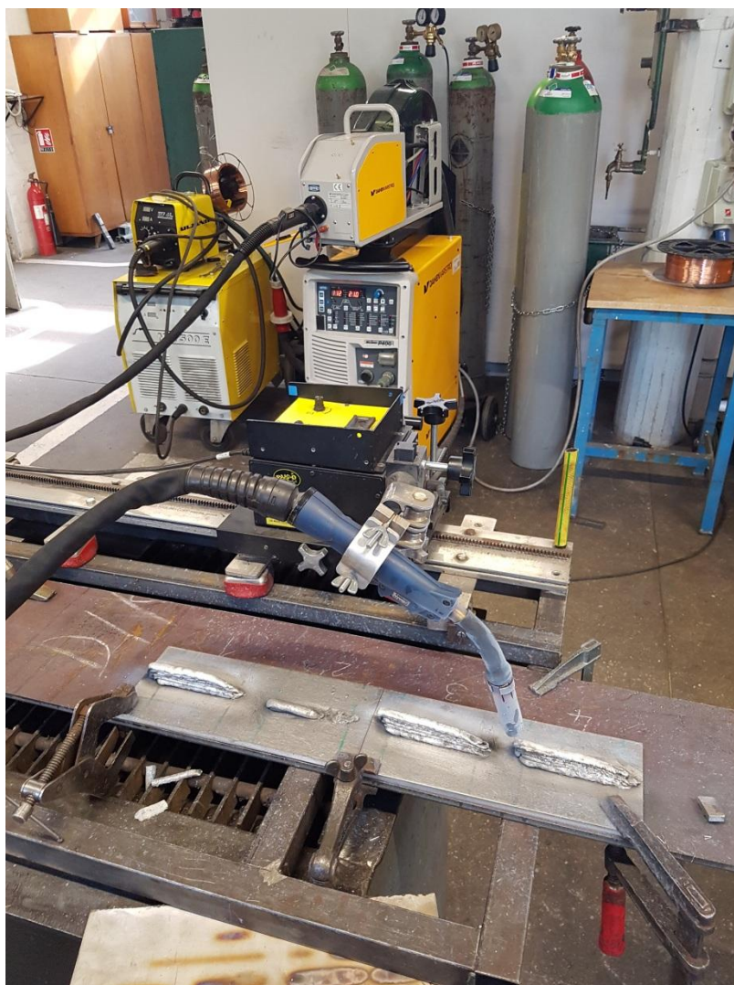
Slika 29. Postav eksperimenta i opreme za WAAM postupak
