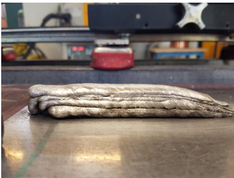
Slika 38. Uzorak broj 1 nakon šest prolaza
