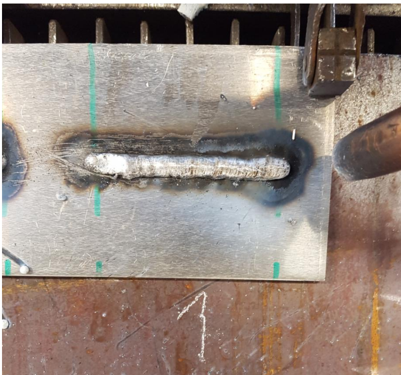
Slika 37. Uzorak broj 1 nakon prvog prolaza
