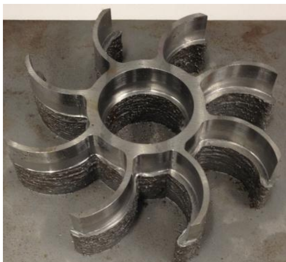
Slika 25. Propeler izrađen WAAM procesom [36]
