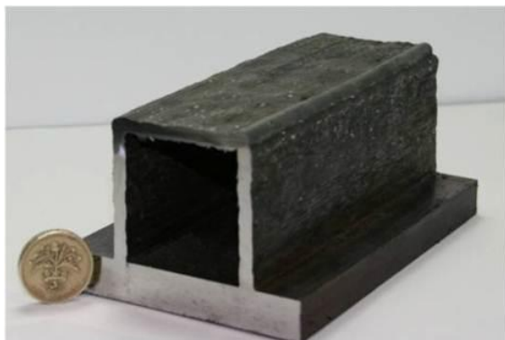
Slika 26. Kvadratna zatvorena konstrukcija izrađena WAAM postupkom [36]
