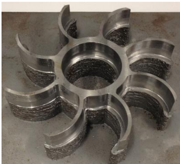
Slika 25. Propeler izrađen WAAM procesom [36]
