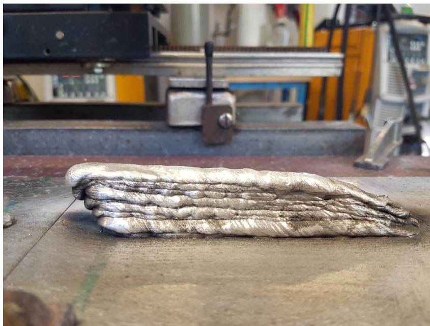
Slika 39. Uzorak broj 2 nakon šest prolaza i četkanja
