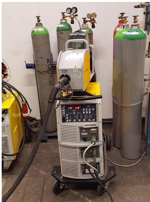
Slika 30. Izvor struje za zavarivanje Welbee P400
