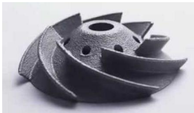
Slika 7. Komponenta napravljena Arcamovim EBM uređajem [10]
