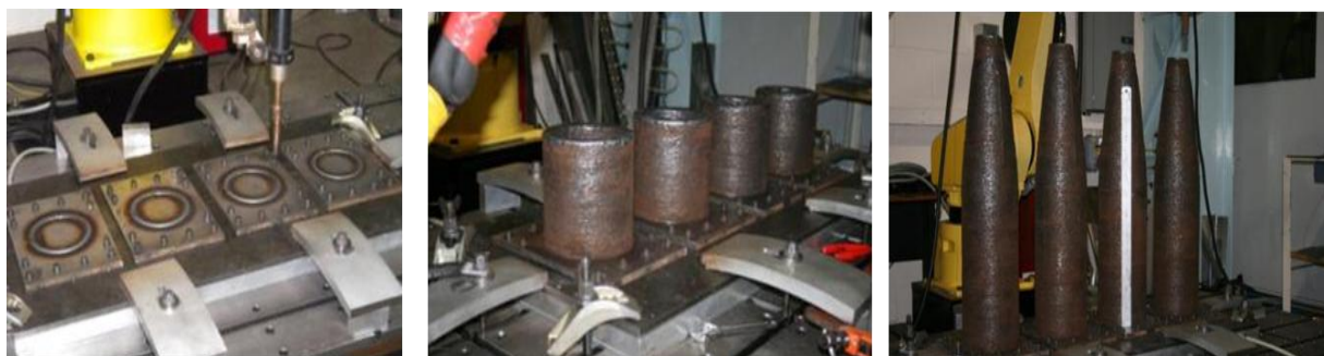
Slika 22. Proces izrade kućišta za rakete [35]
