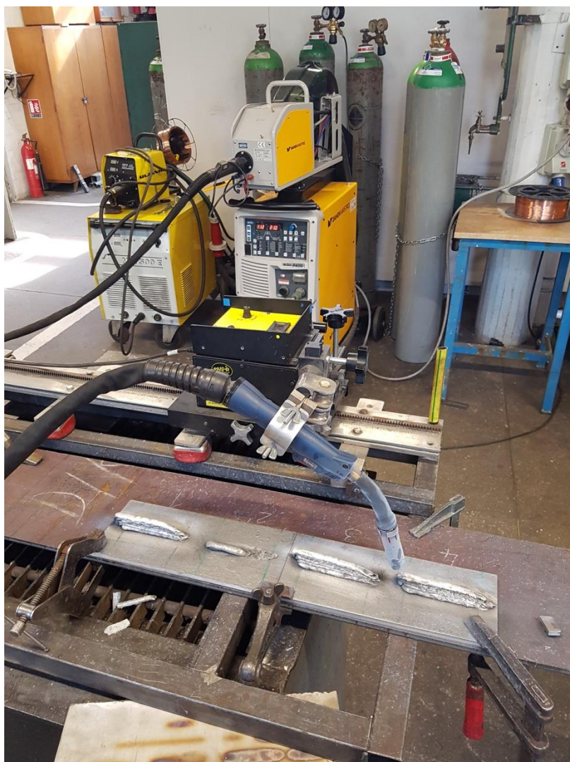
Slika 29. Postav eksperimenta i opreme za WAAM postupak
