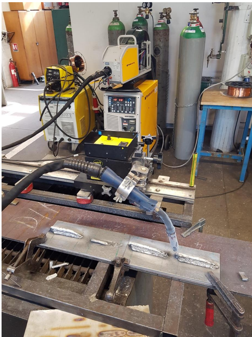
Slika 29. Postav eksperimenta i opreme za WAAM postupak
