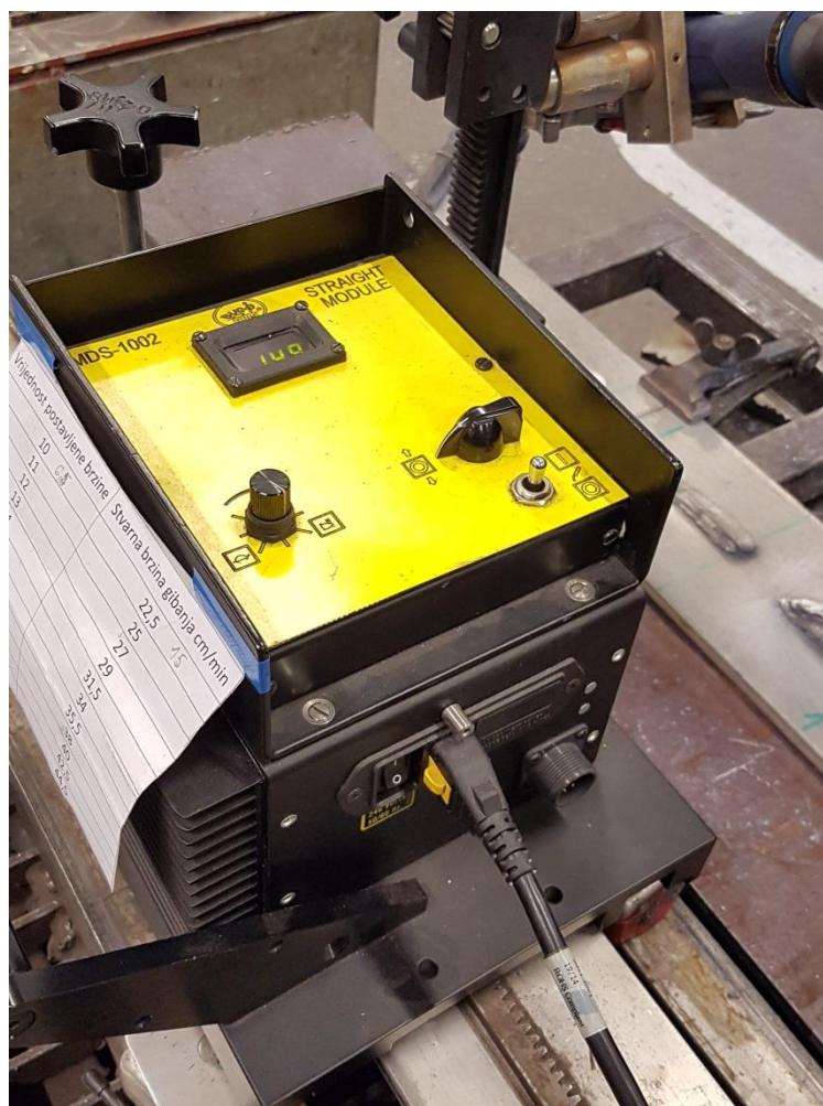
Slika 31. Bug-O Systems MDS - 1002 uređaj
