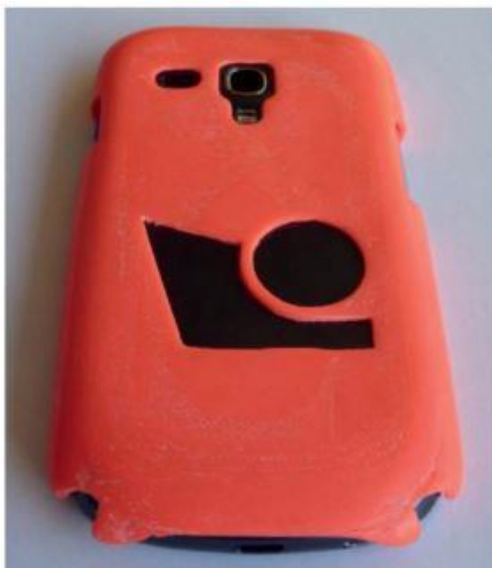
Slika 3.7. Tvorevina nastala postupkom FDM [23]
