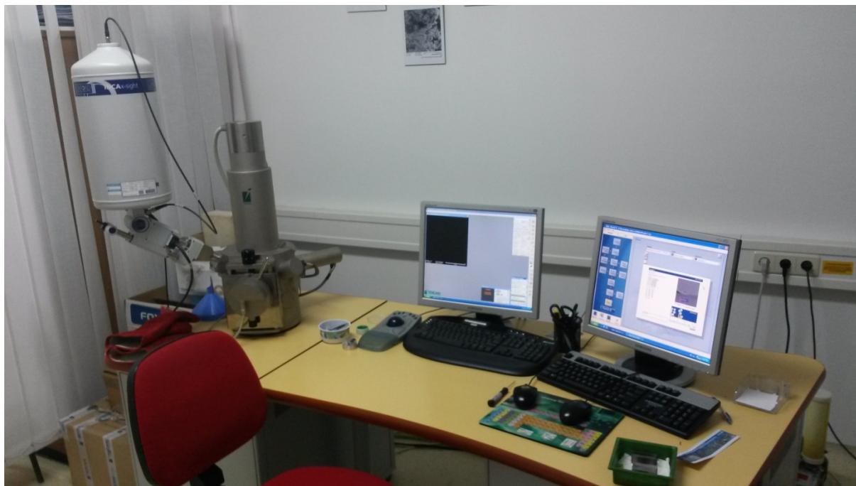
Slika 61. Tescan Vega TS5136 – pretražni elektronski mikroskop (SEM)
