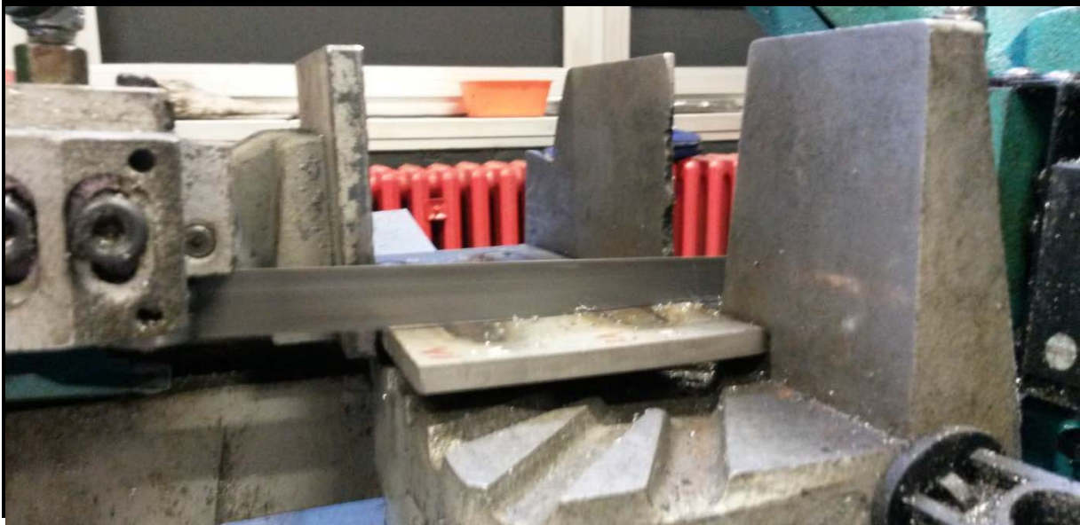
Slika 58. Postupak rezanja uzoraka na tračnoj pili
