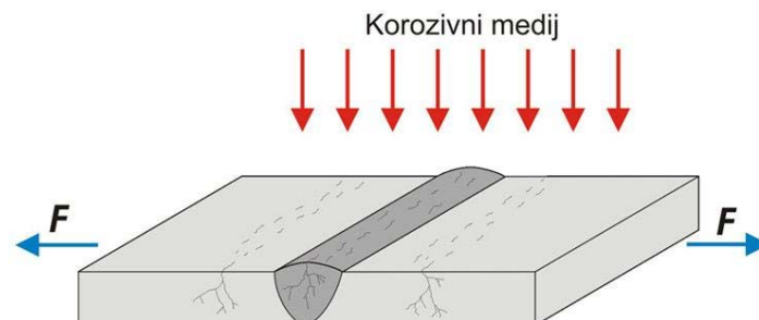
Slika 21. Mehanizam napetosne korozije [16]
