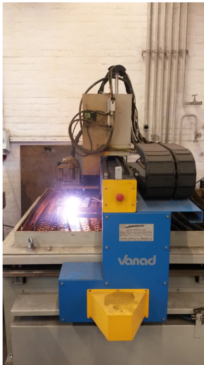
Slika 57. Postupak rezanja uzoraka na plazma rezačici
