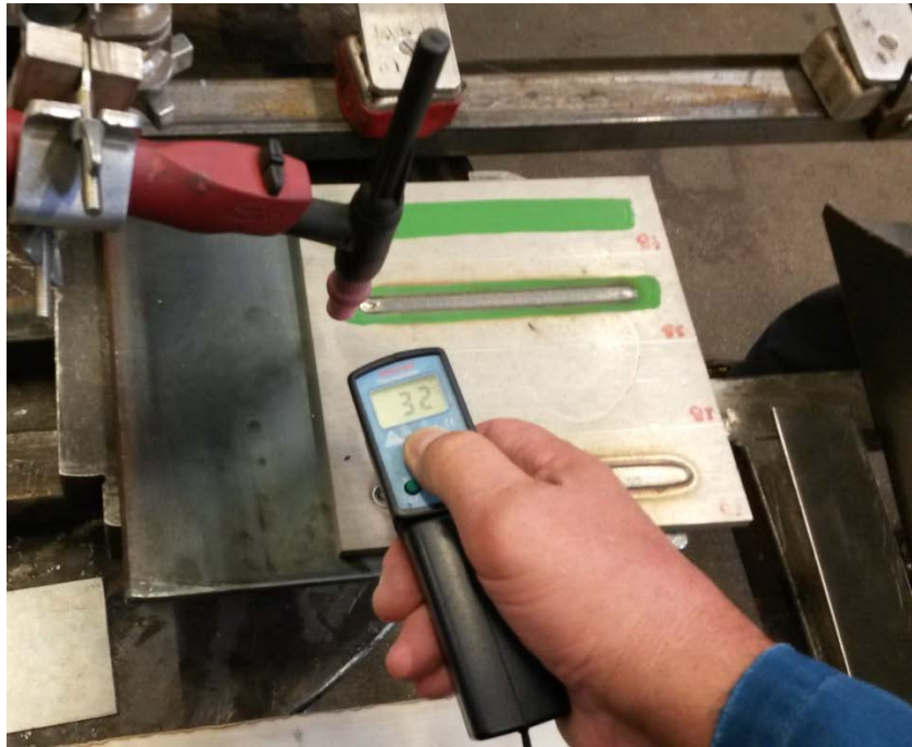
Slika 53. Mjerenje temperature ploče nakon navarivanja
