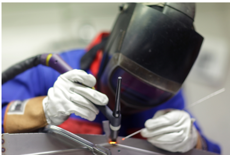
Slika 23. Ručno TIG zavarivanje [19]
