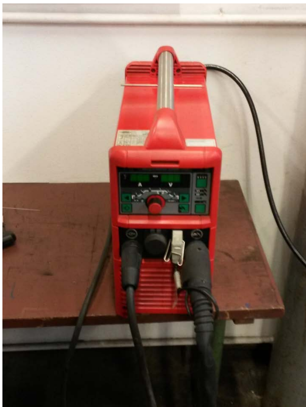
Slika 51. Uređaj za TIG zavarivanje Fronius tipa MagicWave 2200 Job G/F
