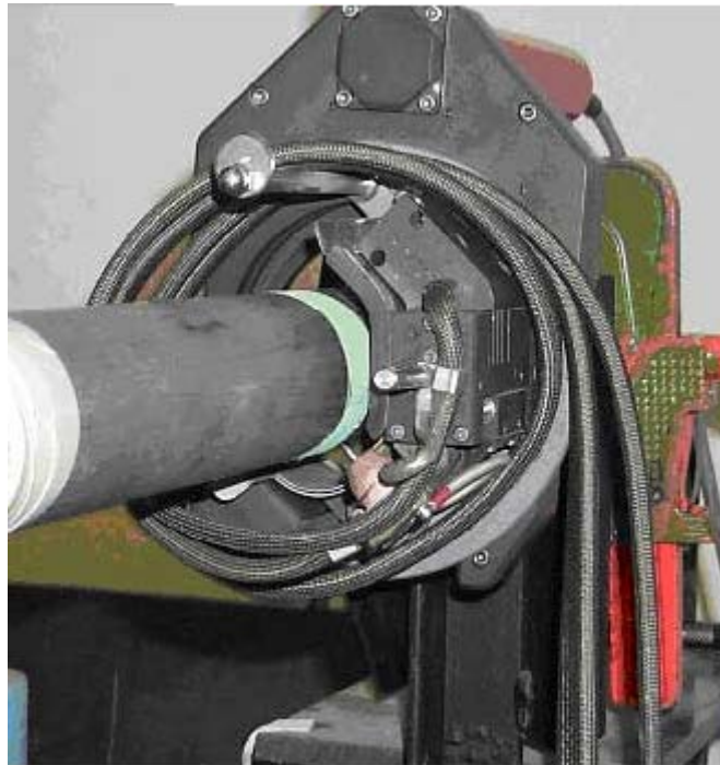
Slika 42. Orbitalno A-TIG zavarivanje cijevi [39]
