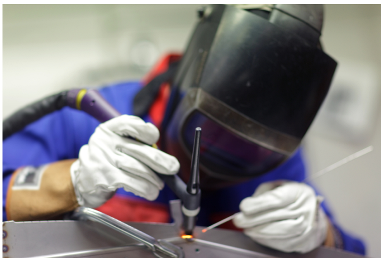
Slika 23. Ručno TIG zavarivanje [19]
