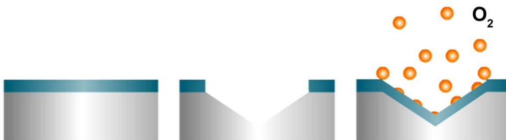
Slika 2. Mehanizam samoobnavljanja pasivnog filma kromovih oksida na površini [2]
